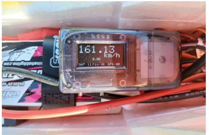
Der Master GPS-Geschwindigkeitstracker zeigt nach dem Flug eine Maximalgeschwindigkeit von 161,13 km/h an. Das Modell Vulcan hält, was die Werbung verspricht!
