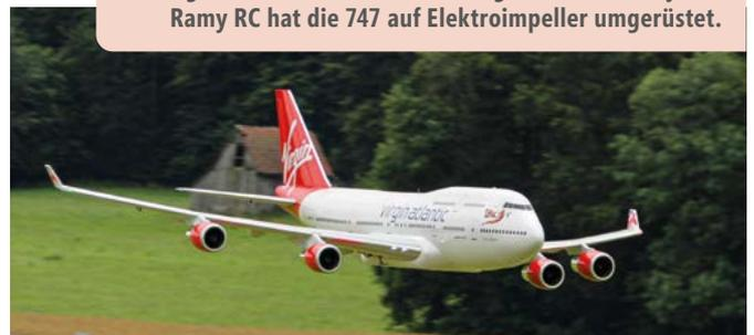
Die beiden zuvor genannten Modelle sind das beste Beispiel dafür, dass Airlinermodelle mit elektrischen Impellerantrieben immer weiter in die Großmodell-Domäne vordringen. Vor einigen Jahren wäre Modelle, wie die C-17, bzw. Boeing 747-400 in dieser Größe und mit diesem Gewicht elektrisch nicht flugfähig gewesen. Wie sich die Zeiten ändern!
