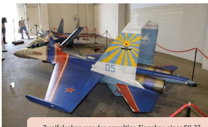
Zweifelsohne war der gewaltige Eigenbau einer SU-27 im Maßstab 1:4,3 mit einer Spannweite von 3.500 mm und einem zulassungspflichtigem Abfluggewicht von 149,2 kg das größte Flugmodell auf der Messe. Angetrieben wird das Modell von zwei Frank FT550 Turbinen.
