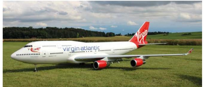
Die Boeing 747-400 ist kein Unbekannter beim Airlinermeeting. Schließlich stammt sie von Adi Pitz, der sie vor einigen Jahren mit vier Turbinen gebaut hat. Ramy von Ramy RC hat die 747 auf Elektroimpeller umgerüstet.
