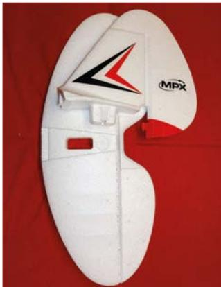
Seiten- und Höhenleitwerk werden einfach ineinander gesteckt, am Rumpfrücken ausgerichtet und mit Hilfe einer M5-Schraube befestigt.
