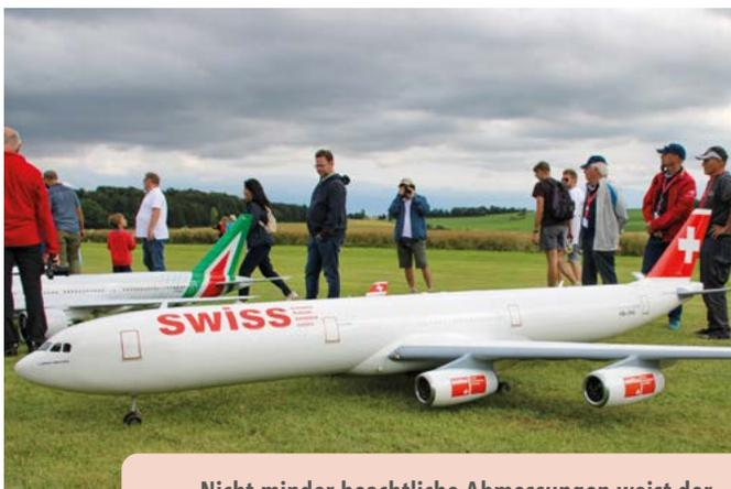
Nicht minder beachtliche Abmessungen weist der Airbus A340-300 in der Swiss-Lackierung auf. Der Eigentümer und Pilot ist Heinrich Lothar, er präsentierte das Modell nicht nur am Boden beim Lineup, sondern auch im Flug. Mit ihren 4.300 mm Spannweite und einem Abfluggewicht von 63 kg gehörte sie zu den Schwergewichten des Airlinermeetings.
