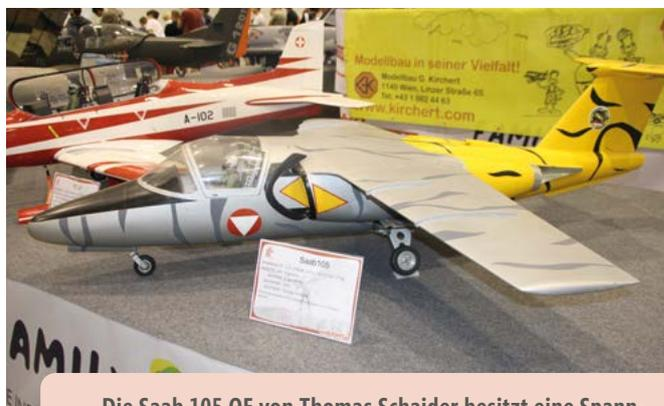
Die Saab 105 OE von Thomas Schaidler besitzt eine Spannweite von 2.000 mm und wird von zwei Jetcraft 90 Turbinen angetrieben. Der Jet ist ein Eigenbaumodell, das aus GFK erstellt ist, das Abfluggewicht beträgt 17.000 Gramm.
