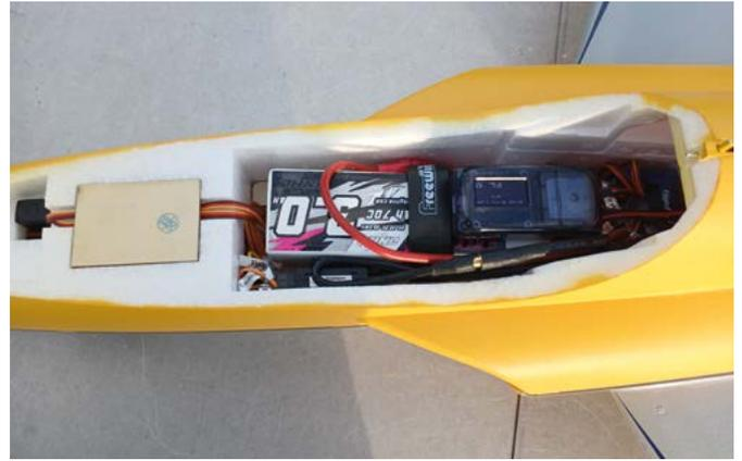
Unter der Cockpithaube ist im Rumpf ausreichend Platz für den Empfänger, Flugakku und dem GPS-Geschwindigkeitstracker.
