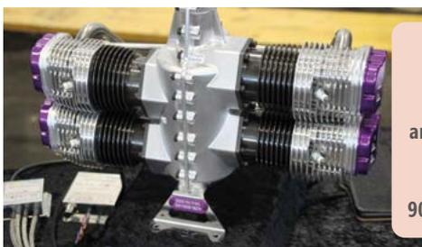
Am Stand des Motorenhersteller PACE war unter anderem einen sechs Zylinder Viertakt Boxermotor mit 900 ccm<sup>3</sup> ausgestellt.
