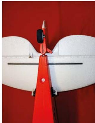
Das Spornrad wird in den dafür vorgesehenen Schlitz eingeschoben. Um mehr Klemmkraft zu erreichen kann der Drahtbügel etwas auseinandergebogen werden.
