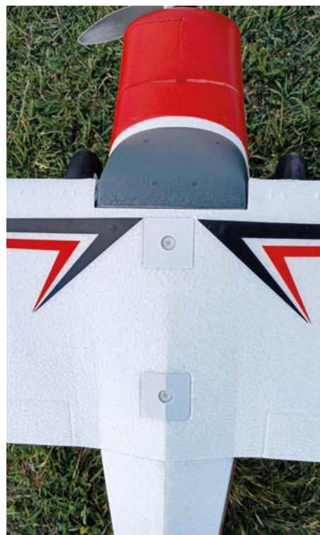
Die Tragfläche wird am Rumpfrücken durch zwei Kunststoff-Schrauben M5 fixiert. Durch die geringe Spannweite von 1.150 mm kann das Modell Pacer in jedem Fahrzeug zum Fluglande transportiert werden.
