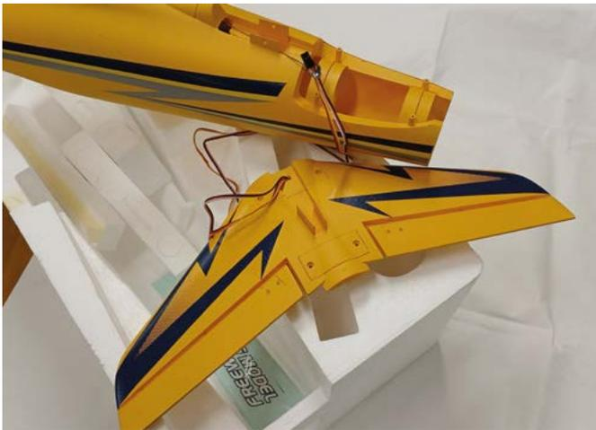
Vor der Montage des Seiten- und Höhenleitwerks in die dafür vorgesehenen Nuten, müssen noch die zugehörigen Servokabelverlängerungen eingezogen und mit den Kabeln des Höhen- und Seitenruder-Servos verbunden werden.
