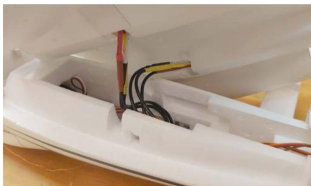
Bevor das obere rückwärtige Rumpfteil, das auch die Motor gondeln beinhaltet, aufgesetzt wird, müssen noch die Motoranschlusskabel verbunden werden. Die Zuordnung der Kabel erfolgt über die Farbgebung des Schrumpfschlauches. In der Bauanleitung ist genau beschrieben, welche Kabelpaare zusammengehören.
