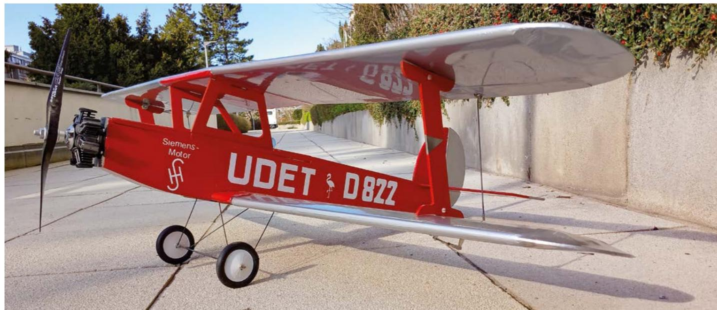
Zum 100-jährigen Jubiläum der Firma Aeronaut erfolgte eine komplette Neukonstruktion der Flamingo Udet. Dabei wird das Modell nun komplett aus Laserteilen aufgebaut und als Antrieb kommt nun anstelle des Verbrenners- ein 35 mm-Elektromotor zum Einsatz. Im Cockpit fehlt noch eine Pilotenfigur, jedoch ist es gar nicht so einfach, eine passende zu finden – die Suche nach einem prädestinierten Piloten geht weiter!
