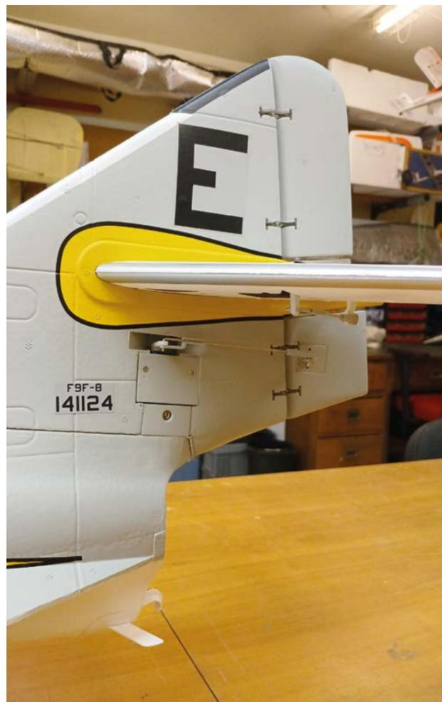
Das Leitwerk ist in T-Form ausgeführt, wobei das Seiten- und Höhenruder funktionell durch neun Gramm Hybridservos angesteuert werden.
