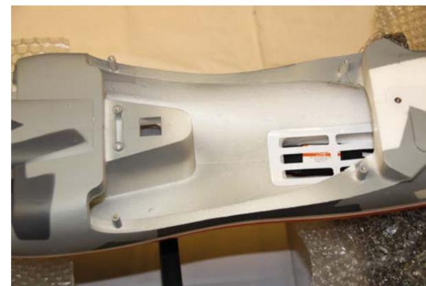
• Der 85 A-Flugregler liegt in einem Fach im Rumpf und wird durch den Luftstrom des Impellers gut belüftet.
