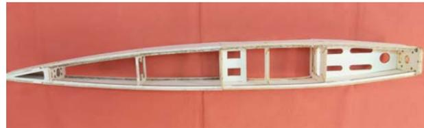
Der fertige Rohbau des Rumpfes – der Aufbau geht sehr schnell von der Hand. Dafür wird keine Planaufgabe am Baubrett benötigt.
