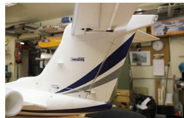
Die aus Seiten- und Höhenleitwerk bestehende Einheit wird mit dem Rumpf verschraubt. Zur Erhöhung der Stabilität des Leitwerks besitzt dieses eine Kunststoff-Schiene, die in das Gegenstück am Rumpf eingeschoben wird.
