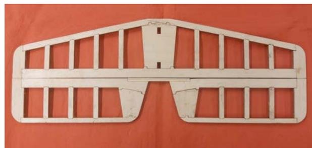
Das Höhenleitwerk wird in Stäbchenbauweise hergestellt und ist dadurch besonders leicht. Dies ist bei der Udet Flamingo für die Einhaltung des Schwerpunkts besonders wichtig, denn das Heck darf nicht zu schwer werden.
