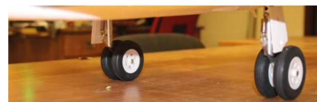
Das Hauptfahrwerk ist geschleppt und besitzt eine Federung gegen die Stöße beim Rollen. Des Weiteren ist es elektrisch ein- und ausfahrbar und wird über die zentrale Verteilplatine angesteuert.
