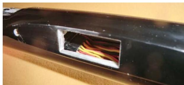
••• Aufgrund der beengten Platzverhältnisse im Rumpf, wurde der Empfänger seinem Gehäuse beraubt und durch einen Schrumpfschlauch ersetzt.
