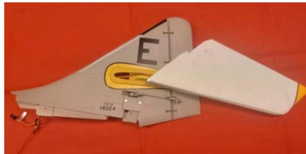
Vor der Fixierung der Höhenleitwerkshälften müssen die beiden Servokabel mit Hilfe eines Stahldrahts mit einer Öse durch das Leitwerk geschoben werden.
