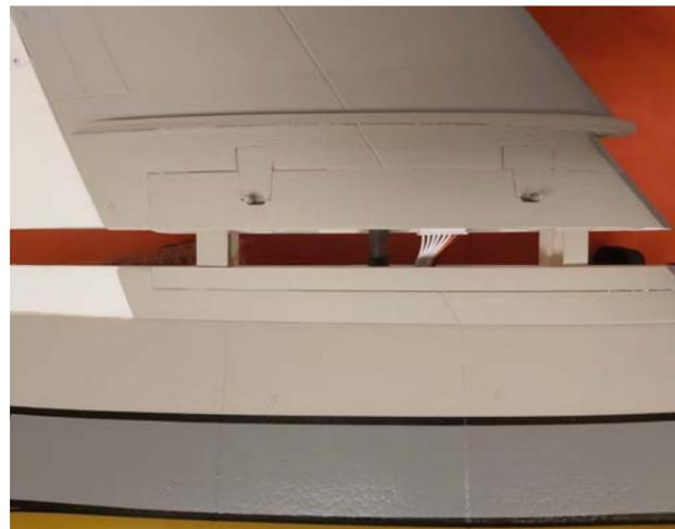
Die Verbindung der Tragflächenhälfte mit dem Rumpf ist sehr clever durch Schnappverschlüsse gelöst, somit fallen hier keine Schraubarbeiten an.
