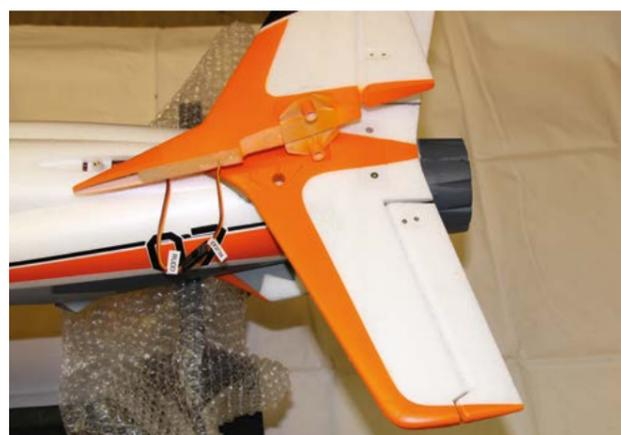
• Die Befestigung des Seiten- Höhenleitwerk erfolgt mit Hilfe M 3x16 mm Schrauben. Im Falle eines Schadens kann man schnell einzelne Komponenten austauschen.
