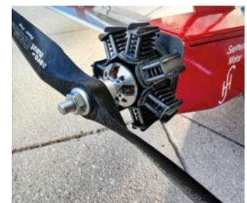
Der Zusammenbau der Motorattrappe kann bereits, als eigener Bausatz bezeichnet werden. Der Antriebsmotor actro-n 35-4-1100 fügt sich sehr gut in die Attrappe ein und besitzt in dieser ausreichend Platz, um sich frei drehen zu können.
