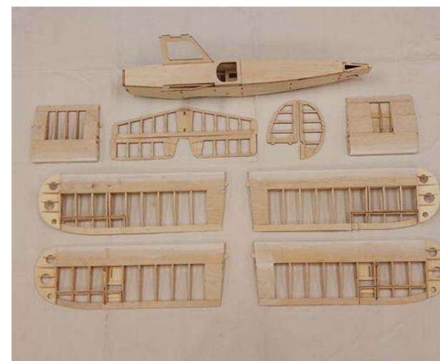
Der fertige Rohbau der Flamingo Udet vor dem Bebugeln mit Folie. An manchen Stellen erfolgte das Ausgleichen mit Spachtelmasse und Verschleifen, um einen nahtlosen Übergang zu erreichen.
