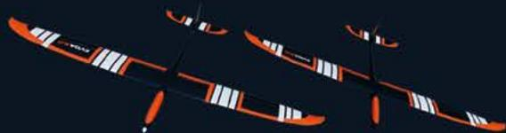
Er hat eine sehr kompakte und transportfreundliche Größe mit seinen 3,0m Spannweite und der zweiteiligen Tragfläche, die seitlich an den Rumpf gesteckt wird. Die Krafteinleitung erfolgt über einen groß dimensionierten CfK Holmverbinder.
