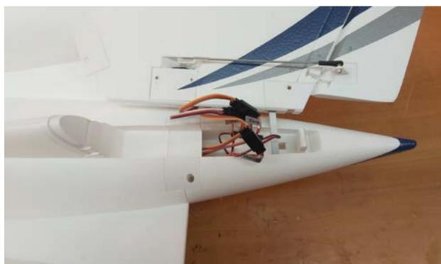
Zur Erhöhung der Stabilität des Leitwerks besitzt dieses eine Kunststoff-Schiene. Sie wird in das Gegenstück am Rumpf eingeschoben. Somit ist der korrekte Sitz des Leitwerks sichergestellt. Die Fixierung am Rumpf erfolgt mit 3 x 10 mm Schrauben.
