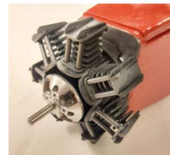
Die fertiggestellte Motorattrappe samt Antriebsmotor nach dem Anpassen der Unterlegscheiben. Dabei ist auf einen störungsfreien Lauf des Motors ohne Schleifen des Rotors an der Attrappe zu achten.
