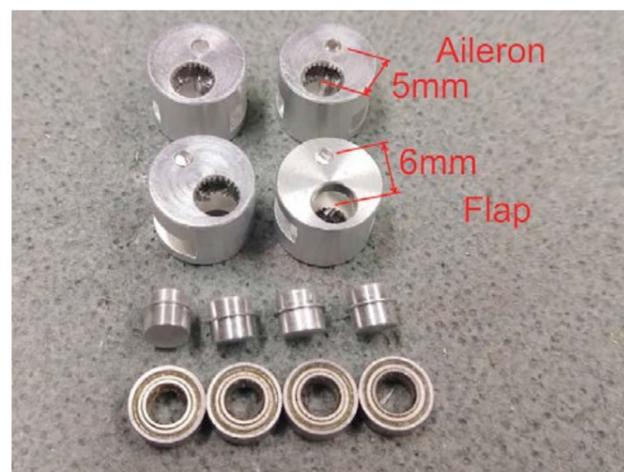
••• Die Anlenkung der Ruder erfolgt mittels Roll-Drive System des Herstellers RTG-Modellbau. Es ist im Bausatz enthalten und der Einbau ist eine kleine Herausforderung.
