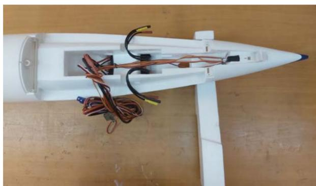
Nachdem Zusammenfügen der beiden Rumpfhälften ragen aus dem Heck eine Vielzahl von Kabeln, die anschließend sortiert und zugeordnet werden müssen. Der linke Kabelbaum wandert in den vorderen Rumpfbereich, wo die einzelnen Kabel in der Zentralplatine eingesteckt werden. Die Kabel auf der rechten Seite dienen der Ansteuerung des Seiten-Höhenruders und Beleuchtung.
