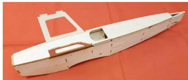
Der fertige Rumpf mit den beiden Baldachinstreben, Rumpfschließens und oberer-unterer Beplankung ist bereit zum Bebugeln.
