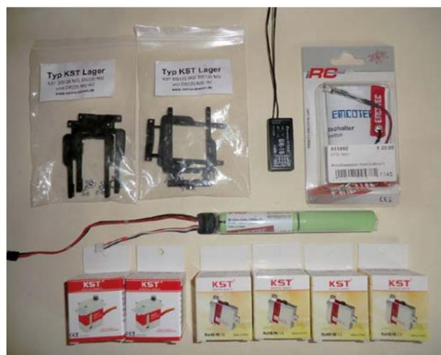
••• Zur Fertigstellung des Orden+ sind neben dem Empfänger sechs Stück Servos (vier KST X10, zwei KST X12-508), der Empfänger-Akku 2s, LiLo mit 2.600 mAh sowie ein Magnetschalter der Marke Zepsus erforderlich.
