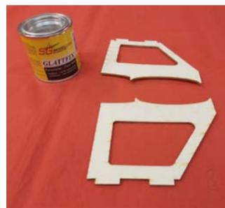
Die beiden Baldachinstreben wurden vor dem Lackieren mit Porenfüller von SG-Modellbau behandelt. Nach dem anschließenden Schleifen mit Körnung 600 und nochmaliger Behandlung mit Porenfüller und Schleifen, konnte die rote Lackierung erfolgen.
