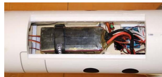
Unter dem abnehmbaren Rumpfdeckel ist viel Platz für die Technik. Der Flugakku und der Empfänger können hier sehr leicht untergebracht werden.
