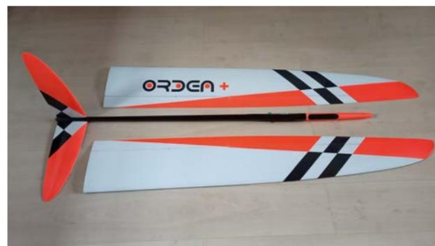
••• Geliefert wird der Orden+ in der ARF-Bauweise. Einzubauen sind die Servos, Empfangsakkus, die Anlenkungen der Ruder und Empfänger.
