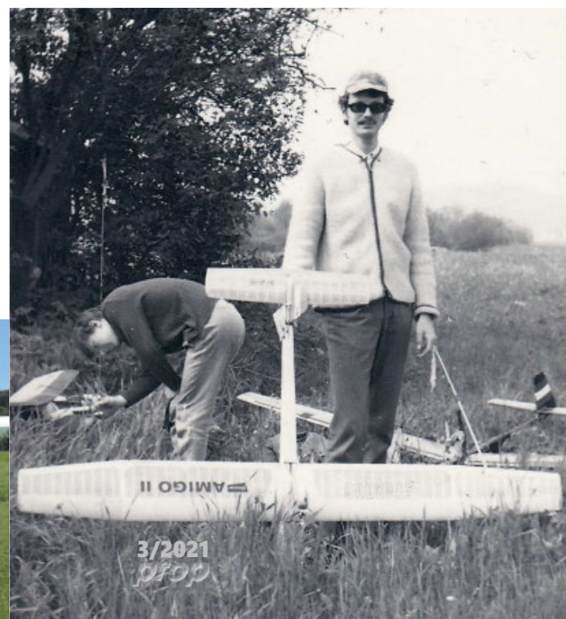
Heimo Stadlbauer 1971 mit dem damals neuen Amigo II, angetrieben von einem COX Tee Dee 051.
