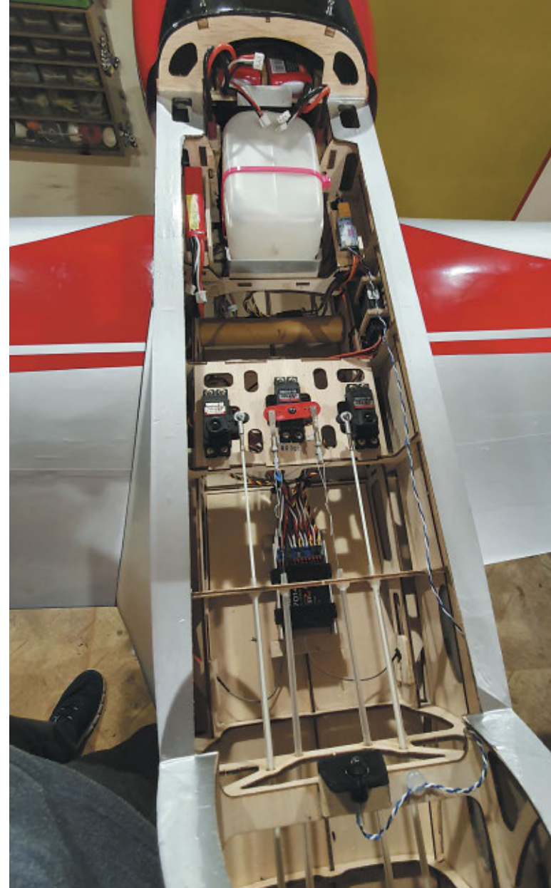
So präsentiert sich der Rumpf nach Abnahme der Kabinenhaube. Da kann man mit beiden Händen sehr gut zu den Komponenten gelangen.
