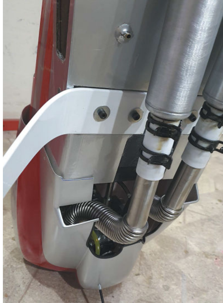
Befestigung des zweiteiligen Hauptfahrwerks mit Stahlschrauben. Schön zu sehen sind auch die beiden Schalldämpfer samt PEFA- Dämpfer.
