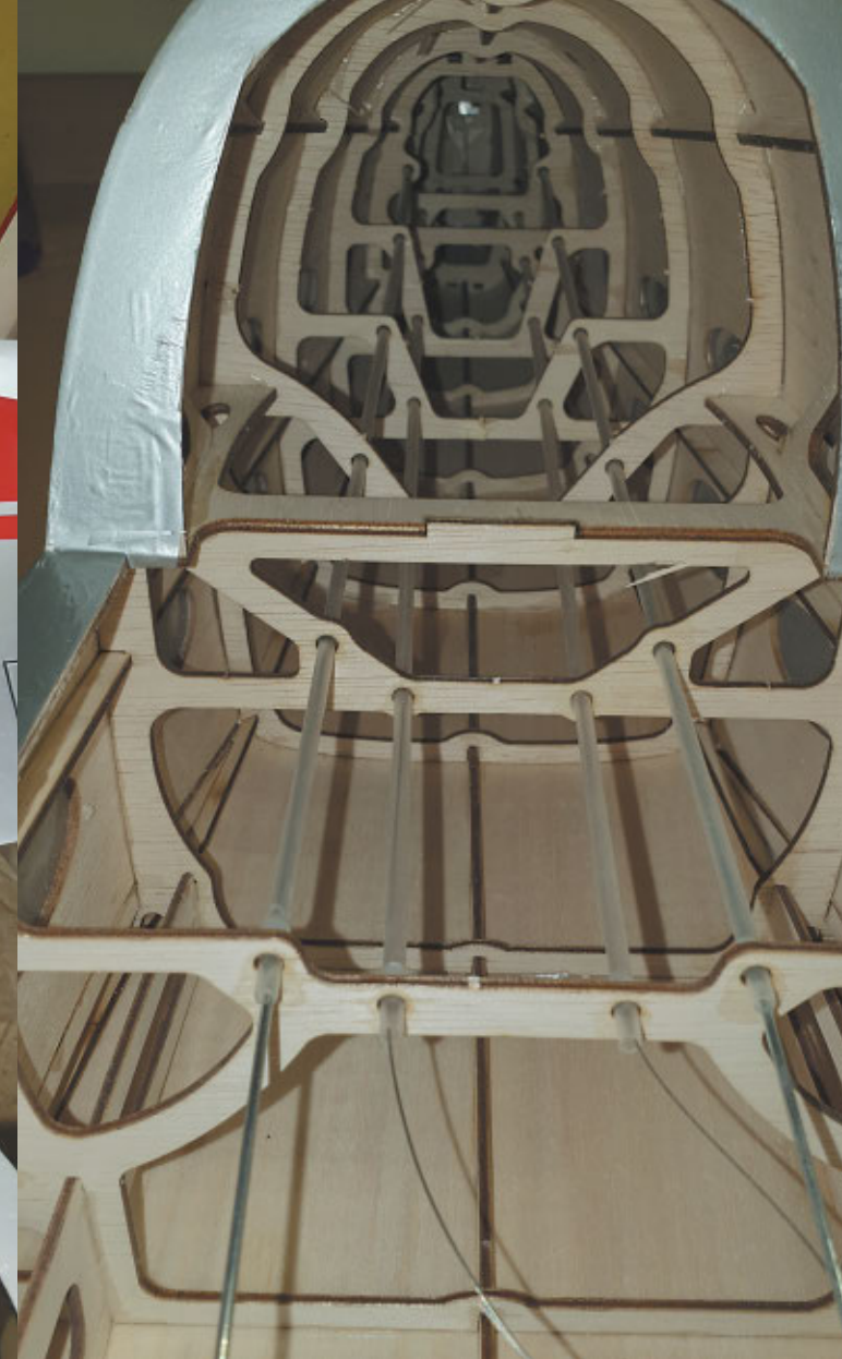
Der Rumpf ist in einer fragilen, aber doch stabilen Gitterstegkonstruktion aufgebaut.
