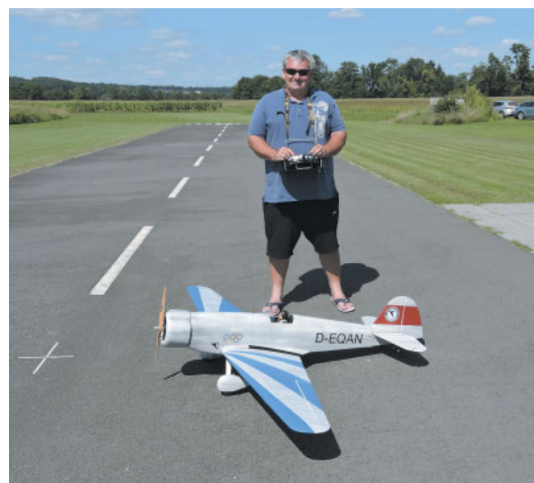
Messerschmitt M 35 von Christoph Stradner, Nachbau eines Originals aus 1933, Spannweite. 2.200 mm, Gewicht 4500 g, LiPo 6 s.
