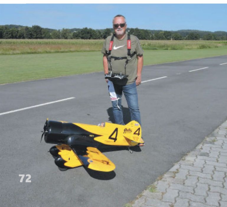
Originalnachbau des Rennflugzeuges „Gee Bee“ aus den Dreißigerjahren, pilotiert von Erwin Wurm, Spannweite. 1.700 mm, Gewicht 5000 g, LiPo 8 s.
