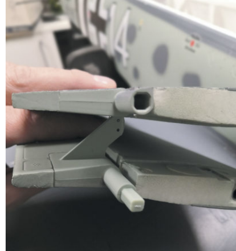
Das Höhenleitwerk ist mit einer Kohlesteckung ausgestattet und das nicht angelenkte Ruder wird über einen Vierkant mitgenommen.
