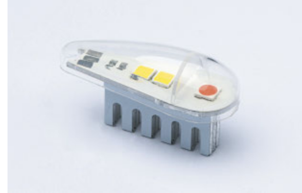
COB-Emitter zeigt einem typischen 10W Emitter, diese Einheit ist so NICHT betriebsfähig.
