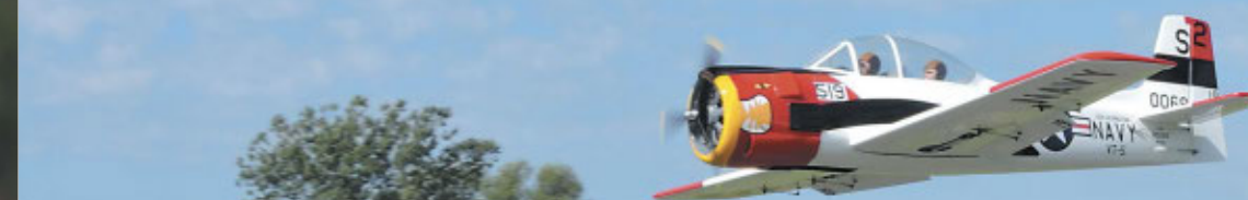
North American „Trojan T 28“, ein ehemals klassisches Trainingsflugzeug in den USA, von Volker Schreiegg, Spannweite 2.050 mm, Gewicht 6.000 g, LiPo 8 s.
