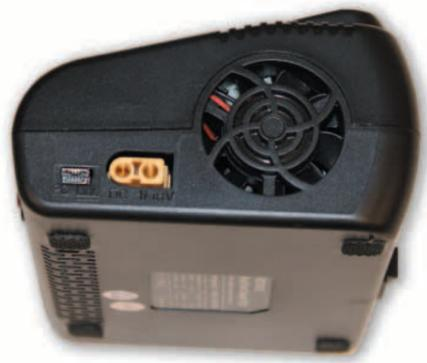
An der rechten Gehäusewand befinden sich der Anschluss für den 12 Volt und USB-Eingang. Rechts davon hat der Lüfter seinen Arbeitsplatz, er sorgt für ausreichend Kühlung während des Ladevorgangs.
