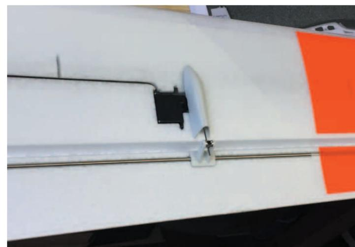
Die Querruder sind durch Edelstahlrohre verstärkt und daher im Betrieb torsionsfrei. Dadurch wird eine präzise Steuerung des Modells um die Querachse erzielt.
