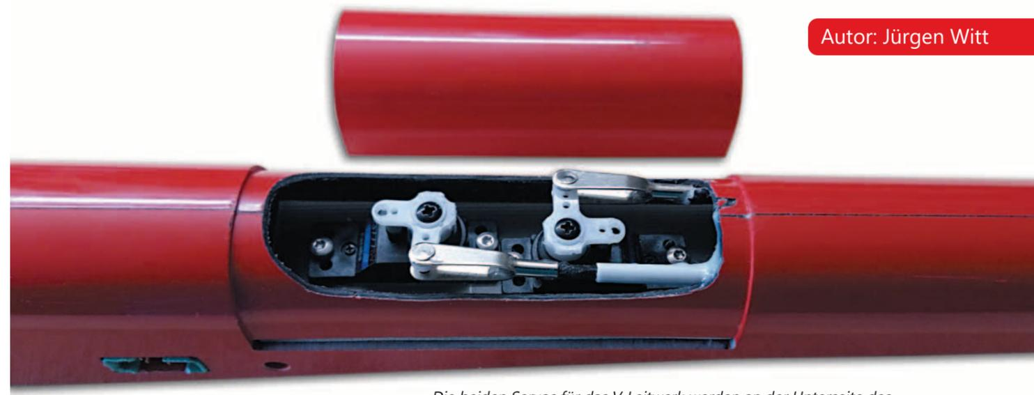
Die beiden Servos für das V-Leitwerk werden an der Unterseite des Rumpfes und hinter der Wurzelanformung für die Tragflächen eingebaut.
