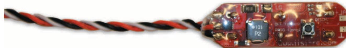
Das elektronische Gehirn der Safety Caps befindet sich auf der Stirnseite, über dieses läuft das Lade/Entlademanagement. Hier befindet sich auch der Taster und die drei LEDs für die Programmierung.
