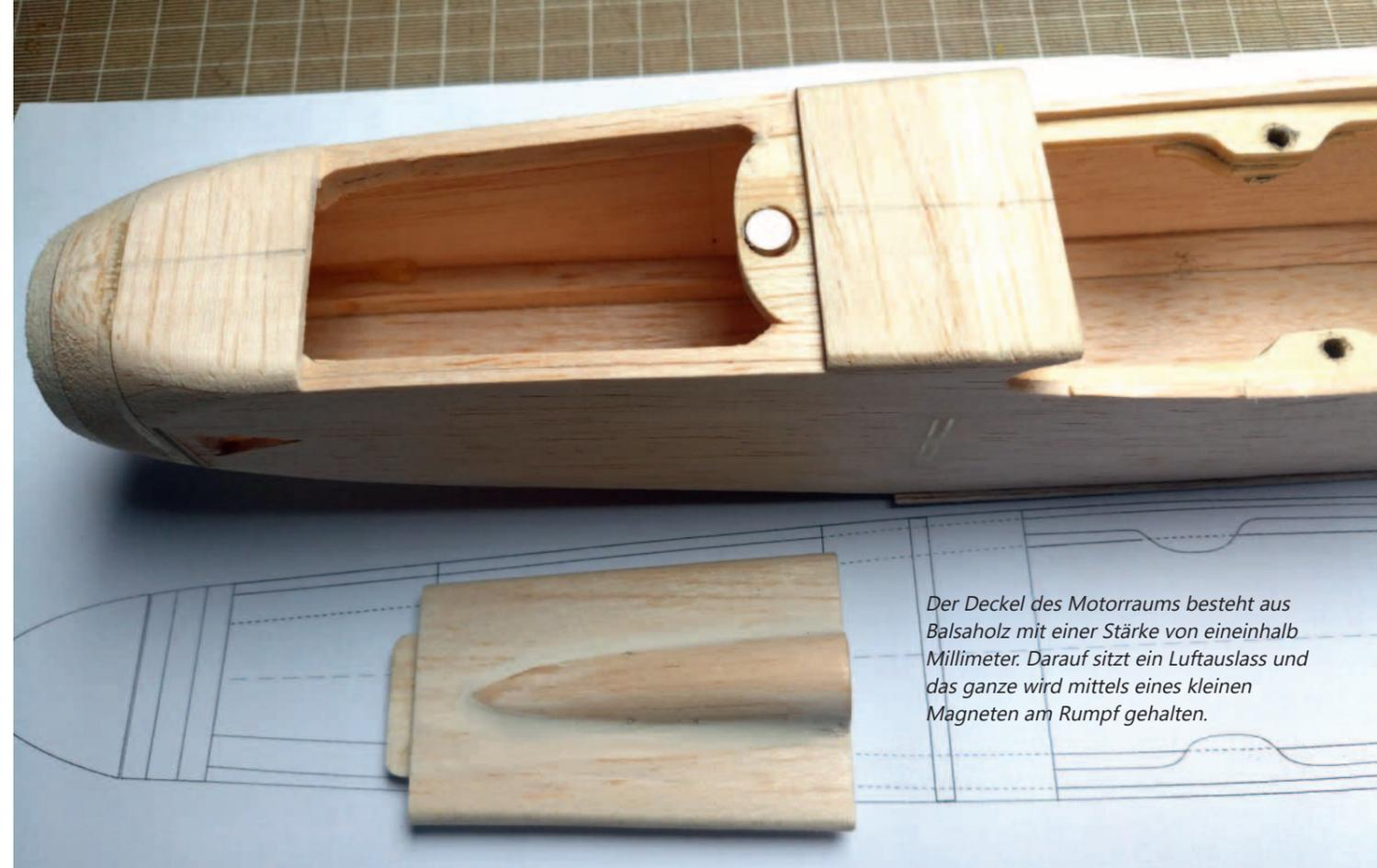
Der Deckel des Motorraums besteht aus Balsaholz mit einer Stärke von eineinhalb Millimeter. Darauf sitzt ein Luftauslass und das ganze wird mittels eines kleinen Magneten am Rumpf gehalten.
