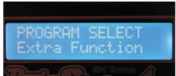
Das Menü Extrafunktionen kann man die einzelnen Spannungen, den Innenwiderstand jeder Zelle oder die Kapazität für jede Zelle separat abrufen. Diese Funktion ist recht nützlich, um den Zustand des Akkus festzustellen.
