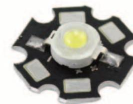
Die kalte, weiße Farbe der ersten weißen LEDs entstand erst 30 Jahre nach der ersten Leuchtdiode. Und in den meisten Fällen ist keine weiße, sondern eine blaue Diode mit einer gelblichen Lumineszenzschicht enthalten, ähnlich einer Energiesparlampe um das Lichtspektrum in den gewünschten Bereich zu verschieben. Weiss aus den Komponenten RGB zu erzeugen ist wesentlich aufwändiger.
