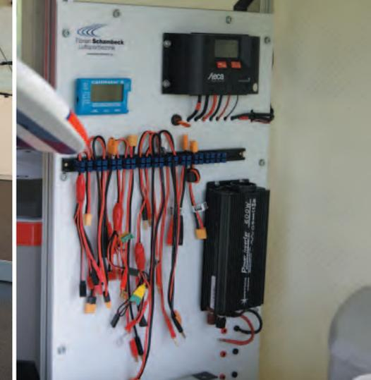
Auf der senkrechten Schalttafel befinden sich mehrere Anschlüsse für „Bananenstecker“. Auch der Solarregler und auch der zugehörige Wandler ist hier fix montiert.
