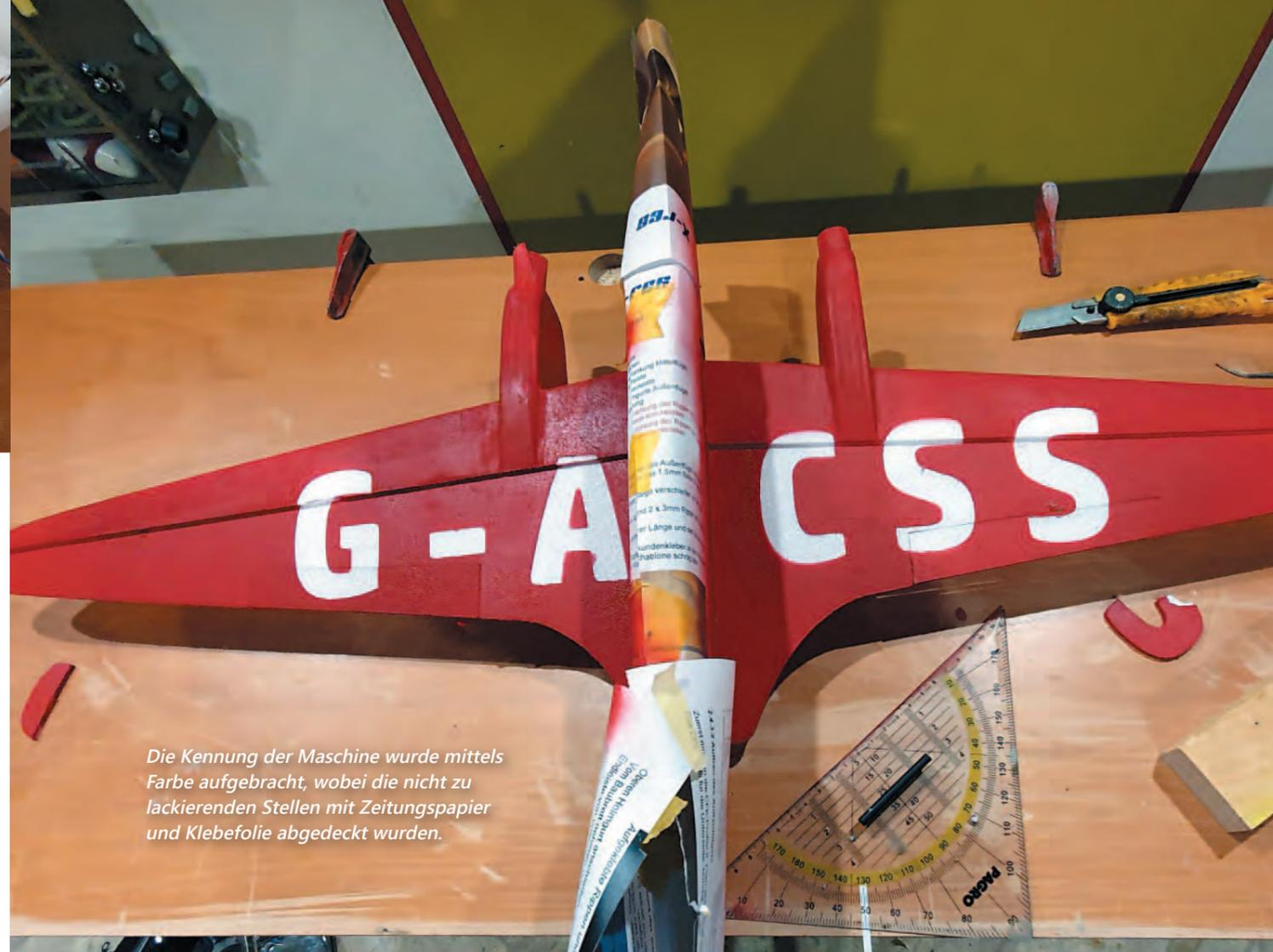
Die Kennung der Maschine wurde mittels Farbe aufgebracht, wobei die nicht zu lackierenden Stellen mit Zeitungspapier und Klebefolie abgedeckt wurden.
