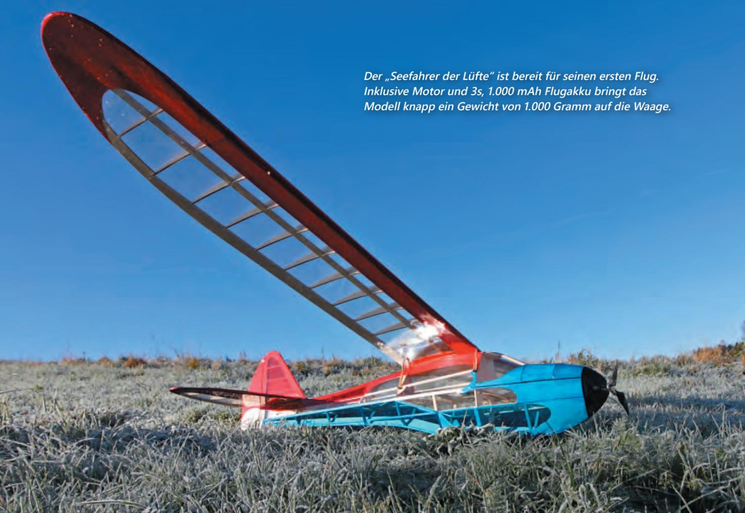
Der „Seefahrer der Lüfte“ ist bereit für seinen ersten Flug. Inklusive Motor und 3s, 1.000 mAh Flugakku bringt das Modell knapp ein Gewicht von 1.000 Gramm auf die Waage.
