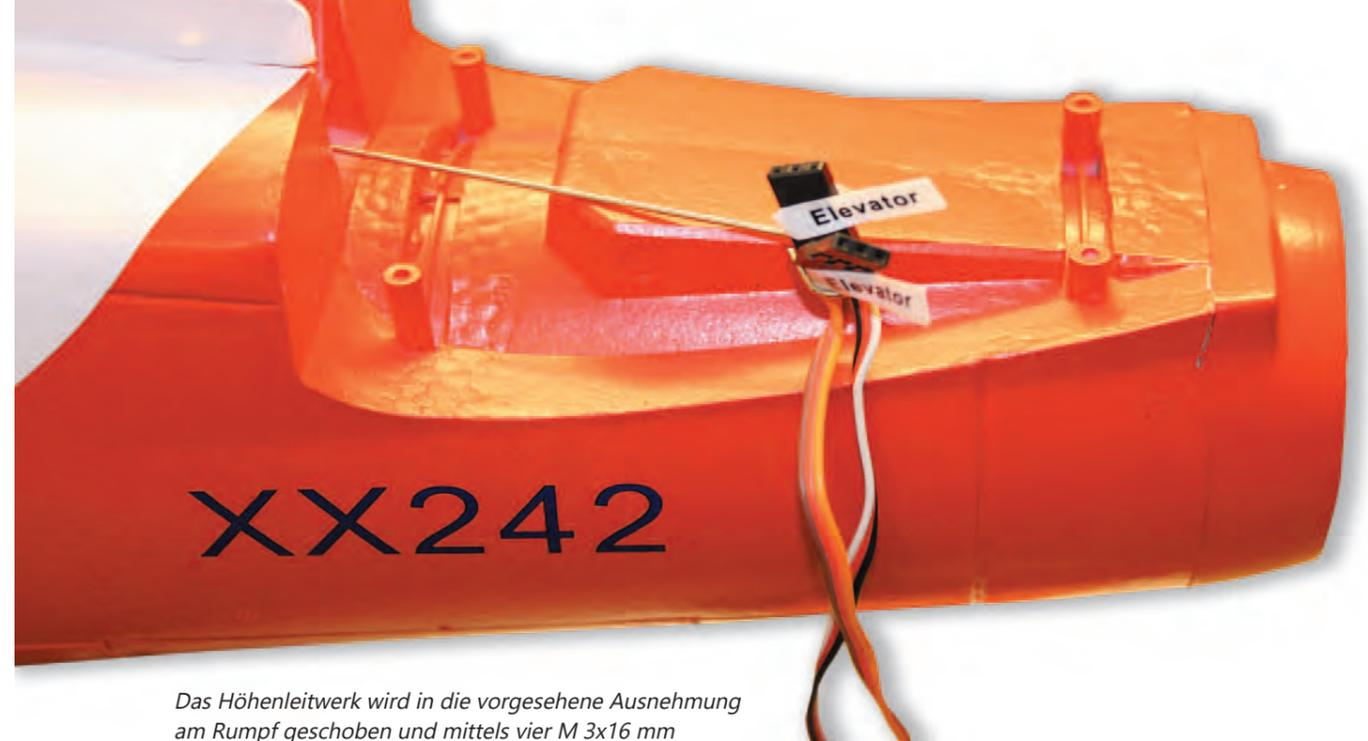
Das Höhenleitwerk wird in die vorgesehene Ausnehmung am Rumpf geschoben und mittels vier M 3x16 mm Schrauben befestigt.
