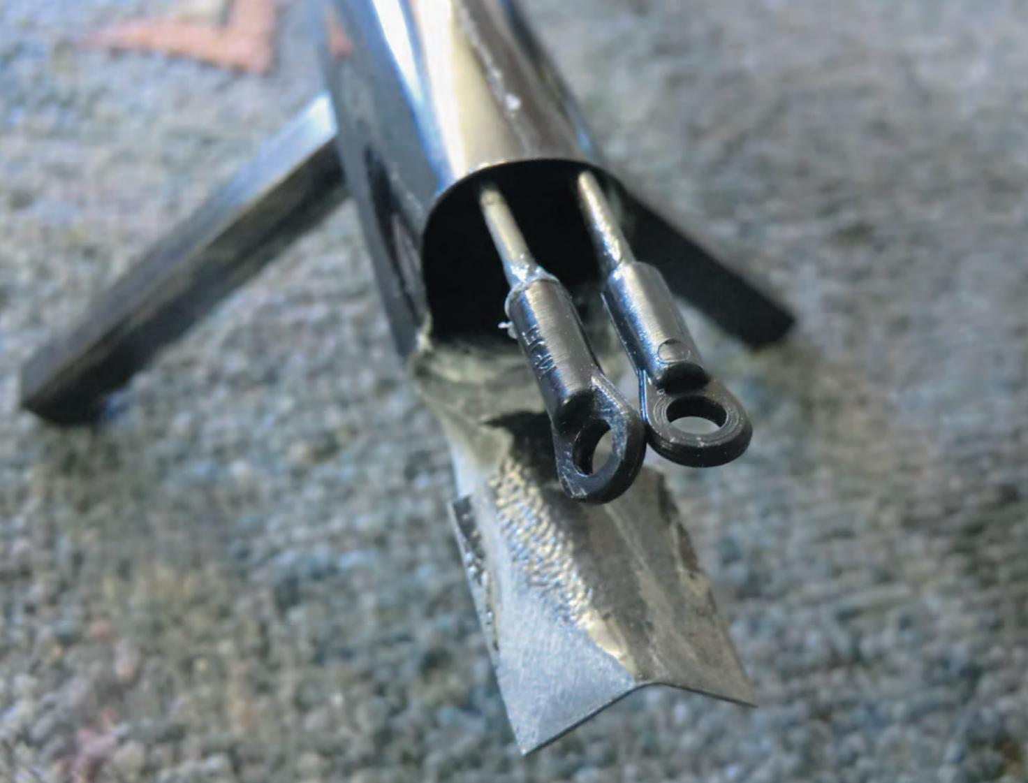
Das V-Leitwerk wird nur auf die vorgesehenen Kohlestäbe am Rumpf aufgeschoben. Die fertig eingebauten Schubstangen samt Kugelköpfen werden jeweils an den Rudern eingeklippt.
