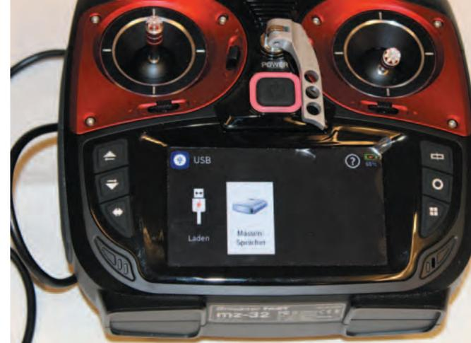
Nach Verbindung mit dem USB-Kabel erscheint automatisch auf dem Display das Massenspeicher-symbol. Mittels Fingertip erscheint im Dateimanager der Massenspeicher als eigenes Laufwerk.
