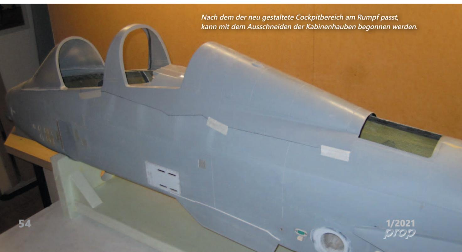
Nach dem der neu gestaltete Cockpitbereich am Rumpf passt, kann mit dem Ausschneiden der Kabinenhauben begonnen werden.
