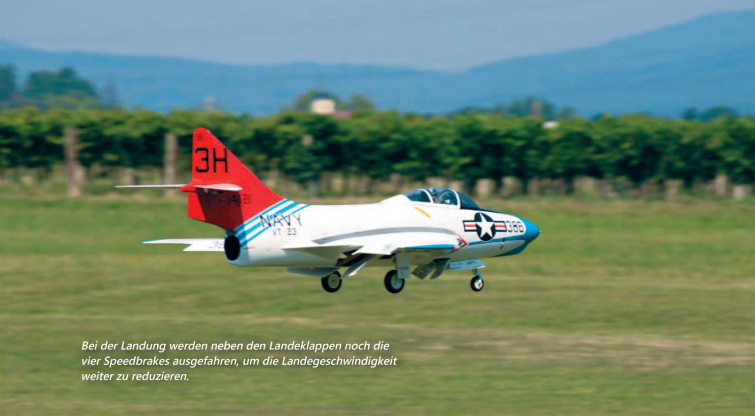
Bei der Landung werden neben den Landeklappen noch die vier Speedbrakes ausgefahren, um die Landegeschwindigkeit weiter zu reduzieren.
