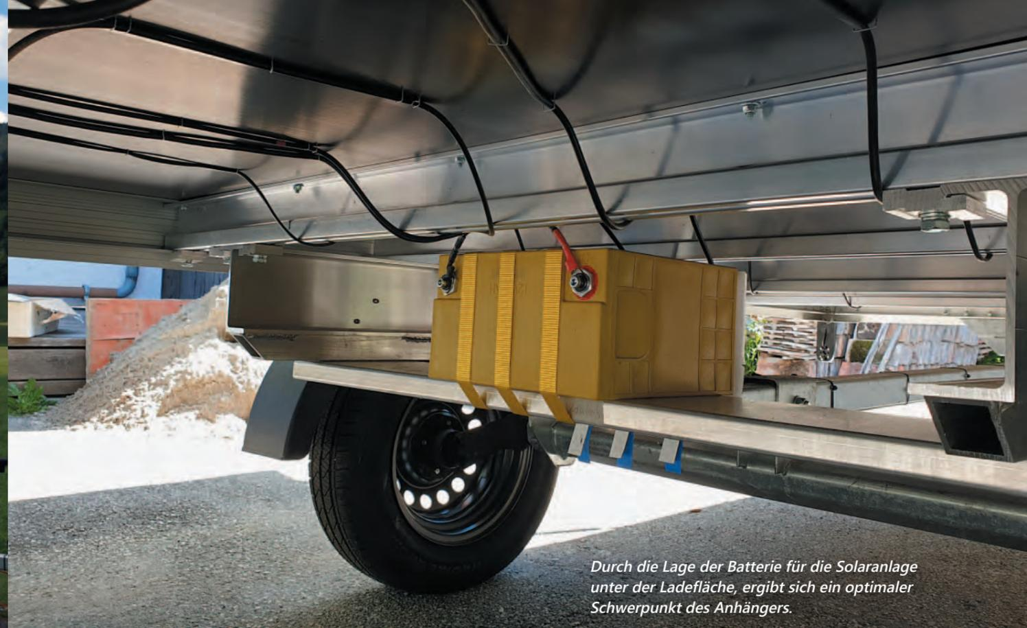
Durch die Lage der Batterie für die Solaranlage unter der Ladefläche, ergibt sich ein optimaler Schwerpunkt des Anhängers.
