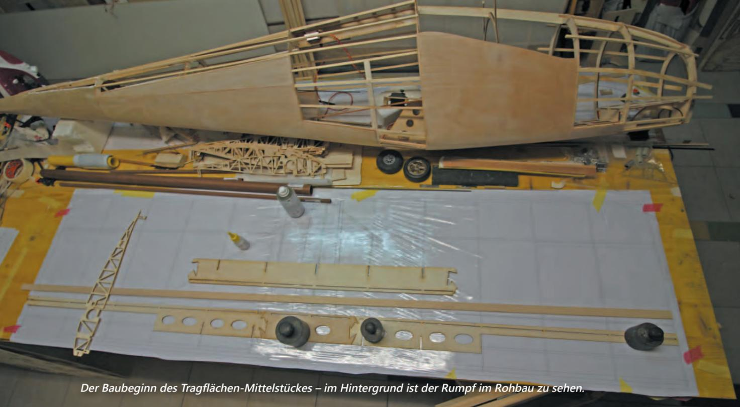
Der Baubeginn des Tragflächen-Mittelstückes – im Hintergrund ist der Rumpf im Rohbau zu sehen.
