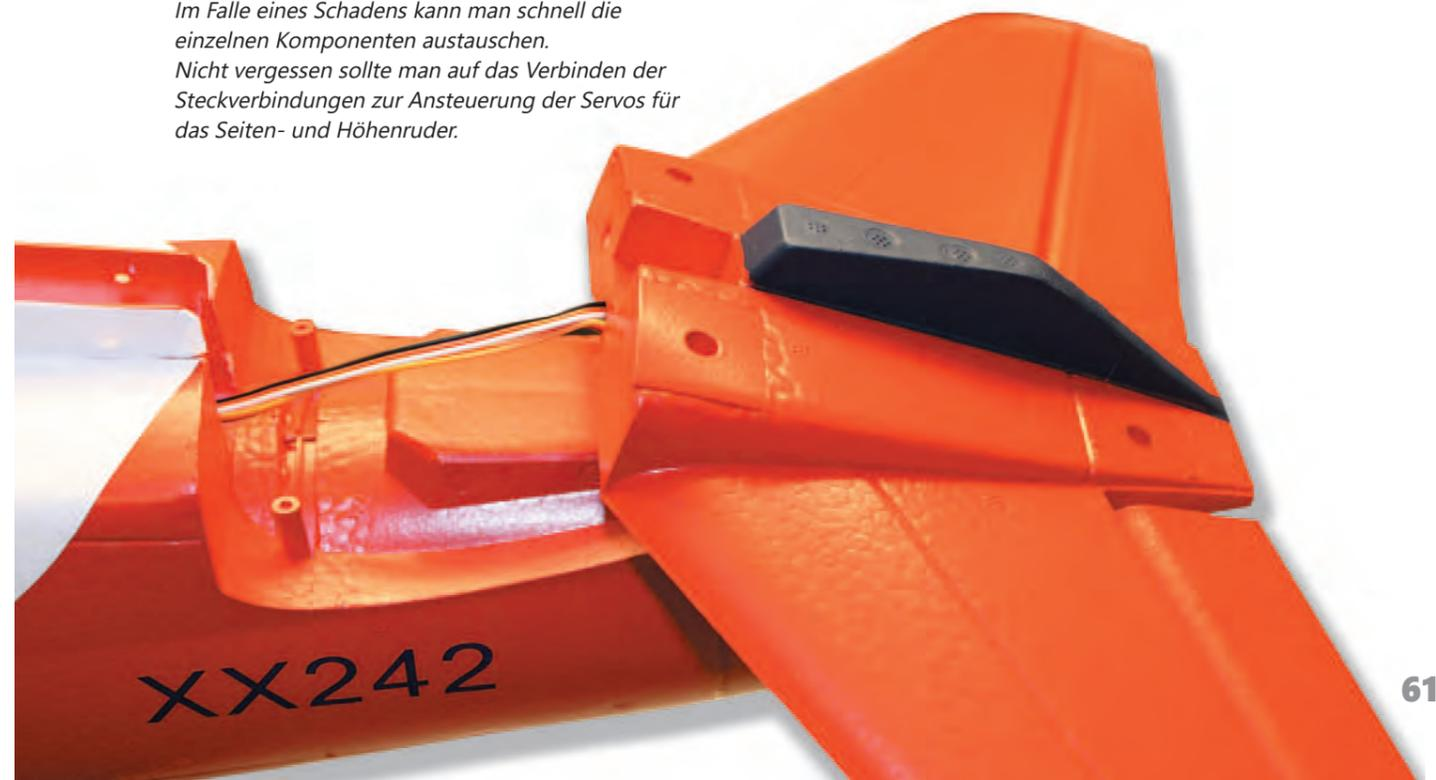
So wie das Höhenleitwerk wird auch das Seitenleitwerk mit dem Rumpf verbunden. Auch hier dienen vier Schrauben zur Befestigung und Verbindung mit dem Rumpf.
