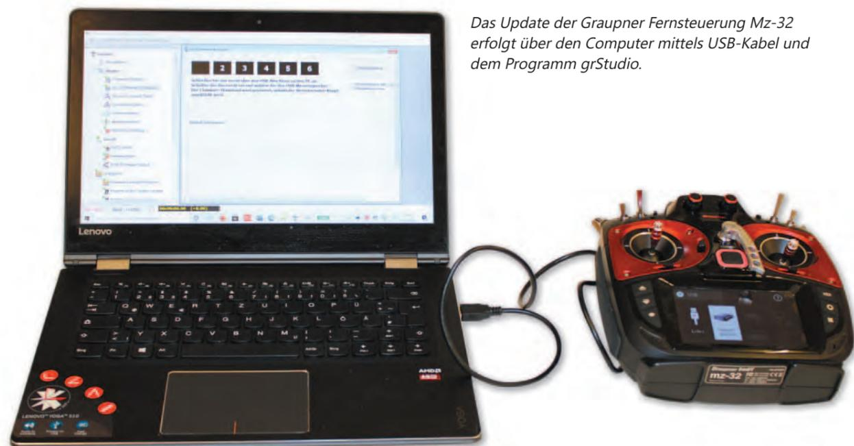
Das Update der Graupner Fernsteuerung Mz-32 erfolgt über den Computer mittels USB-Kabel und dem Programm grStudio.
