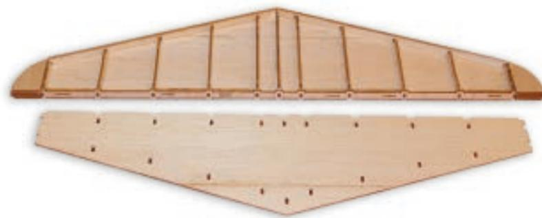
Der Aufbau des Höhenleitwerks ist ähnlich wie jenem des Seitenleitwerks, doch kommen hier wesentlich mehr Spanten zur Anwendung. Durch die Verzapfungen ist der korrekte Sitz der oberen Beplankung bereits vorgegeben.
