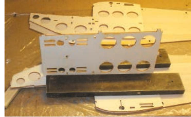
Bevor die beiden Seitenwände mit den Rumpfspanten verbunden werden, sind sie an der Innenseite mit Sperrholzteilen zu verstärken. Zusätzlich erhalten sie an der Stelle, wo der Motorspant eingesetzt wird, einen leichten Knick.
