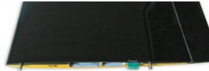
Die Kabelstecker sind an der Wurzelanformung der Tragfläche passgenau eingeklebt. Somit erfolgt beim Aufschieben der Flächenhälfte auf den Rumpf sofort der Kontakt mit der Empfangsanlage.
