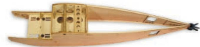
Nach dem Verkleben der linken Seitenwand kann die Zusammenführung der rückwärtigen Rumpfhälfte erfolgen. Bis zum Aushärten des Kaltleims sichern Klammern die Klebestelle.
