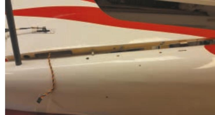
Das Höhen- und Seitenleitwerk sind abnehmbar ausgeführt, sodass bei Bedarf (z.B. Servotausch) die Demontage leicht erfolgen kann.
