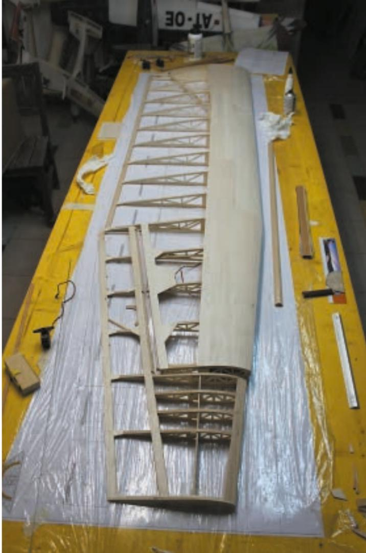
*Die Bepflanzung erfolgt mit zwei Millimeter Balsabretter, damit ist der erste Flügel fertig! Gut zu erkennen das an der Spitze über den ganzen Flügel reichende Querruder.*
