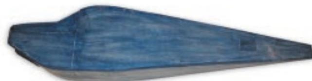
So sieht der mit Papier bespannte und geschliffene Rumpf vor dem Lackiervorgang aus.
