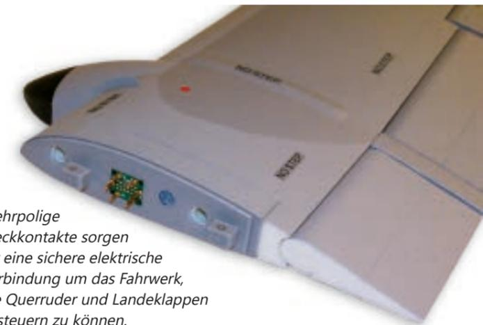
*Mehrpolige Steckkontakte sorgen für eine sichere elektrische Verbindung um das Fahrwerk, die Querruder und Landeklappen ansteuern zu können.*
