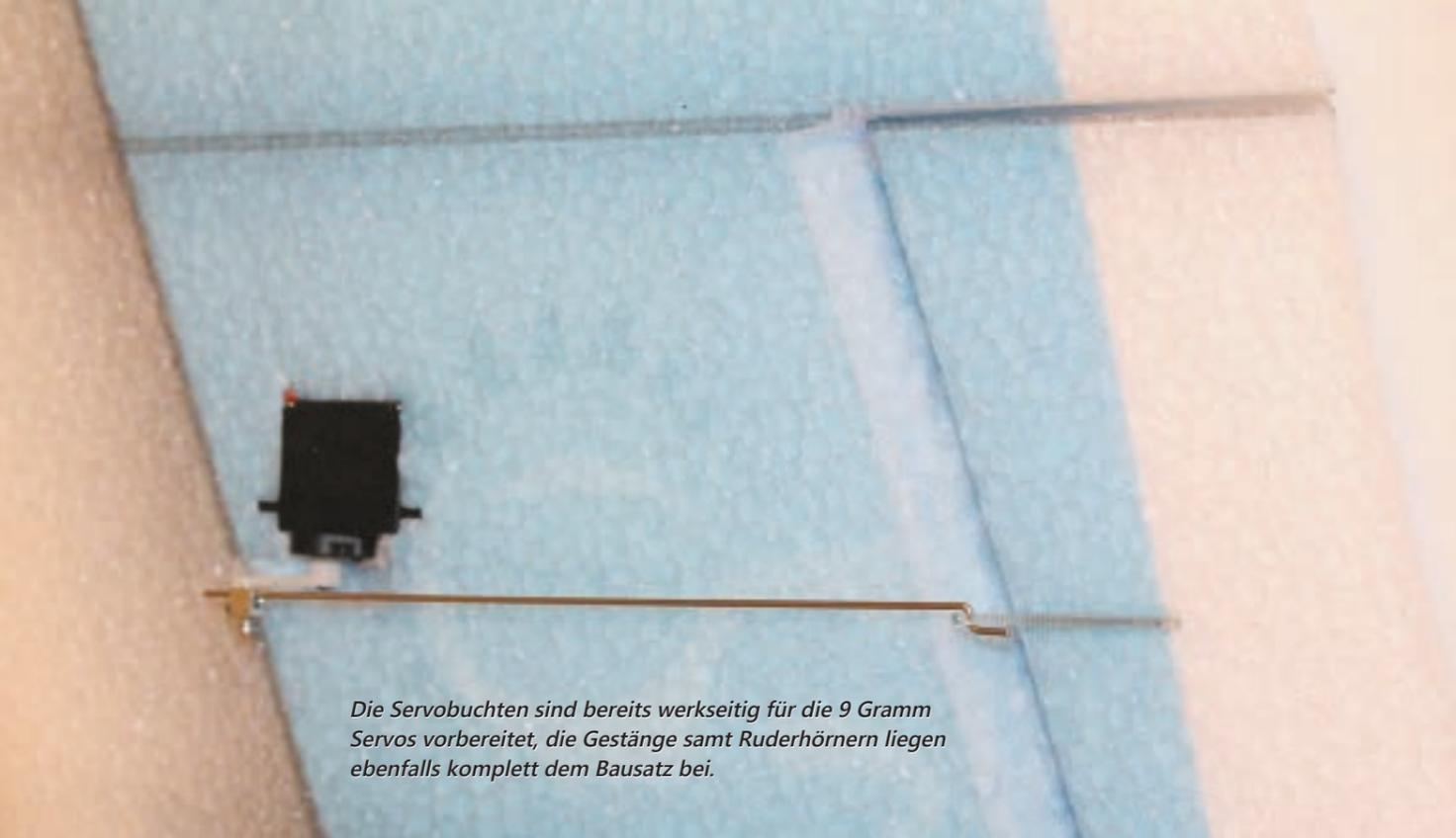
Die Servobuchten sind bereits werkseitig für die 9 Gramm Servos vorbereitet, die Gestänge samt Ruderhörnern liegen ebenfalls komplett dem Bausatz bei.
