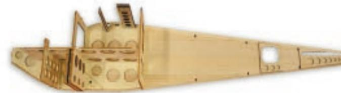
Im vorderen Bereich des Rumpfes müssen vor dem Aufsetzen der linken Rumpfwand die Haupt- bzw. Fahrwerksspanten sowie das Akkubrett eingesetzt werden. Zusätzlich erhalten die Höhenleitwerksauflage und der Ausschnitt für das Seiten-Höhenruderservo eine entsprechende Verstärkung.
