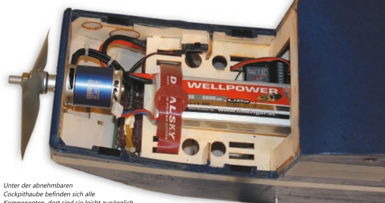
Unter der abnehmbaren Cockpithaube befinden sich alle Komponenten, dort sind sie leicht zugänglich.
