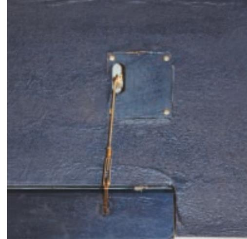
Die Anlenkung des Querruders besteht aus einem Dreimillimeter-Gestänge mit passendem Gabelkopf.
