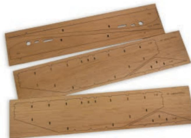
Die einzelnen Bauteile müssen vor Baubeginn mit Hilfe eines Cutters aus dem Rahmen geschnitten werden. Durch die auf den Bauteilen befindlichen Nummer, ist die spätere Zuordnung leicht möglich.
