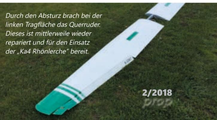
Durch den Absturz brach bei der linken Tragfläche das Querruder. Dieses ist mittlerweile wieder repariert und für den Einsatz der „Ka4 Rhönlerche“ bereit.
