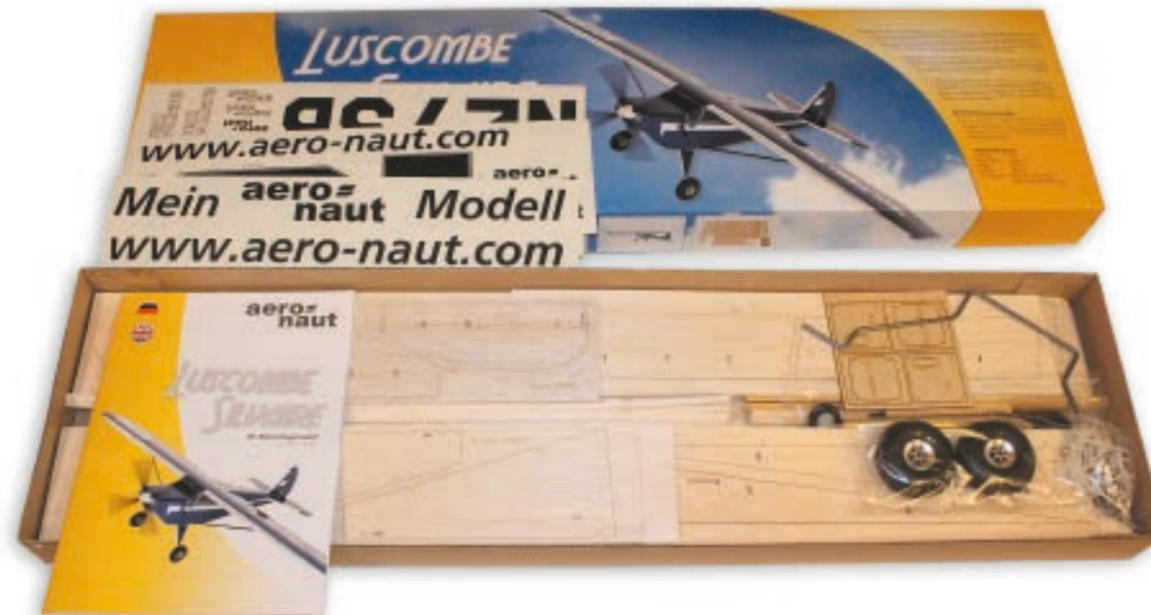
In dem bunten Verpackungskarton befinden sich die lasergeschnittenen Balsa-Sperrholzbrettchen, aus denen später das Modell der Luscombe Silvaire entsteht. Des Weiteren sind die Bauanleitung, der Dekorbogen und alle benötigten Kleinteile enthalten. Sogar auf die Räder des Hauptfahrwerks und Spornrades hat der Hersteller nicht vergessen.
