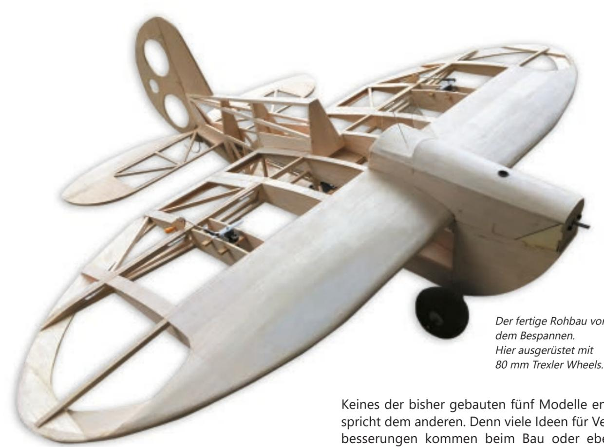
Der fertige Rohbau vor dem Bespannen. Hier ausgerüstet mit 80 mm Trexler Wheels.
