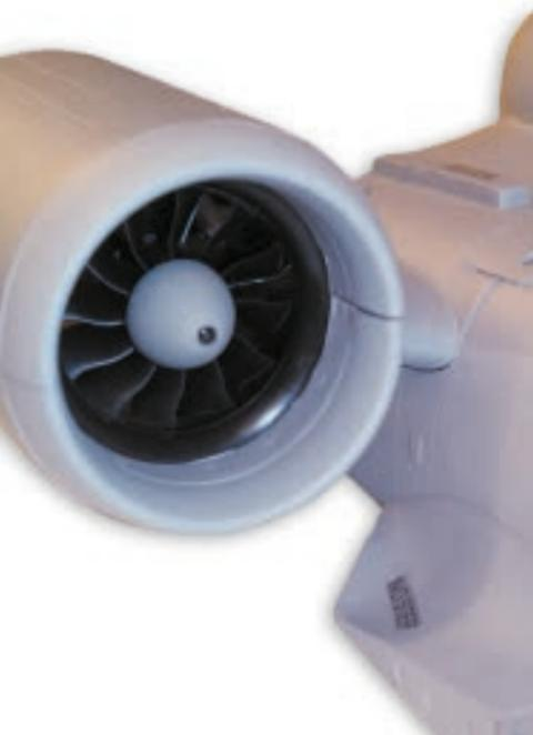
Einer der beiden 12-blättrigen 70 mm Impeller der von einem 1.850 kV Brushlessmotor angetrieben wird.
