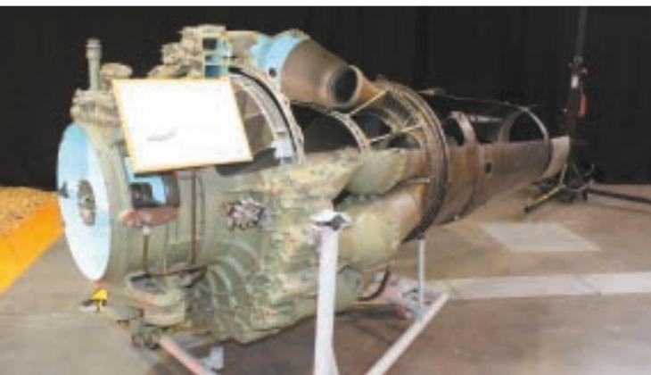
Der Saab J-29F Tonne wurde von diesem Triebwerk, dem Svenska Flygmotor RM2 angetrieben.
