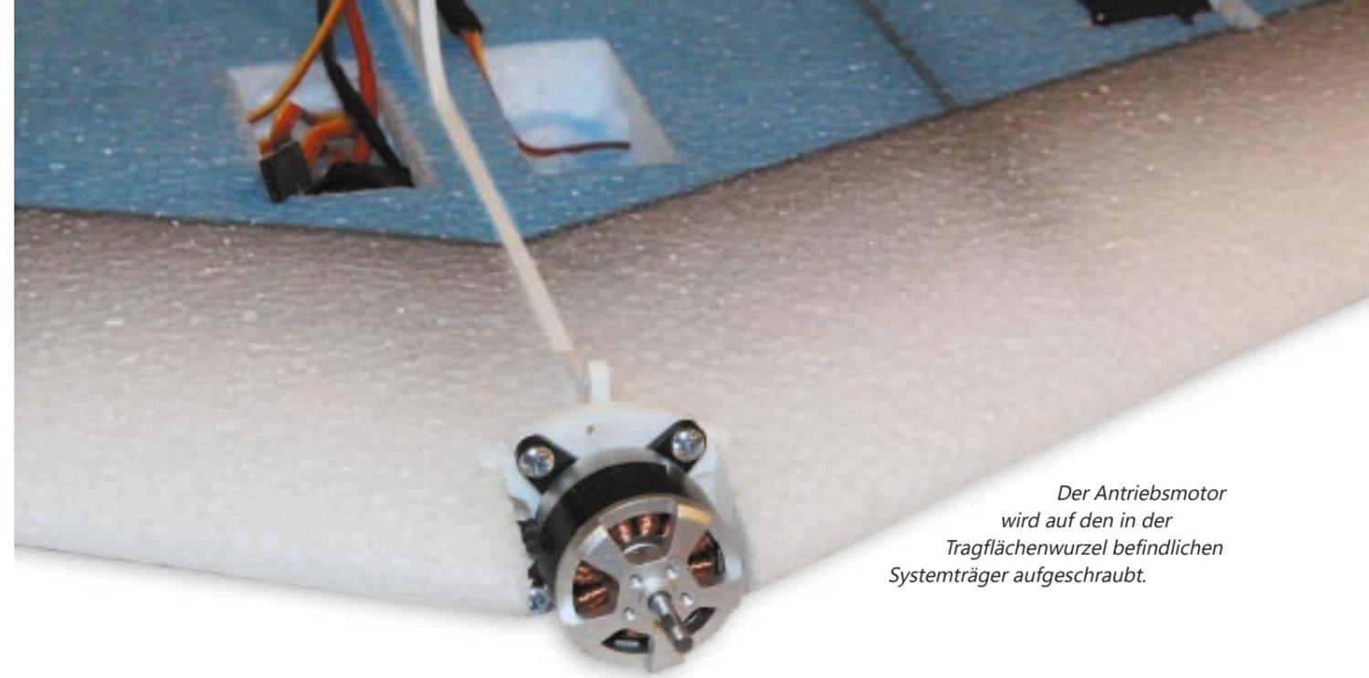
Der Antriebsmotor wird auf den in der Tragflächenwurzel befindlichen Systemträger aufgeschraubt.
