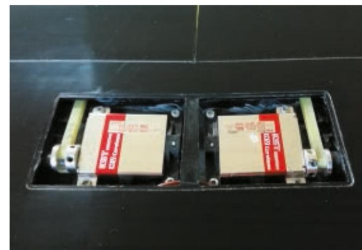
*Bei den Wölbklappen und Querrudern kommen KTS DS 225 MG Servos zum Einsatz. Die ab Hersteller mitgelieferten Servorahmen aus Sperrholz mit Gegenlager wurden durch solche von Servorahmen.de ersetzt.*
