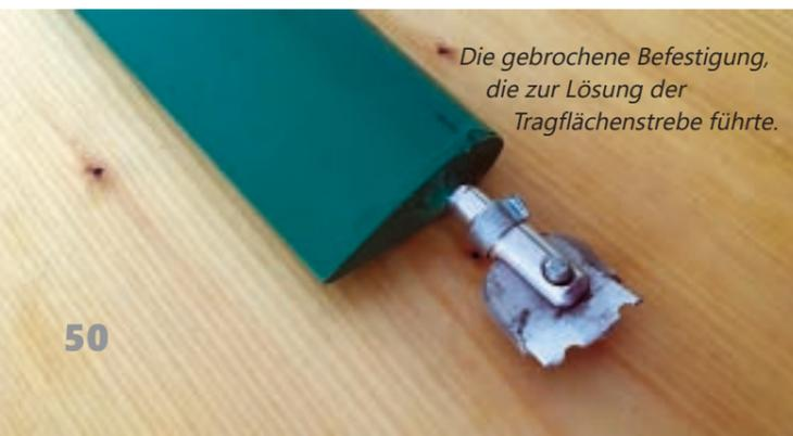
Die gebrochene Befestigung, die zur Lösung der Tragflächenstrebe führte.
