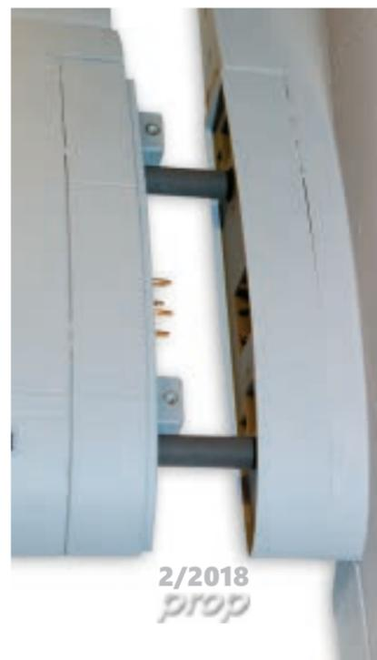
*Zwei CFK Rohre sorgen für Ausrichtung und Halt der Tragflächenhälften an der Tragflächenwurzel. Die beiden Tragflächenhälften werden nur aufgeschoben und anschließend mit zwei 3 x 20 mm Schrauben am Rumpf fixiert.*
