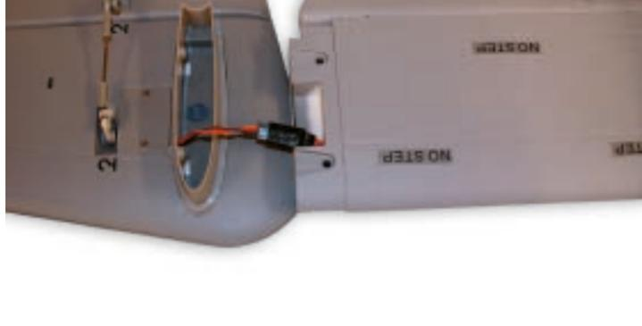
Bevor die das rechte Seitenleitwerk mit dem Höhenleitwerk verbunden wird, sind noch die beiden Stecker zur Ansteuerung des Seitenruders zu verbinden.
