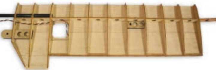
Beim Aufbau der Tragfläche muss zuerst die obere und untere Beplankung aus mehreren Teilen verleimt werden, bevor der Hauptholm samt den übrigen Spanten aufgesetzt wird.
