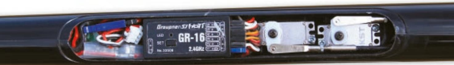
Im schmalen Rumpf finden gerade der Empfänger und die beiden Servos für das Pendelleitwerk Platz.
