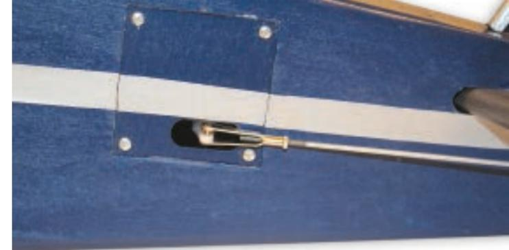
Im rückwärtigen Bereich des Rumpfes sind auf der rechten und linken Rumpfwand die Servos für das Seiten- und Höhenruder eingebaut.
