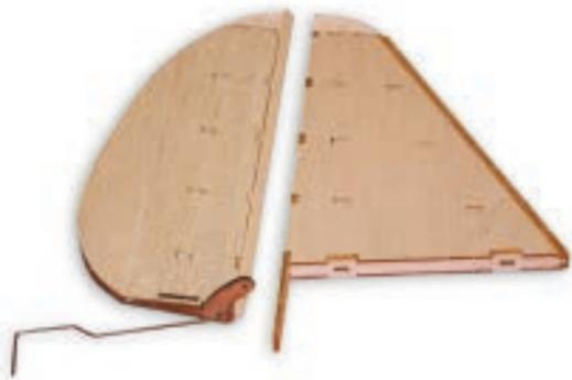
Das fertig gestellte Seitenleitwerk mit dem bereits eingebauten Spornfahrwerksdraht und dem Ruderhorn. Die Anpassung der Kontur muss noch durch Schleifen in die richtige Form erfolgen.
