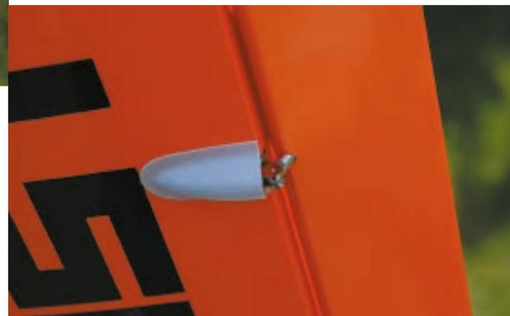
Die Servoabdeckungen an der Ober- und Unterseite schützen das Gestänge vor Beschädigungen. Sie werden mittels UHU-Por nach dem Feinjustieren der Gestänge aufgeklebt.
