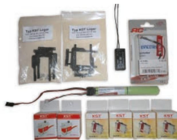
*Zur Fertigstellung werden noch die Servos, der Empfänger samt Akku sowie Servorahmen benötigt. Zusätzlich hat der Autor dem Modell einen EMCOTEC-Sicherheitsschalter spendiert.*
