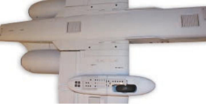
Die beiden Tragflächenhälften können zum Transport jederzeit demontiert werden. Dafür muss man nur vier Schrauben lösen und die Hälften herausziehen.
