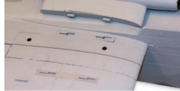
Die Attrappen der Bewaffnung werden einfach in Schienen an der Tragflächenunterseite eingeklippt und durch Verschieben gesichert.
