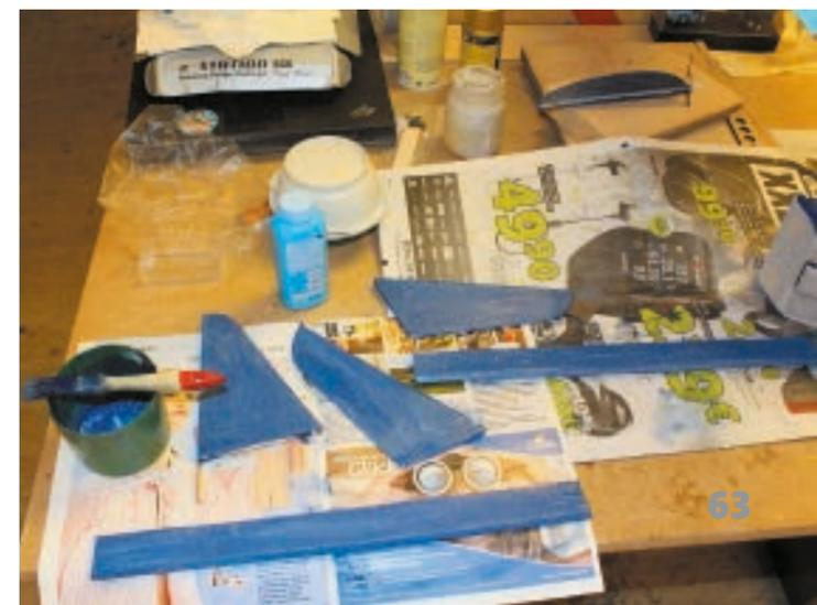
Zum Schutz der Oberfläche erfolgt das Bespannen mit Papier, welches mit Hilfe von verdünntem Tapetenkleber aufgebracht wird.
