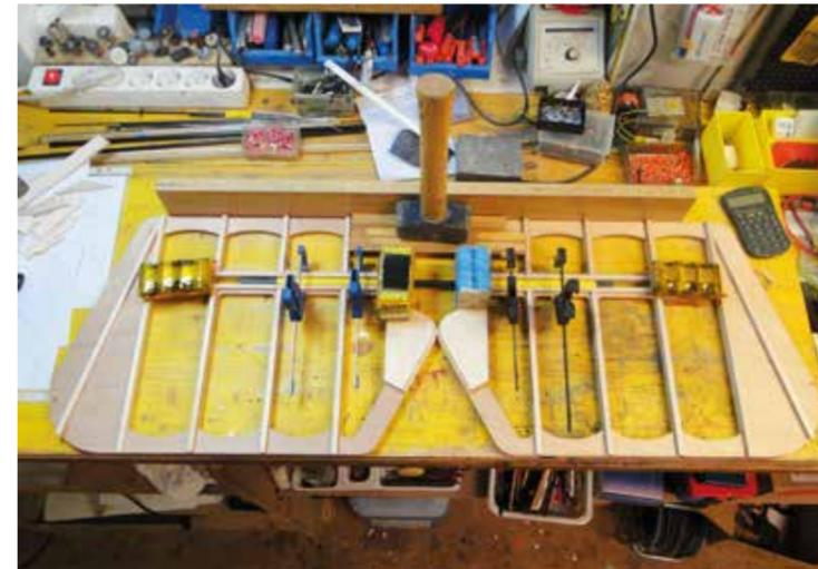
Das Höhenleitwerk wurde mit dem im Bausatz enthaltenen Teilen auf dem CAD-Zeichnung erstellt.
