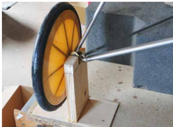
Die Räder sind ein kleiner Bausatz für sich. Ein spezieller Sekundenkleber für Gummi hält die Reifen bombensicher zusammen.
