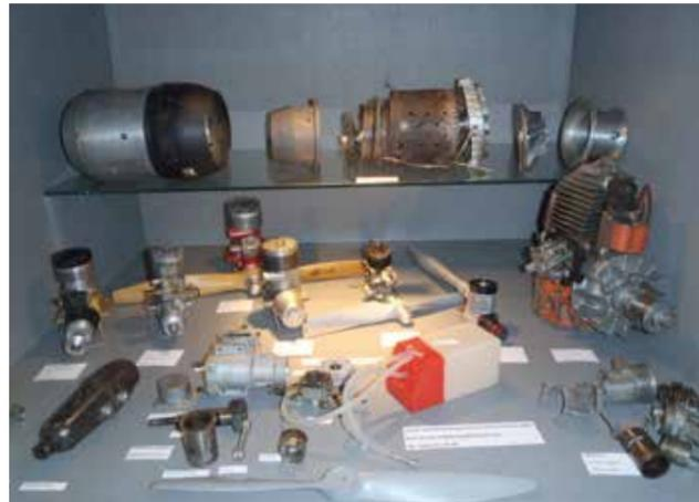
Modellmotoren vom Hörnlein-Profi 40 (li), über Webra Glos-tar (Mitte) bis zum Benziner Quadra 35. Im Vordergrund ein Webra Speed 40, zerlegt in Einzelteile. Im Hintergrund eine zerlegte Walluschnig-Turbine, 120 N Schub.
