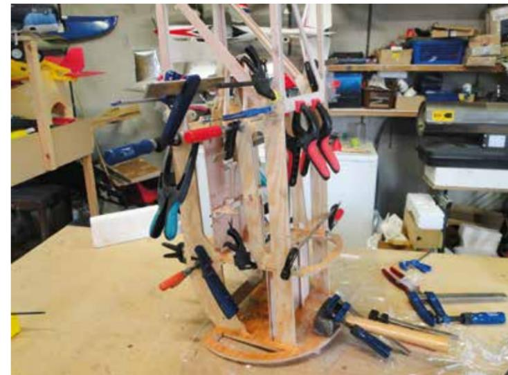
Nach Fertigstellung des Rumpfhinter- und Vorderteils steht die „Hochzeit“ an, also die Verbindung beider Teile.
