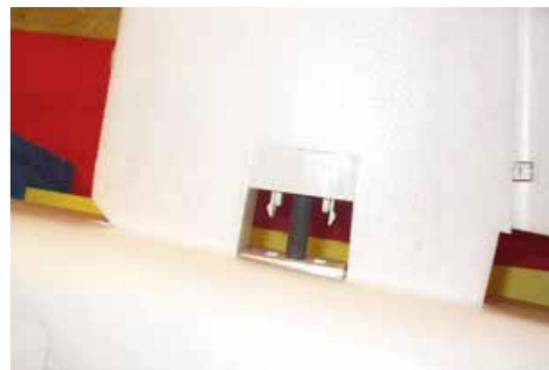
Clip-Verschluss und CFK-Stab schaffen eine sichere Verbindung mit der Tragfläche. Zwecks Transports kann die Tragfläche sehr leicht demontiert werden.
