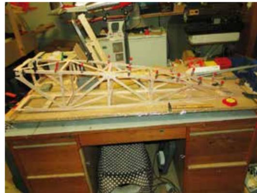
Die Fräsungen der Bauteile sind so exakt, dass man das Gerüst ohne Leim zusammenstecken kann.
