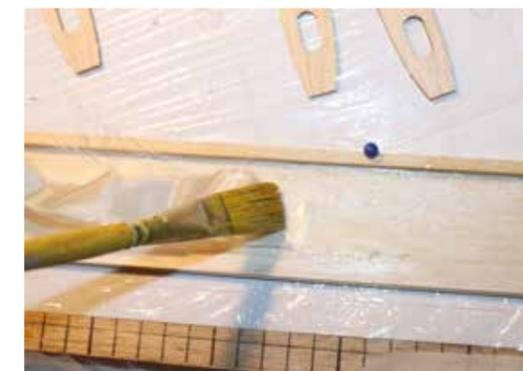
Beim Sequoia Modell wird die Tragfläche aus Festigkeitsgründen auf der Unterseite mit Glasmatte laminiert.
