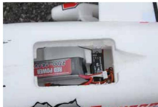
Im vorderen Bereich des Rumpfes befindet sich unter einem abnehmbaren Deckel ein Fach, in dem der Empfänger und Flugakku untergebracht ist.
