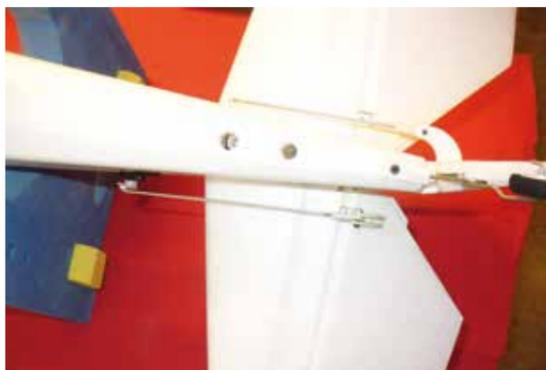
Zur Befestigung des Seiten-Höhenleitwerks wird ein längerer als der im Kleinteileset befindliche Inbusschlüssel benötigt.
