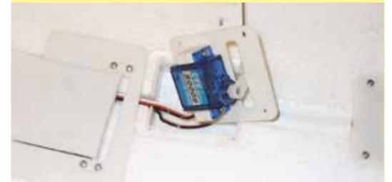
**Digital servos der 9-mm-Klasse übernehmen die Ansteuerung der Ruderflächen. Hier ist das Servo für die rechte Landeklappe zu sehen. Qualitativ hochwertige Servorahmen und Deckel halten das Servo sicher in seiner Position, wodurch eine exakte Führung der Ruder ermöglicht wird.**
