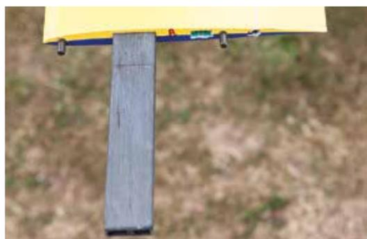
Im CFK-Flächenverbinder ist Platz für Ballast: Vier Messingstangen 6 x 12 x 150 mm bringen 370 g auf die Waage.
