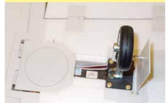
**Eine echte Show ist das Ein- und Ausfahren der Fahrwerksbeine samt Fahrwerks-Abdeckklappen.**
