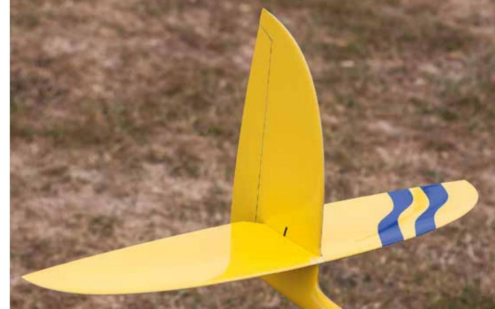
Die Steckung des HLW hatte etwas Luft und wurde mit Sekundenkleber aufgedickt, wie in der Anleitung beschrieben. Jetzt passt es.
