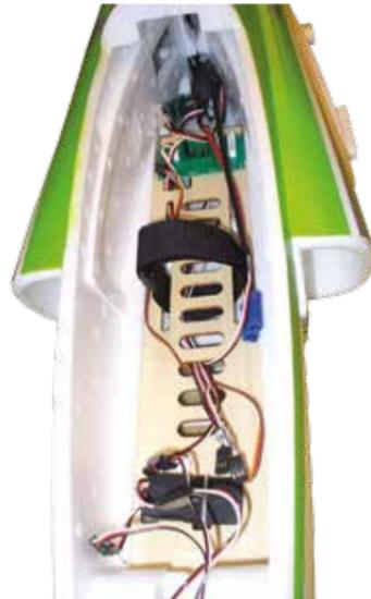
**Sämtliche Verkabelungsarbeiten sind bereits herstellerseitig erledigt, man muss nur noch den Empfänger seines Fernsteuersystems einbauen und die Funktionen programmieren.**
