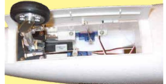
**Ansicht des Bugfahrwerks mit Anlenk- und Klappenmechanik Das Bugfahrwerk ist aus massivem Aluminium hergestellt und gegen Landestöße gut gelagert. Somit sind auch Start- und Landung von einer Graspiste kein Problem.**
