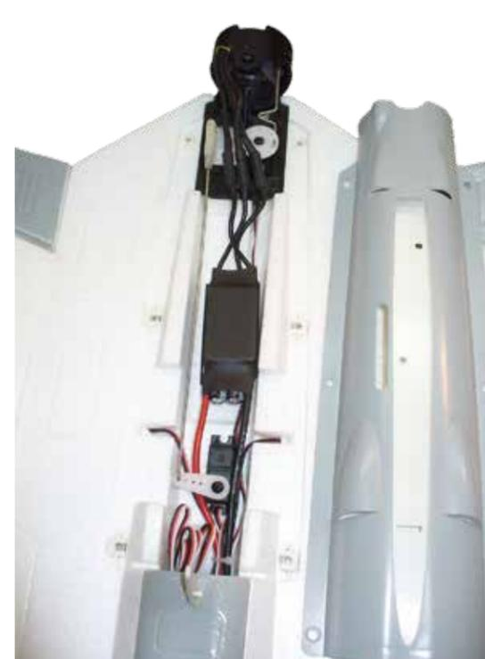
Nach der Abnahme des Rückendeckels kommen der 40A-Regler, der Servo zur Anlenkung des Seitenruders sowie die Mechanik für die Seitenvektorsteuerung zum Vorschein.
