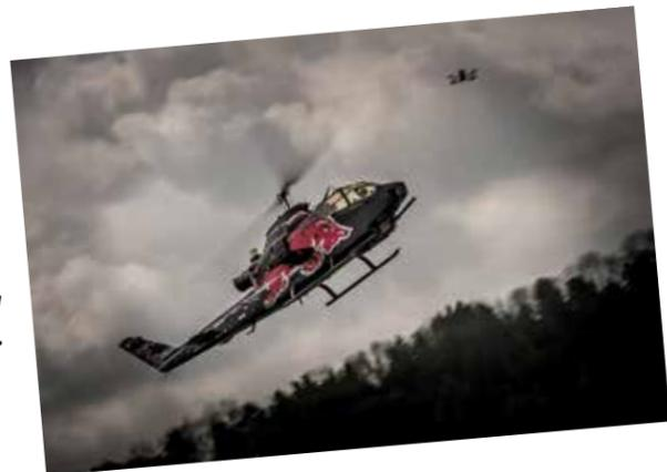
▲ Sepp Schmirll mit seiner Cobra in den Farben von Red Bull. Das Modell gehört zu den weltgrößten Scale-Helikoptern und besticht durch einen detailgetreuen Nachbau des Originals. Einige Daten dieses Giganten der Modellhubschrauber: Rotordurchmesser 3350 mm, Länge 3520 mm, Gewicht 36,5 kg (zulassungspflichtig), Antrieb Jakaofsky Pro XXL-Turbine, Bauzeit ca.1600 Stunden
