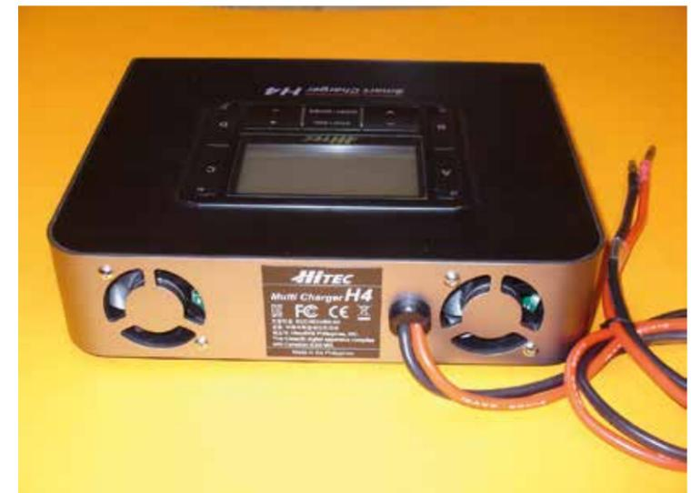
Auf der rückwärtigen Seite befinden sich die Auslässe für die beiden Lüfter und das Netz-Abschlusskabel
