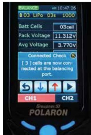
Displayansicht Balancen eines 3S Lipo auf 0,002 V genau
