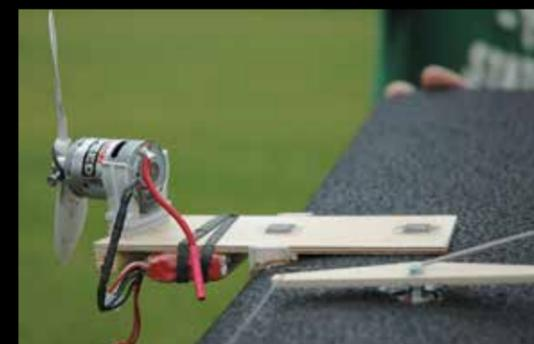
Der Antrieb mit Magnethalterung (Speed 400 Motor und Akku), im Vordergrund das Steuersegment
