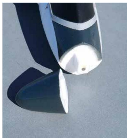
Die Rumpfspitze ist abnehmbar gestaltet und im Lieferumfang liegt sogar eine Ersatzspitze bei.
