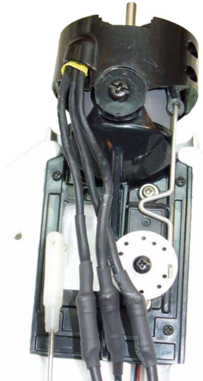
Ansicht der seitlichen Schubvektorsteuerung, die mittige Ausrichtung des Antriebs kann Mithilfe einer Zange bei dem gebogenen Steuerstahldraht erfolgen.
