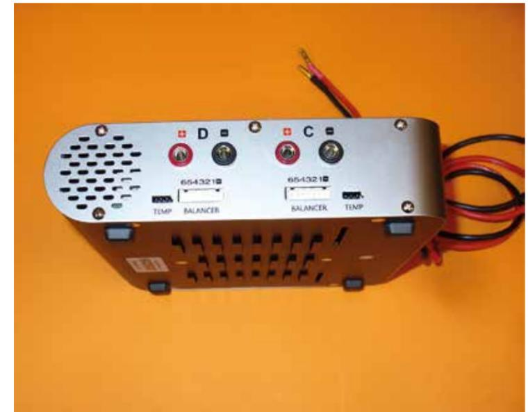
Seitenansicht mit Ladeausgängen C und D, Balancerport und Temperaturanschluss
