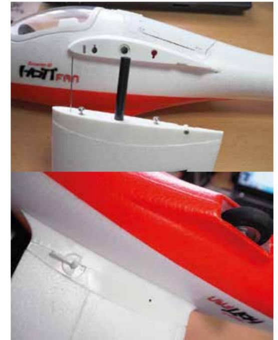
Sauberer Flächen-Rumpfübergang mit einfacher aber effektiver Flächenverriegelung
