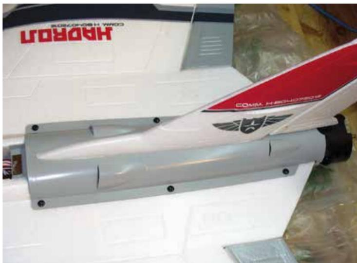
Das Seitenleitwerk wird einfach mittels zweier Schrauben in der oberen Rumpfabdeckung festgehalten.
