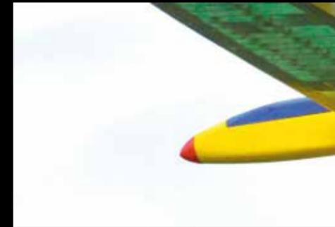
Spinner als Seglernase auf den Motorspant geklebt
