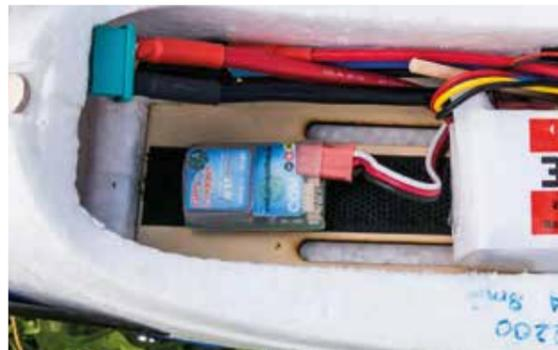
**Auch außen am Modell kann man den Logger platzieren. Der RC GPSlog von rc-electronics.org hat ein eingebautes Mikrophon. Damit lassen sich Motorlaufzeiten eindeutig identifizieren.**
