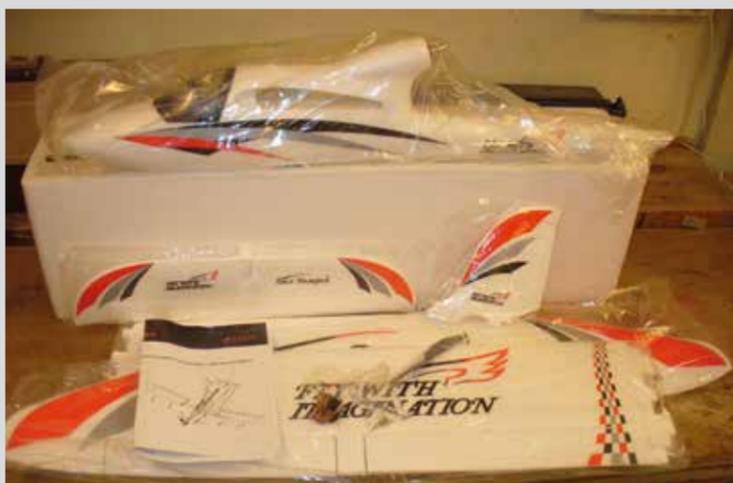
Die Einzelteile des Modells Skysurfer kommen fein säuberlich in einzeln verpackt beim Kunden an. Bis auf den Empfänger und den 3s2200 Flugakku sind alle benötigten Komponenten im Bausatz enthalten.
