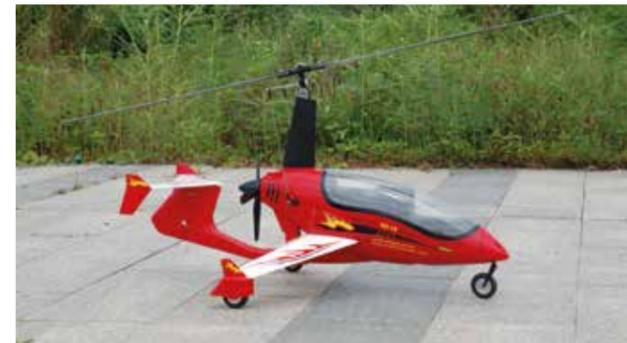
ten Rasenplätzen. Rumpf und Flügel bestehen aus einer EPO/Alu Konstruktion. Das mit Alurädern bestückte Fahrwerk ist aus hochfestem Stahl gefertigt. Die Carbonrotorblätter ergeben einen imposanten Rotordurchmesser von 1320mm.
