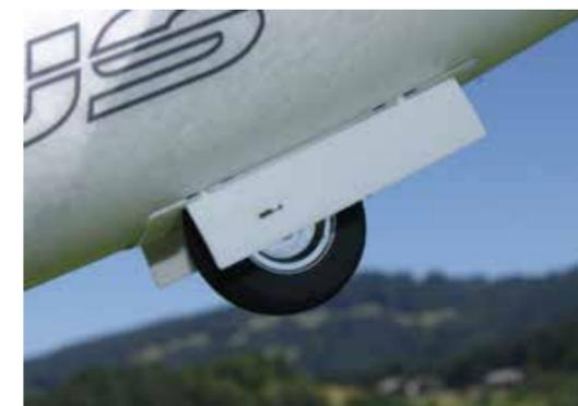
Hier ist das äußerst stabile ausgefahrene Einziehfahrwerk zu sehen.
