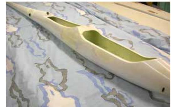
Der Rumpf bereits zusammengeheftet, links oben ist eines von zwei Bearbeitungslöchern gut zu erkennen
