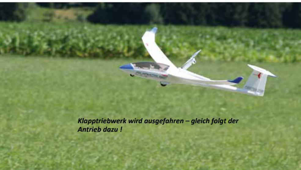
Klaptriebwerk wird ausgefahren – gleich folgt der Antrieb dazu!
