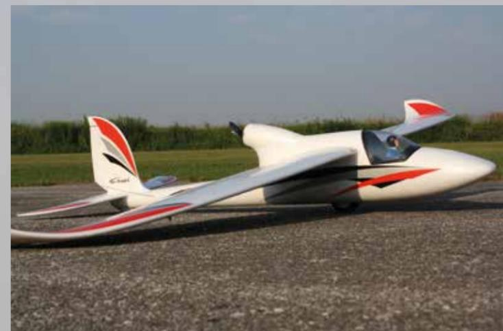
**Durch das mittige Fahrwerksrad sind Bodenstarts sowohl auf einer Asphalt-, als auch auf Rasenpiste ohne Probleme möglich.**
