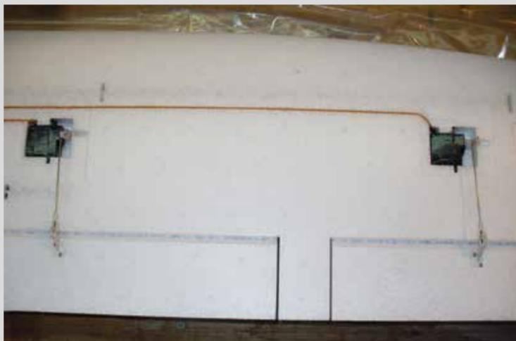
Die Servos für Querruder und Landeklappen sind bereits fertig eingebaut und es sind nur mehr die Gestänge einzuhängen.
