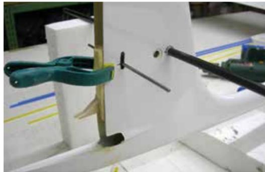
Das Kohlerohr liegt auf zwei gleich hohen Auflagen und wird so gegen die montierte Tragfläche ausgerichtet.
