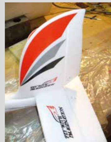
Ansicht des fertig montierten Seiten- und Höhenleitwerks
