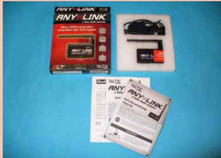
Revell/Hobbico geht einen neuen Weg, wenn es darum geht, Empfangssysteme von Fremdfabrikaten für seine eigenen Modellen zugänglich zu machen. Speziell bei der Mikro Tx-R Serie ist der Austausch des fabrikmäßig eingebauten Empfängers nicht möglich, da er fix verbaut ist. Die Lösung heißt hier ANYLINK und mit Hilfe dieses Moduls kann man sein Revell/Hobbico Modell mit fast jeder am Markt erhältlicher Fernsteuerung binden.
