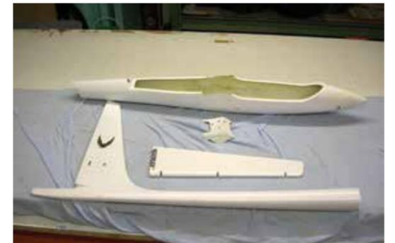
Die Ausgangssituation, Rumpfrohr abgebrochen, Rumpfkeule mehrfach gesprungen, Flächenmontage abgetrennt
