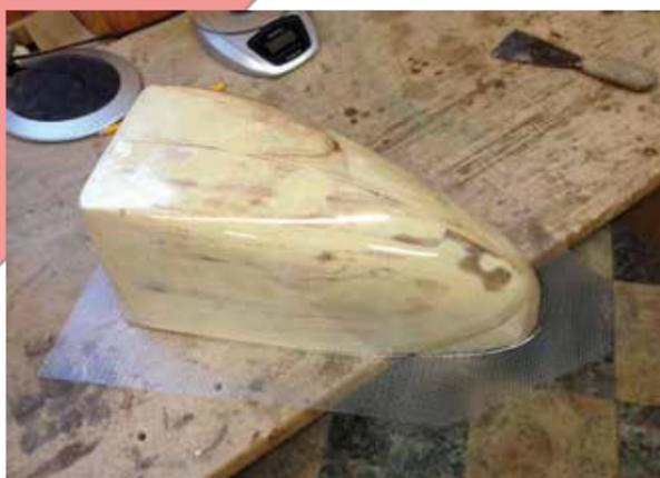
ist dies das auf dem entsprechenden Foto. Die Schleifkufe aus 10 mm starkem Birkensterrholz wurde verleimt und ein Balsaklotz für die Nase angeleimt. Jetzt hatte der Rumpf schon eine gute Stabilität und konnte von der Helling genommen werden - eine Augenweide wie er aussah und in der Länge übertrumpfte der Rumpf sogar mich!
