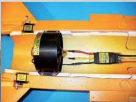
Die gesamte Antriebseinheit sitzt im hinteren Bereich des Rumpfes und ist so verbaut, dass möglichst keine Störungen des Luftstrahles auftreten.
