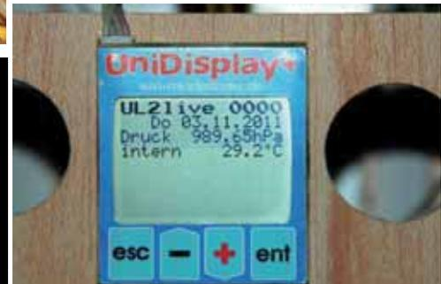
Bildschirm 3 zeigt den barometrischen Luftdruck sowie die interne Temperatur des UniLog
