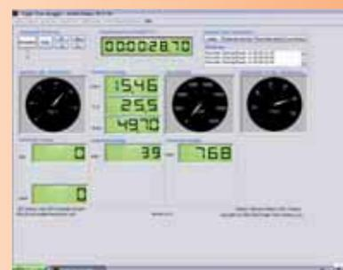
Mit Hilfe des Eagletree Datenloggers wurden die Belastungswerte des 4s- Akkus mit 3300 mAh erfasst. Eine eigene Software dient zur grafischen Auswertung der Mess- Ergebnisse am PC. Nach 28 Sekunden Motorlaufzeit beträgt der Strom 49,7 A, die Akkuspannung 15,46V und die derzeit abgegebene Leistung 768 Watt. Als Antrieb kommt hier ein WEMOTEC Midifan-Impeller und ein Plettenberg P230 Motor zur Anwendung.
