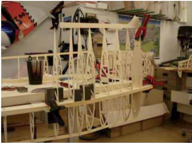
Zum Einsetzen und Verkleben der hinteren Halbrippen wird der Holm auf zwei am Tisch montierten Aluminiumprofilen aufgelegt und fixiert.
