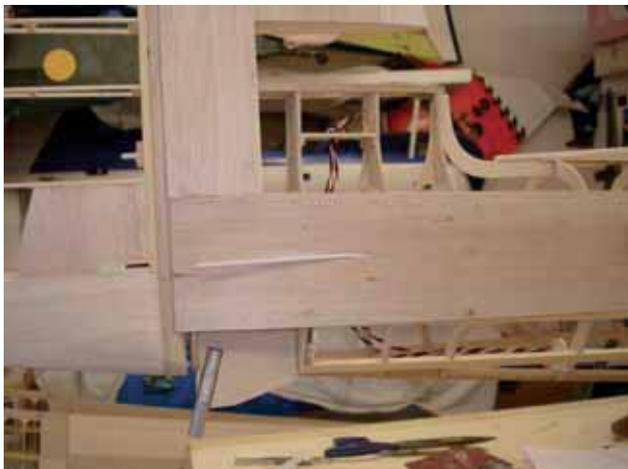
*Heckansicht mit Auslass für die Seitenrudieranlenkung, Servokabel für Höhenruderservo und das Aluminiumrohr für den gefederten Hecksporn*
