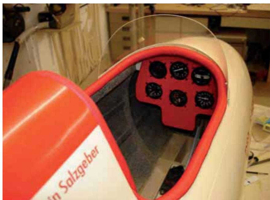
*Cockpit mit dreidimensionalen Instrumenten aus dem Hause Martin Masal. Martin fertigt diese Instrumente in jedem Maßstab.*
