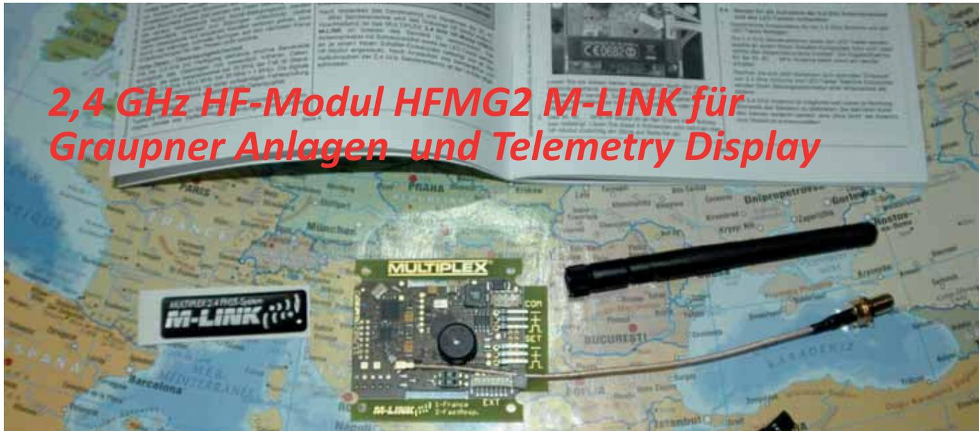
MULTIPLEX liefert mit dem HF-Modul HFMG2 M-LINK eine einfache Möglichkeit eine bestehende 35 oder 40MHz Anlage der Sender MC 19, MC19s sowie MC 22 und MC 22s auf das aktuelle 2,4 GHz System umzustellen. Die beiliegende Einbauanleitung ist Multiplex typisch ausführlich und mit vielen Detailbildern auch für Nichtelektroniker verständlich geschrieben.
