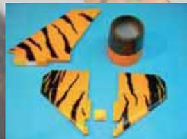
Bei den einzelnen Teilen müssen noch die Schaumstoffrückstände vom Gießen abgetrennt und die Oberfläche mit feinem Schleifpapier nachgeschliffen werden.
