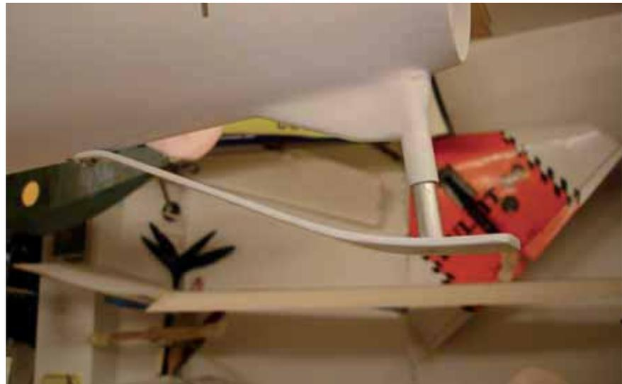
*Ebenfalls selbst hergestellt sind der gefederte Sporn und der Pilotensitz aus mehreren Schichten 0,6 Birkenperrholz und Glasgewebe.*
