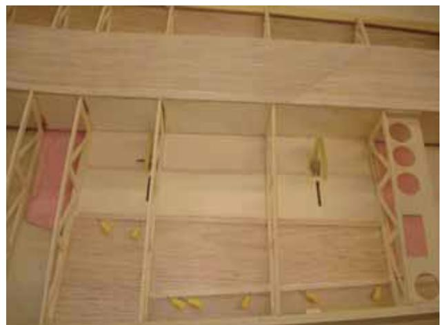
Einblick zur Mechanik der Sturzflugbremsen, rechts davon eine der beiden Querruderservoaufnahmen
