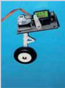
So sieht die vor dem Einbau fertiggestellte Bugfahrwerkseinheit aus. Durch die sehr kurze Anlenkung ist die Steuerung des Bugfahrwerks sehr präzise.
