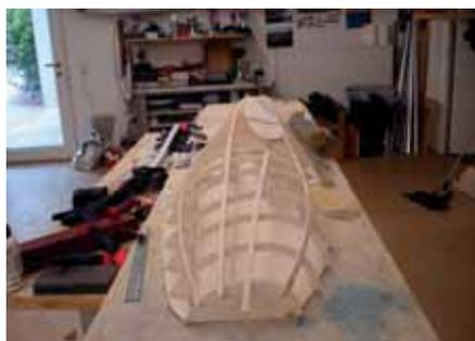
Die Rumpfhälften werden mittels beiliegender Pappelsperholz-Schablone in Halbschalen aufgebaut.
