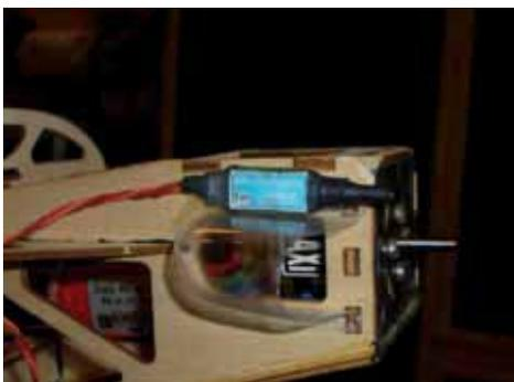
Externer optischer Drehzahlsensor für den Anschluss am UniTest 2, UniLog und JLog2.
