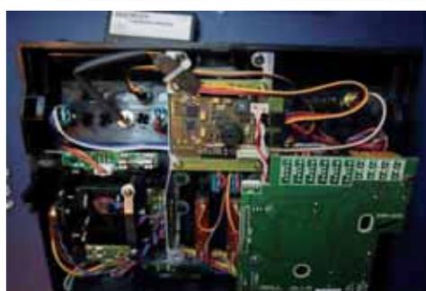
ESD Hinweise beachten, um das HF Modul nicht durch elektrostatische Aufladung zu zerstören. Als Werkzeug sind neben Schraubendreher und Zange auch ein 7mm und 8mm Bohrer und eine kleine Feile notwendig. Lötcolben wird keiner benötigt. Es wird die bestehende HF Platine gegen die neue 2,4GHz Platine getauscht und Taster und Antenne in
