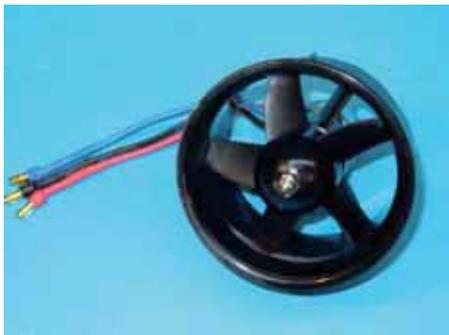
Diesen Impeller eines Saab Draken aus fernöstlicher Produktion gilt es auszuwuchten. Die Unwucht ist so stark, dass der Antrieb im Flug immer wieder aussetzte.
