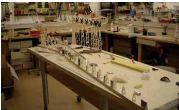
*Verklebung der Rippenvorderteile mit dem Holm und Einsetzen der Nasenleiste auf dem Baubrett.*
