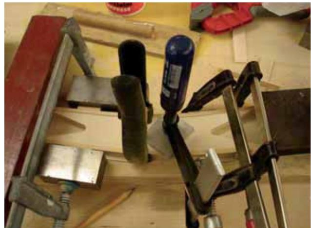
*Einsetzen der Sperrholzverstärkung im Flügelknickbereich.*
