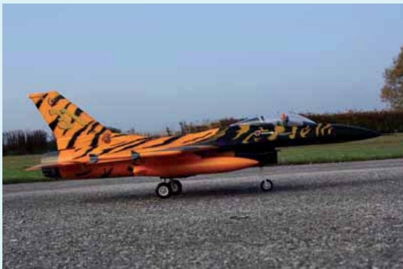
Das Fahrwerk ist robust ausgeführt und für das Rollen auf Asphalt durchaus geeignet. Beim Bugfahrwerk wurde noch 40 Prozent EXPO beigemischt, damit die Korrekturen beim Steuern nicht zu heftig ausfallen.
