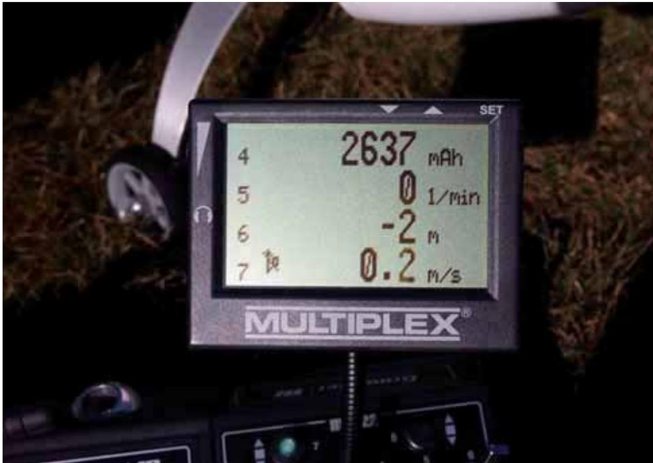
wendung in der Praxis. Über den eingebauten Lautsprecher werden außer dem Varioton auch ALARM Töne wiedergegeben. Ein Anschluss für einen Ohrhörer ist ebenfalls im Display vorhanden. Wie üblich bei Multiplex wird über den MULTIPLEX Launcher ein notwendiges Update von Display und HF Modul vorgenommen. Derzeit ist dies bei den verwendeten Komponenten in der Testanlage der MC22 nicht notwendig.
