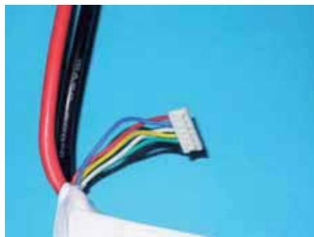
*Als Balancerstecker werden bei den SLS-Akkus die gängigen EHR- Steckersysteme verwendet.*
