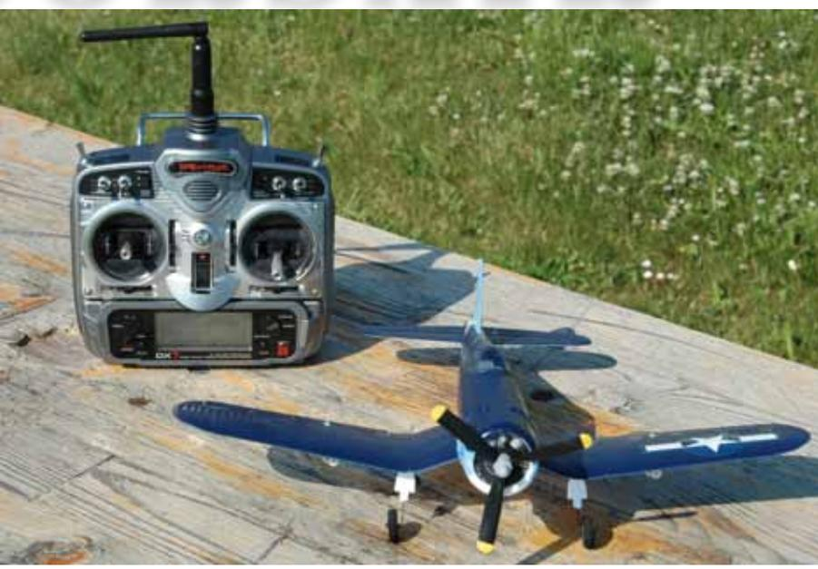
werden Höhen und Seitenruder (incl. lenkbarem Spornrad) und Querruder über je ein zugehöriges Servo. Der 150 mAh-3,7V-12C Lipoakku und ein passendes Ladegerät komplettieren den Lieferumfang.
