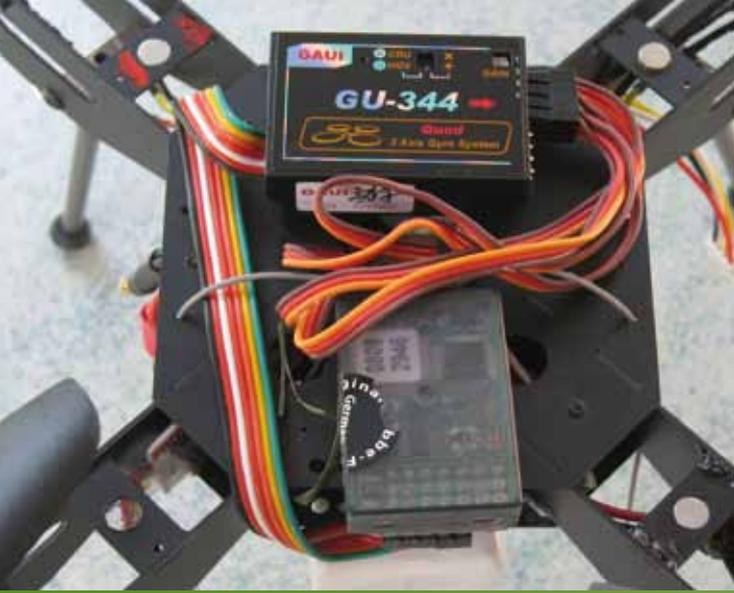
Steuerelektronik und Empfänger
