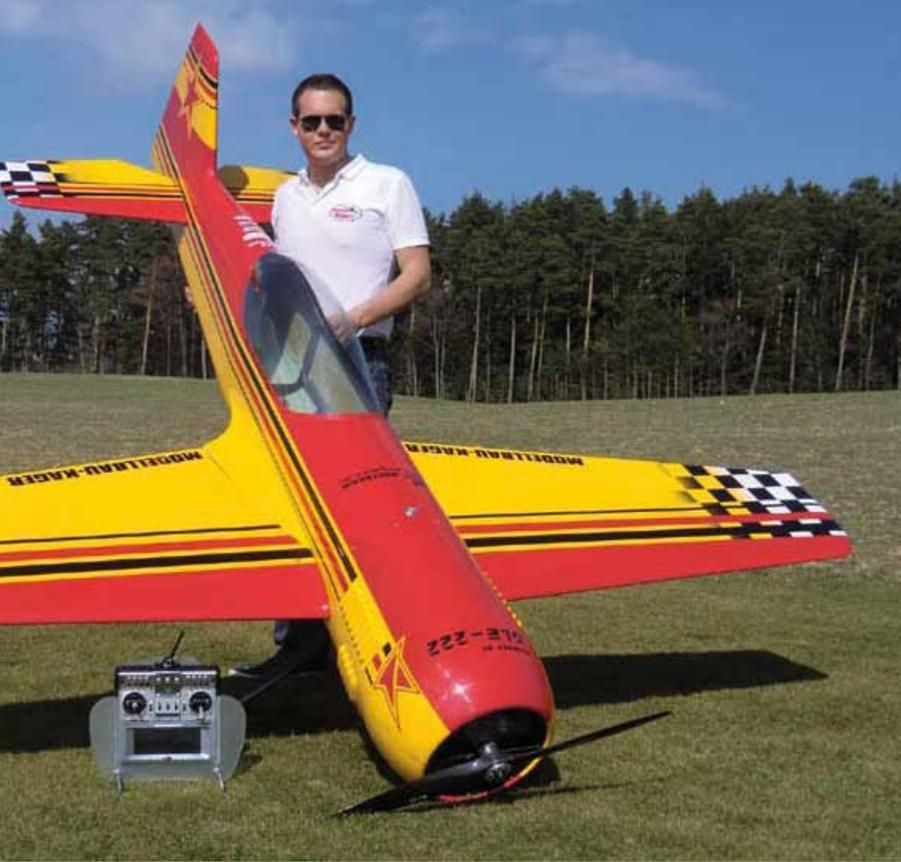
einem viel Zeit für die- und zwischen den Figuren. Das relativ dicke Profil erleichtert das Constant Speed Fliegen ungem. Die Su ist bei Bewerben mit 10% Scalereglement ohne Änderungen einsetzbar. Die Su selbst und der DLE sind angenehm leise.
