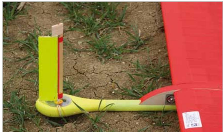
Rumpfkopf mit Magnetsteuerung des F1E-Modells
