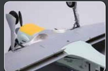
Die Ansteuerung des Einziehfahrwerks erfolgt durch ein Servo, das mittig in der Tragfläche sitzt. Ebenso werden die Landeklappen, die als vorbildgetreue Spreizklappen ausgelegt sind, durch ein zentrales Servo angelenkt.
