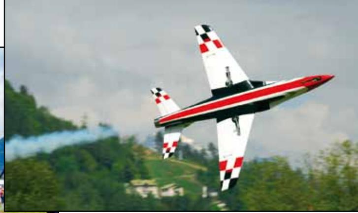
**Futura-Jet von Gernot Bruckmann (19) im Messerflug und am Boden. 2,5 m Spw, 17 kg, 18 kg Schub, 5 l Kerosin für ca. 8 min Flug, Schubvektorsteuerung**
