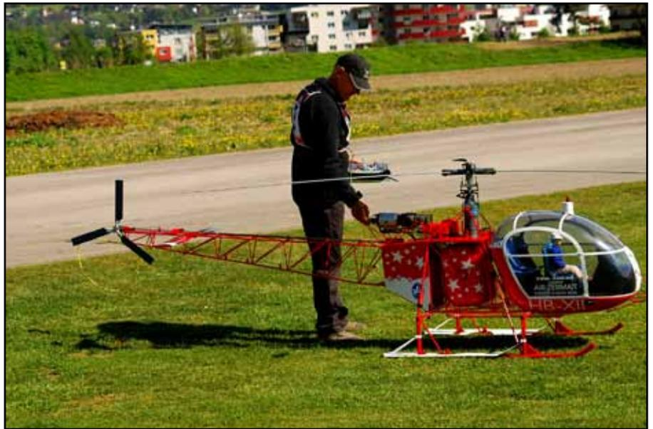
**Hermann Auer (Italien) mit seinem Lama (Rotordurchmesser 3,4m, 24 kg, Zweiwellen Turbine JetCat)**
