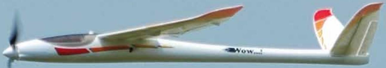
serholme zur Verstärkung. Der Antrieb des WOW erfolgt durch ein gut abgestimmtes LiPo-Brushless-Power-System, das aus einem 3s 11,1V-LiPo-Akku versorgt wird.
