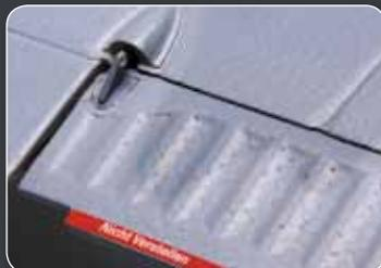
Perfektion bis ins Detail! Die Querruder sind vorbildgetreu profiliert - selbst die Bügelkante an der Querruderhinterkante ist berücksichtigt worden. Die Servoanlenkungen für die Querruder sind optimal verkleidet.
