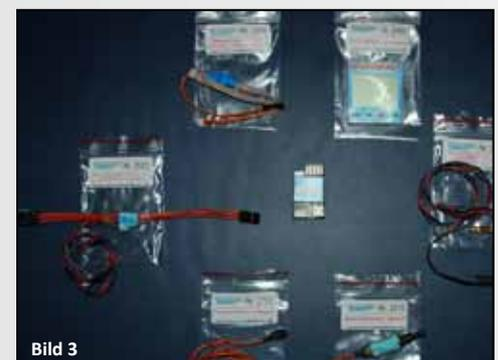
vor allem im Segelmodell von Interesse. Dieser steckbare Strom- und Spannungssensor für die Messung von Spannung und Stromverbrauch der Empfangsanlage, kann sowohl zwischen Akku und Empfänger als auch direkt für ein einzelnes Servo verwendet werden.
