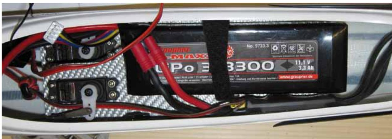
Ausreichend Platz für Servos, Regler und Lipos ist im Rumpf der Alpina E vorhanden. Zur besseren Kühlung des Motors sollten jedoch Lüftungsschlitze im Bereich des Motors angebracht werden.
