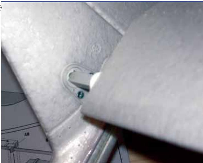
Stromkabel vom Regler zum Motor gut verlegt sind und nicht am Gehäuse des Motors streifen. Ich habe hier mit einem Stück dünner Kohlefaserplatte die Kabel vom Motorgehäuse geschützt.
