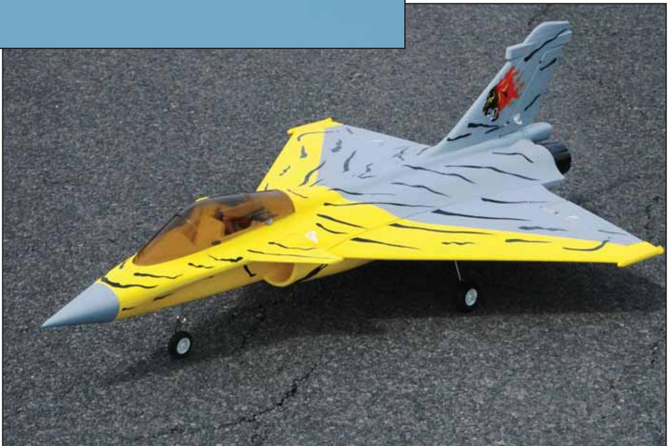
rung des Modells erfolgt über sogenannte Elevons. Diese werden über 2 bereits eingebaute Servos der 11mm Klasse angesteuert. Der Sender muss über einen elektronischen Deltamix verfügen. Das Seitenruder wird in Verbindung mit dem Bugfahrwerk über ein weiteres bereits montiertes Servo angelenkt. Zum Betrieb des
