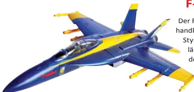
Der F-18 Nano-Jet von robbe ist ein handliches Modell in geschäumter Styro-Leichtbauweise. Das Modell lässt sich leicht und sicher aus der Hand starten. Dabei erzeugt der 5-Blatt Impeller einen guten Schub, um das nur 350g leichte Modell schnell und sicher auf Höhe zu fliegen.
