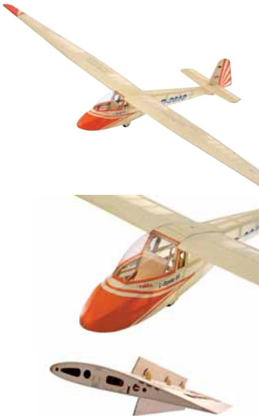
*Fertig montierte, dem Original angelehnte, nach oben- und unten ausfahrbare Störklappen.*
