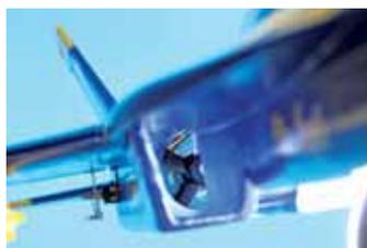
Die besonderen Konstruktionsmerkmale der F-18 sind Ihre Strakes. Hier wird der Tragflügel an der Rumpfseite stark nach vorne gezogen und gepfeilt. Aufgrund dieser Flächengeometrie lassen sich sehr enge Flug-
