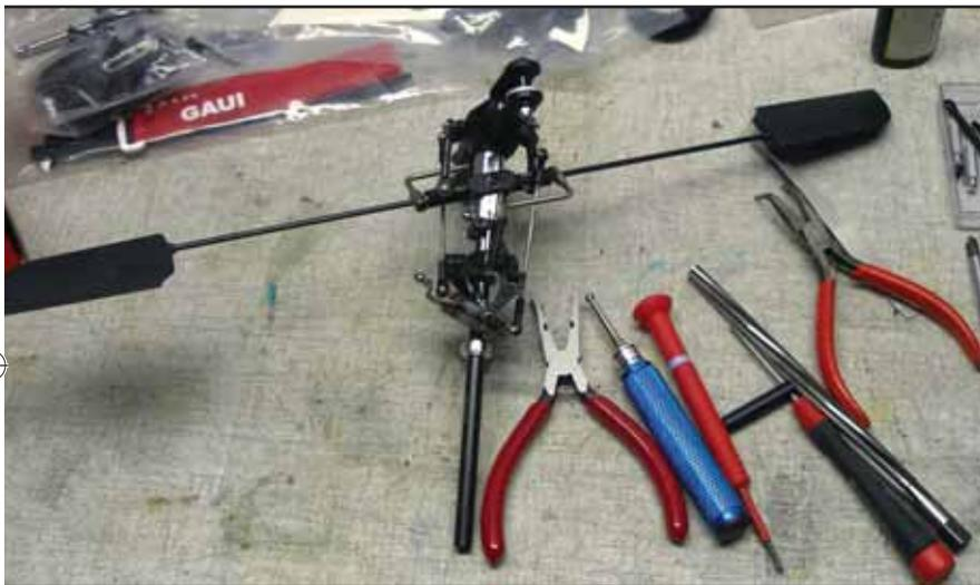
*der vormontierte Rotorkopf*
