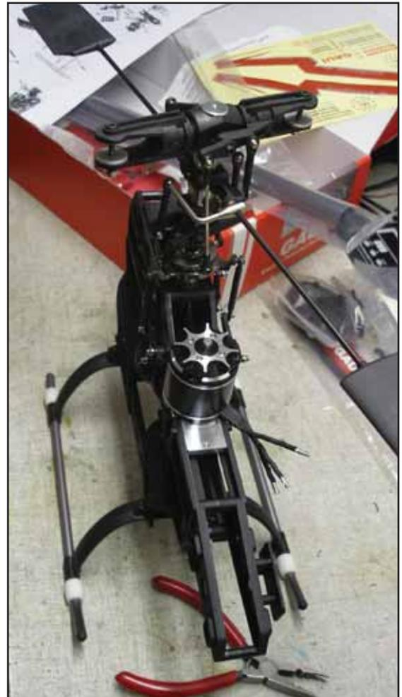
*Der Motor und der eingebaute Rotorkopf des Hurricane*
