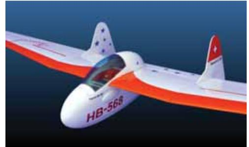
**Flash 2** ist ein Power-Jet der Superlative, für den erfahrenen und anspruchsvollen Elektrojet-Piloten, ein Eye-Catcher auf jedem Modellflugplatz. Der Antrieb ist für einen 90mm-Impeller ausgelegt, bestens geeignet Turbofan 2000NG. Rumpf und Motorgondel sind aus Voll-GfK. Bei Verwendung des neuen Einziefahrwerkes 7358/52 ist dieses Modell Bodenstarttauglich. Der Rumpf ist wahlweise in den Farben weiß und rot erhältlich.
