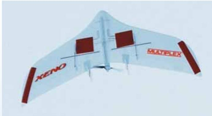
*Es geht auch senkrecht nach Oben! Zur besseren Erkennung der Fluglage im grauem Winterhimmel wurde das Modell auf der Unterseite mit roten Klebestreifen versehen*
