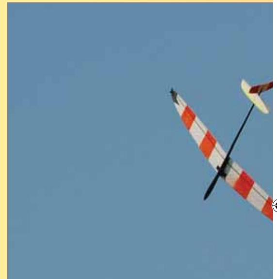
tung für einen HLG der recht stabil gebaut ist. Der Schwerpunkt liegt wie im Bauplan angegeben bei 81 mm. Wie sich später herausstellt ist eine Schwerpunktklage von 78 mm die weitaus bessere Lösung!
