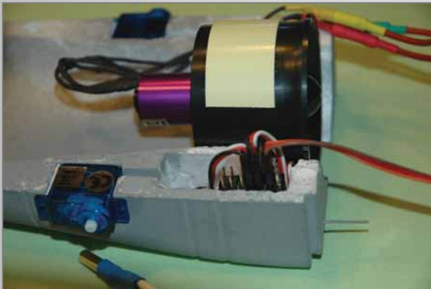
saugen kann. Die Steuerung des Brushless-Motors erfolgt über einen speziellen Brushless-Regler, der bereits im Lieferumfang des Modells enthalten ist. Die Impellereinheit ist ausgelegt für dreizellige LiPo-Akkus mit 11,1V. Über
