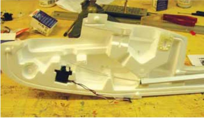
*Servos und Bowdenzüge werden bereits vor dem Zusammenbau der Rumpfhälften eingeklebt*
