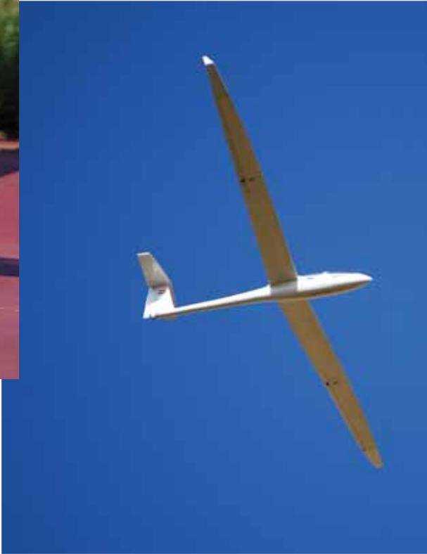
Seitenruderausschlag auf beide Seiten. Mit dem originalen Bowdenzug leider nicht ganz möglich. Als letzte Tuningvariante habe ich noch Zackenband auf etwa 1/3 der Flügellänge von außen her aufgeklebt. Der Rest ist dann nur mehr Kabinenhaube zusammenkleben, Ruder anschlagen und RC Einbau.
