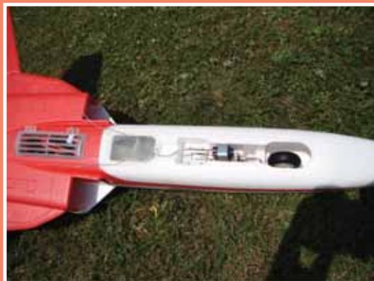
Das lenkbare Bugfahrwerk
