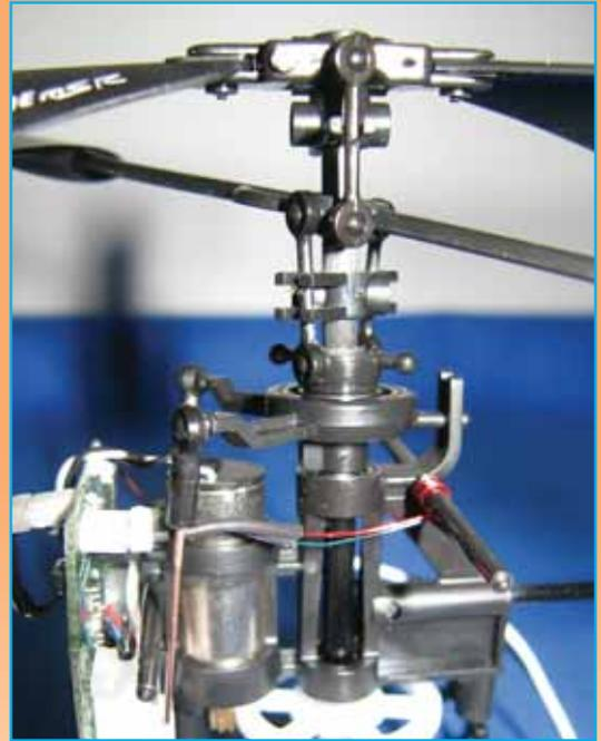
Rotorkopf und Anlenkung der Taumelscheibe
