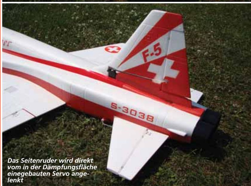
*Das Seitenruder wird direkt vom in der Dämpfungsfäche eingebaute Servo angelenkt*
