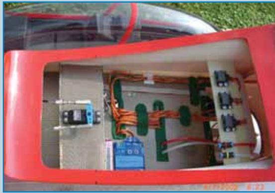
*Unterseite mit Wabenplatte und Anschlußstecker für Fläche Beleuchtungsmodul und Bugfahrwerksservo*
