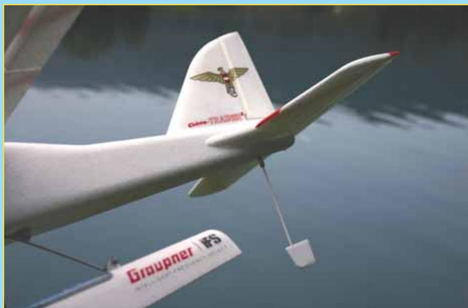
Zweibeinwerk und Spornradbügel einfach austauschbar gegen Schwimmerset und Wasserruder
