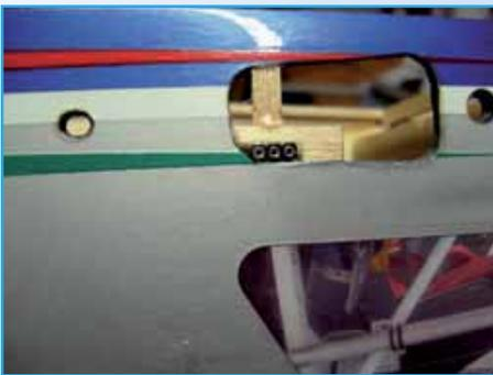
Nach Empfängereinbau geht's ans Auswiegen. Dabei nicht nur den Schwerpunkt betrachten, sondern auch um die Längsachse auswiegen. Dazu montiere ich den Propeller ab und hebe das Modell vorne am Luftschraubenmitnehmer hoch. Nachdem es hinten am Spornrad mittig steht ist das Auswiegen fürs Erste ausreichend genau. Gegebenenfalls mit Ausgleichsmasse korrigieren.
