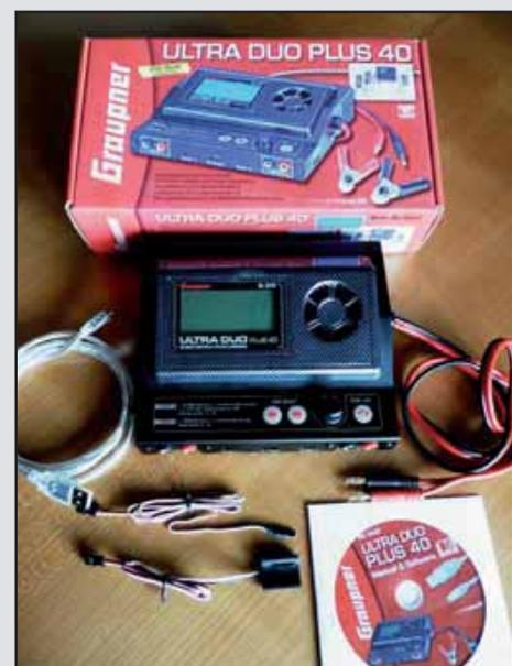
Lieferumfang: 12V Ladegerät mit CD incl. Bedienungsanleitung + Software, USB Kabel und 2 Thermofühler
