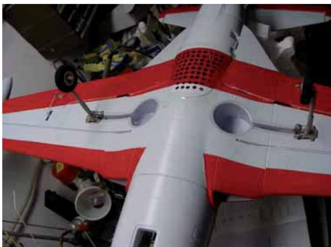
*Das bereits eingebaute Hauptfahrwerk sieht gut aus und funktioniert, ist aber in der Fläche zu schwach befestigt. Ein Umbau auf großflächigere Fahrwerksträger lohnt sich auf Dauer!*
