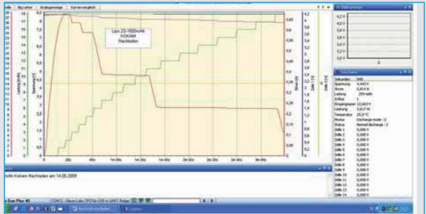
Ausdruck Ladekurve mit Beschreibung „Typisches Ladediagramm aus der Software LogView eines 2S Lipo 1500mAh Nachladen“ Bild LogView 2S-1500mAh Kokam
