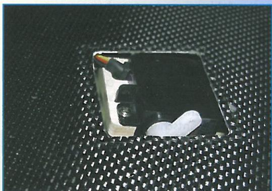
10,8 mm Servodicke und nicht mehr... einfacher als ein Servorahmen ist Schrumpfschlauch und einkleben
