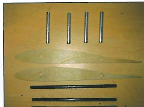
Größe getauscht, da die originalen Ruder bei Betätigung über die Länge eine große Verformung zeigten.
