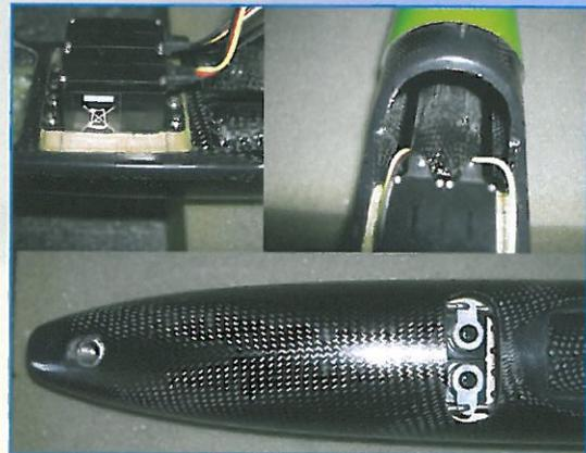
Die Leitwerkeservos wurden auf den Kopf gestellt, die Schubstangen seitlich am Ballastrohr entlanggeführt und eine „Serviceöffnung“ ausgefräst. In der Rumpfspitze ist die Aufnahme für den „Flitschenhaken“ erkennbar
