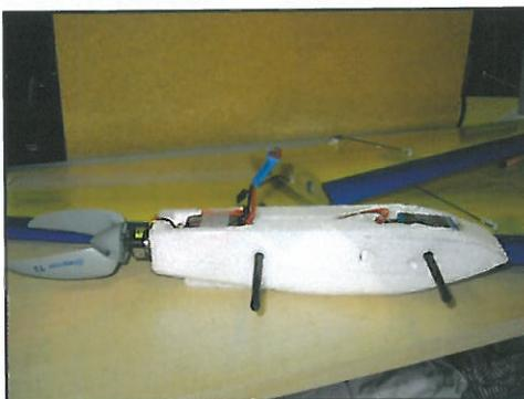
Der Rumpf wurde aus Abfallmaterial (EPP) hergestellt. Die Winglets aus Depron müssen abnehmbar sein, deshalb wurde als Befestigung je 2x 4 mm Kunststoffschrauben in den Flächenabschluss eingedreht und
