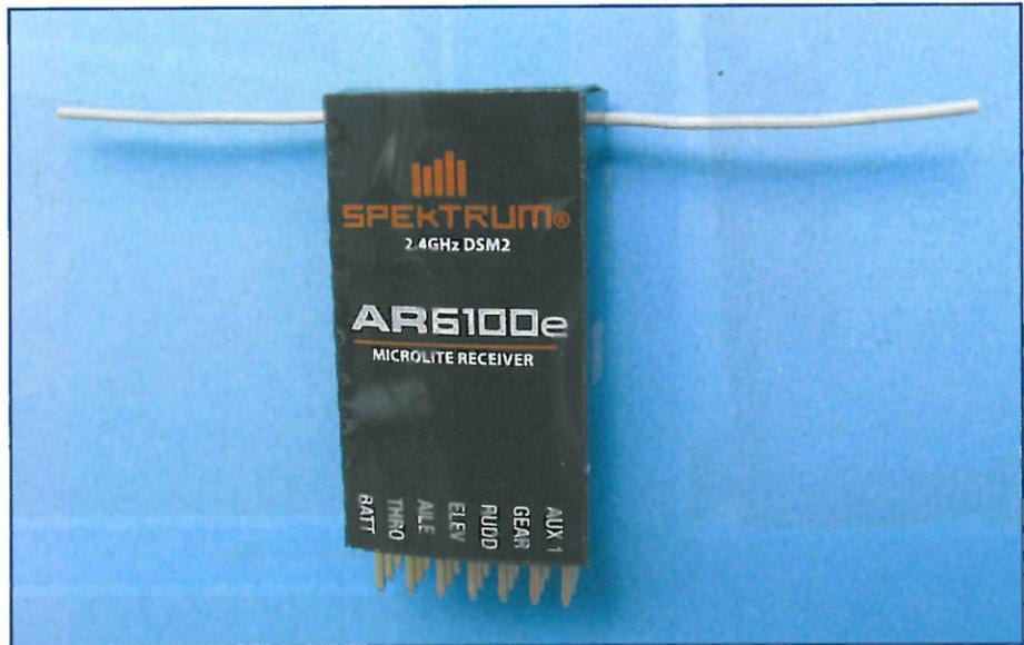
Die Reichweite des AR 6100 mit Stummelantenne unterscheidet sich nicht von den getesteten Satellit-Empfängern.
