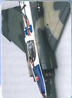
Die obere Rumpfabdeckung aus Kunststoff kann bei der F-4 mit einem Handgriff abgenommen werden. So gelangt man problemlos an die Elektronik-Komponenten des Modells.
