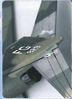
Die Steuerung des Modells erfolgt über Elevons. Dabei werden die beiden Höhenruderflächen einzeln von jeweils einem Servo angelenkt und im Sender elektronisch gemischt.
