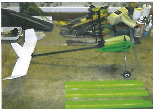
Schlitz in das CFK-Rohr gefräst und ein kleines CFK-Plättchen als Sporn eingeklebt.
