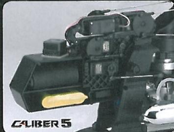
Im vorderen Teil der Mechanik befindet sich die RC-Box, in der der Empfänger und der Akku gelagert werden. Serienmäßig ist der Caliber 5 mit einer mechanischen Taumelscheibenmischung ausgestattet. Diese kann optional gegen eine elektronische Mischung umgebaut werden (Umbausatz CA-5140 erforderlich).
