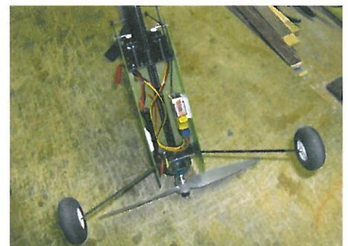
Motorspant und Servobrett mit der Aufnahme für den CFK-Rotormast und CFK-Heckausleger bestehen aus Kunststoff und wurden, wie übrigens alle anderen Teile auch, mittels Sekundenkleber verklebt. Hier hat sich ein mitteldickflüssiger Kleber mit Aktivator sehr bewährt. Im zweiteiligen Motorspant sind das Stahldrahtfahrwerk und Montage-muttern für den E-Antrieb gelagert. Ins Servobrett passen die vorgeschlagenen Hitec HS-55 Servos etwas streng „saugend“. Der Rotorkopf
