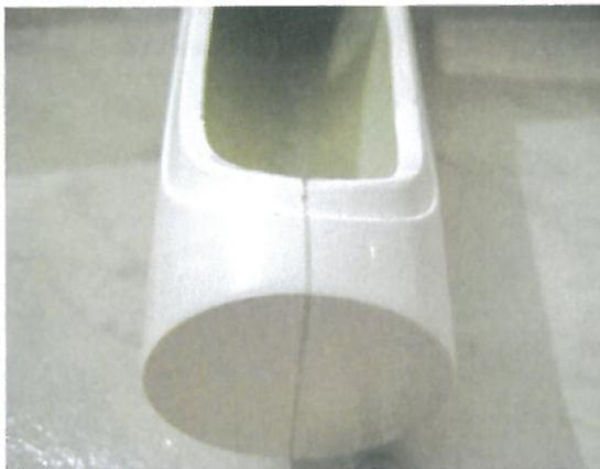
ausgezeichneter Qualität, auch hier muss nichts mehr geschliffen werden. Auffällig ist, dass die Trennnaht nicht in der Mitte ist. Hier darf man sich später beim Ausrichten der Tragfläche nicht irritieren lassen. Der Rumpf hat eine Ausnehmung für den Motoreinbau, für die RC-Ausrüstung und am Heck aufgesetzte
