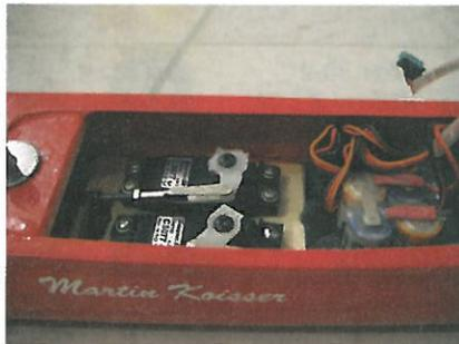
schieht mittels CFK Rohr mit eingearztem M3 Gewinde an beiden Enden und Gabelköpfen. Somit ist die Anlenkung spielfrei. Die Motordrossel habe ich mittels Bowdenzug realisiert. Servoseitig mit Gabelkopf und motorseitig mit einem Kugelkopf (schlechte Erfahrung mit Knackimpulsen am Vergaser mit Gabelkopf). Die beiliegende CFK Kabinenhaube kann jetzt noch ausgeschnitten und angepasst werden.
