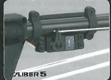
Das Heckrotorservo wird klassisch in einer Kunststoff-Halterung am Heckrohr montiert. Die Anlenkung des Heckrotors ist absolut spielfrei ausgeführt. Dadurch kann die Empfindlichkeit am Gyro besonders hoch eingestellt werden, um die maximale Stabilisierung des Hecks zu erzielen.
