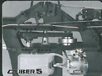
Das neuentwickelte Doppelkammer-Tanksystem versorgt den Motor zuverlässig mit Treibstoff in jeder Fluglage. Durch den Zahnrücken in der ersten Getriebestufe, ist der Motor mechanisch vom Getriebe entkoppelt. So beeindruckt der Caliber 5 in der Luft durch minimale Geräuscherwicklung bei maximaler Performance!
