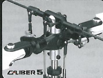
Der hochwertige Voll-Metallrotorkopf verfügt über eine durchgehende Blattlagerwelle, die in zwei Schlagdämpfergummis gelagert ist. Das Schwenkzentrum der Blattlagerwelle ist durch einen Zentrierstift klar definiert. Die Alu-Blattgriffe können Blätter bis 12 mm Blattanschluss aufnehmen.
