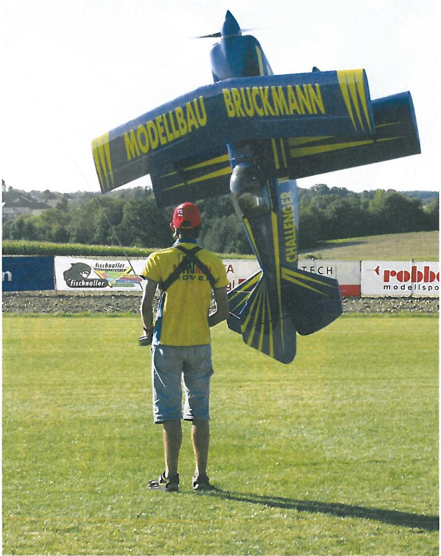
Bruckmann mit Challenger2 268 cm Spannweite, 24 kg Gewicht, 212 ccm Motor
