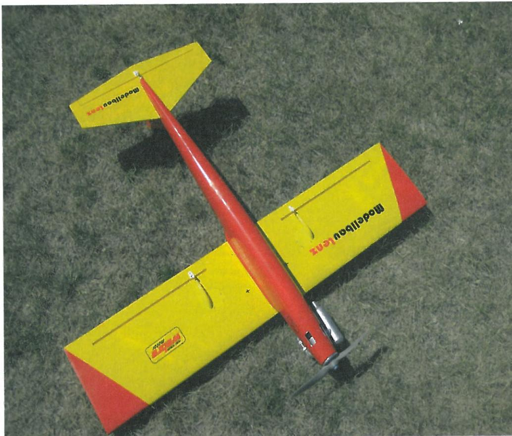
Die Öffnungen für die Servos sind schon herausgearbeitet und eine Durchführung für die Servokabel ist auch vorhanden. Ebenso sind die Ruder und Leitwerke bespann- oder lackierfertig verschliffen. Scheinbar wurde besonders auf die Richtung der Maserung des Seitenleitwerkes geachtet.
