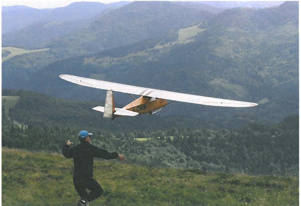
*Grunau-Baby mit 5m Spannweite*
