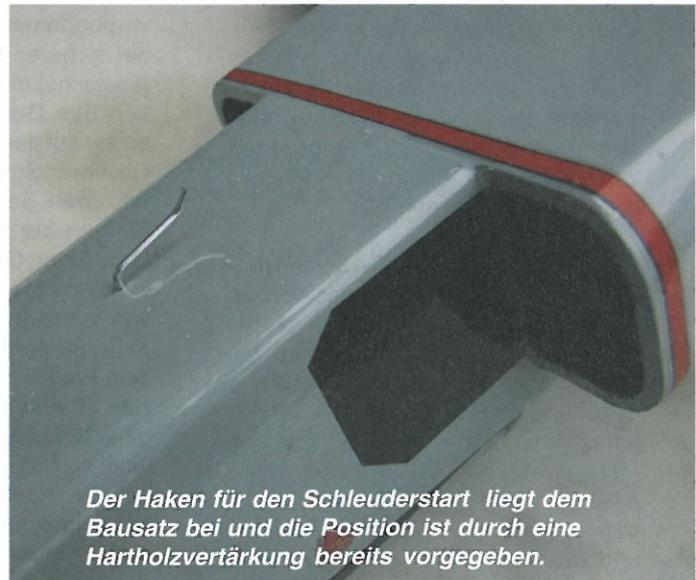
*Der Haken für den Schleuderstart liegt dem Bausatz bei und die Position ist durch eine Hartholzvertärkung bereits vorgegeben.*
