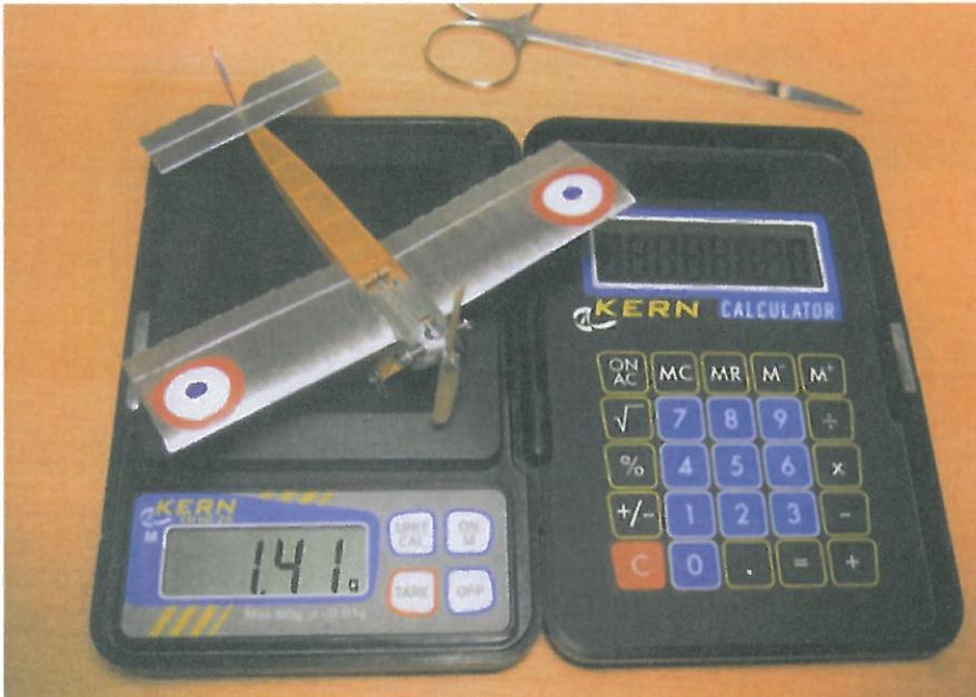
Einzelteile der Zelle bestehen durchwegs aus Balsaholz, wobei die Abmessungen und Querschnitte jenen aktueller Saalflugmodelle gleichen. Die Motorverkleidung besteht aus dünnem Aluminiumblech, das über eine Positivform getrieben wurde. Die Luftschraube ist aus einem Stück Lindenholz herausgearbeitet.
