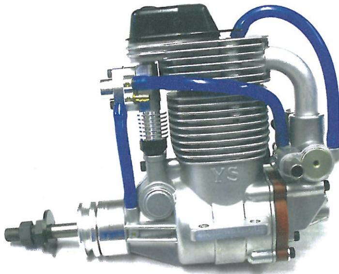
Der komprimierte Treibstoff wird zur Düsennadel im Vergasergehäuse geleitet, wo mit der Düsennadel die korrekte Einspritzmenge nur für die Vollgaseinstellung reguliert wird. Der Vergaser presst nur Luft in den Ansaugkanal, also kein fertig aufbereitetes Gemisch. Der Treibstoff wird über eine im Zylinderkopf sitzende Einspritzdüse, eingespritzt.
