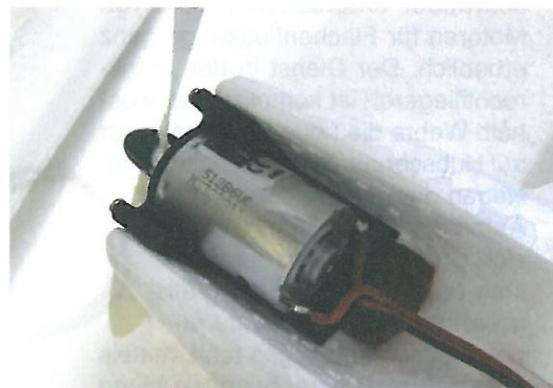
Motoreinbau einfach mit Klettbändern
