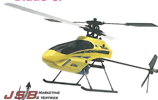
Mit dem Hubschrauber Blade CP bringt E-Flite einen Elektrohubschrauber mit kollektiver Blattverstellung auf den Markt. Der Hubschrauber hat einen Rotordurchmesser von 527 Millimeter und ein Abfluggewicht von 325 Gramm. Er ist mit zwei Elektronikbausteinen, inklu-
