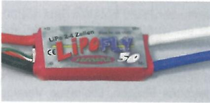
Der **LiPo-Fly 50** ist ein Speedregler für Elektromotoren mit Bürsten.
