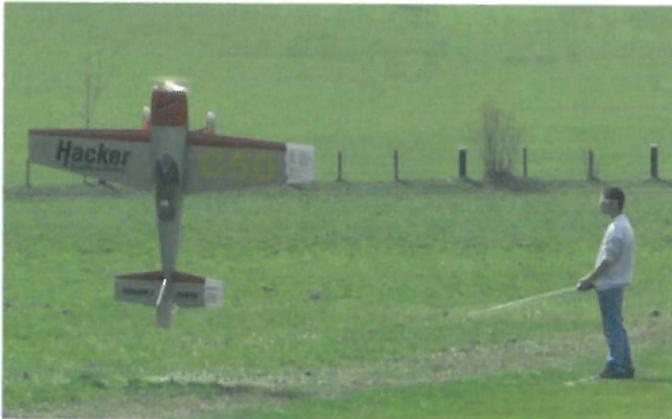
**Der Helipilot Markus Rummer aus Nürnberg zeigte die wahrscheinlich europaweit einzige elektrische 2Mot Kunstflugmaschine, eine Extra 330L mit einer Spannweite von 2,6m. Gespeist werden die zwei C 50 Motoren, die per Zahnriemen verbunden sind, aus einem Lipo Paket, das 10S6P geschaltet ist.**
