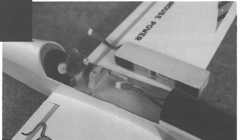
Akkualterung mit Riegel aus Holz.
