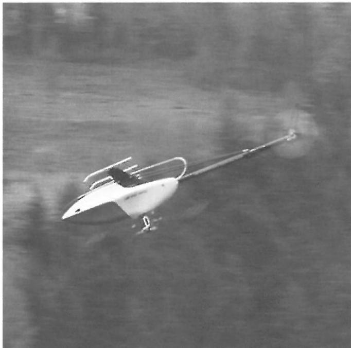
stems. Dazu darf die Rotorkreisflächenbelastung ein bestimmtes Maß nicht überschreiten, was man trotz stabiler Bauweise nur durch Weglassen von überflüssigen Teilen erreicht. Kompakt und übersichtlich ist der MP geworden und er lässt sich in kürzester Zeit in alle Ein-
