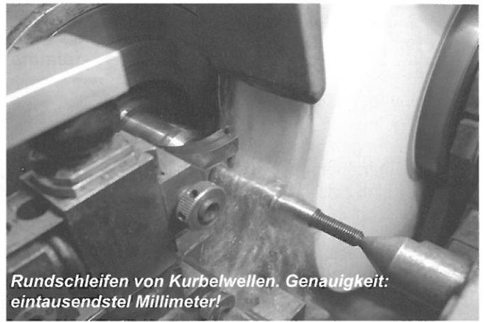
*Rundsleifen von Kurbelwellen. Genauigkeit: eintausendstel Millimeter!*
