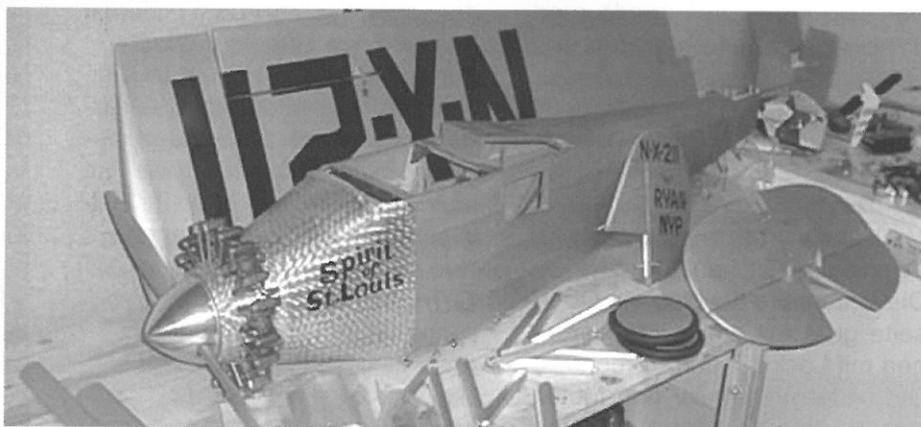
**Flügel, Rumpf und Leitwerke sind bereits fertig bespannt mit grauer Oracover Folie. Alle Beschriftungen sind aufgebracht. Ein besonderer Leckerbissen ist die 9-Zylinder Sternmotor-**
