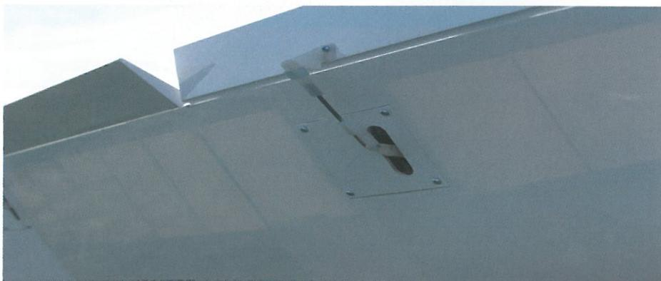
**Vier Servos in den Flügeln ermöglichen eine Fülle von Stellungsmöglichkeiten, vom „Wiesenschleicher“ bis zum „Hangflitzer“s ist alles möglich**
