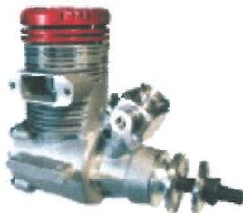
Für F3A Kunstflug- und Großmodelle, ausgelegt für Seitenauspuffanlagen bzw. Resonanzrohrbetrieb. Hohe Laufkultur durch Webra AAR\*) Zylinderlaufgarnitur. Die integrierte Kraftstoffpumpe mit Membransystem versorgt konstant den Vergaser und ermöglicht dadurch den Tank in die Schwerpunktmitte des Modells zu verlegen.
