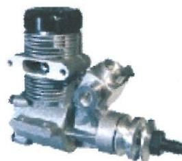
Der AirCombat Motor für die 4 ccm Klasse. Leistungsstark, bei gleichzeitig sehr geringem Gewicht. Ausgestattet mit zweifacher Kugellagerung, einer robusten 1/4" Kurbelwelle und der bewährten Webra ABN\*) Zylinderlaufgarnitur geben diesem Motor den ultimativen Leistungsschub. Der empfohlene Webra Zweikammer-Schalldämpfer (Best.Nr. 1100/32B) sorgt für geringe Lärmmissionen ohne wesentlichen Leistungsverlust.
