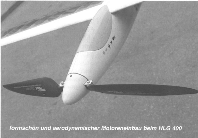
formschön und aerodynamischer Motoreinbau beim HLG 400
