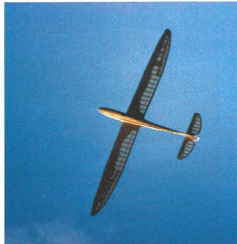
ein Futaba 3001 für Schleppkupplung und Störklappen, die übrigens eingebaut sind, weiteren ca. 300 Gramm Blei in der Rumpfspitze sowie Landekufe mit Landerad, die Kabine etwas ausgebaut und mit Pilot versehen, war ich über das erreichte Endgewicht von **4600 Gramm** positiv überrascht. Das ergibt eine ungefähre Flächenbelastung von **46 Gramm/dm<sup>2</sup>!**
