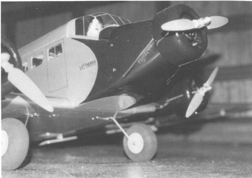
der Akkurutsche ins Freie und zerstörte nur den Kabinenhaubenrahmen. Das Ergebnis waren 2 verbogene Motorwellen und ein "verbeultes" Rumpfvorderteil. Dank dem Sekundenkleber konnte alles wieder in wenigen Stunden repariert werden.
