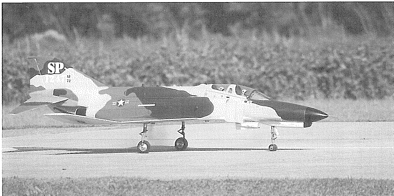
Die imposante Phantom von Sergio Giaretta aus Italien. Diese Eigenkonstruktion im Maßstab 1:7,5 mit einer Spannweite von 1600 mm und einem Gewicht von 12 kg wird durch 2 Gleichauflmpeller angetrieben.
