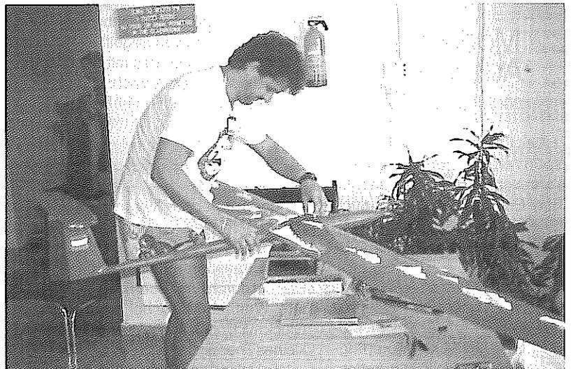
Günther Aichholzer bei der technischen Abnahme der Flugmodelle. Hier die Gewichtskontrolle und Messung des Nasenradius und des Hakenquerschnittes.
