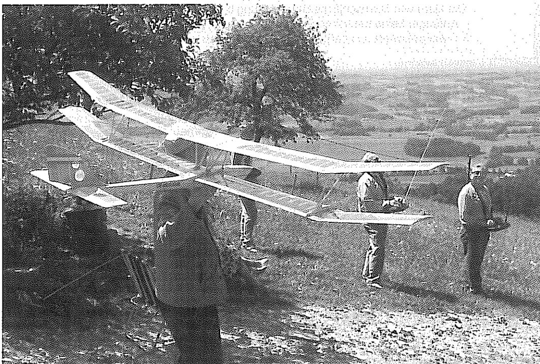
**Ein stattliches Gerät in Leichtbauweise mit Rippenflächen und Kastenrumpf. Die Verstreben und die aerodynamische Beeinflussung der oberen Fläche bestätigte wieder einmal die Tatsache, daß ein Segelflugmodell so widerstandsarm wie nur möglich gebaut sein muß.**
