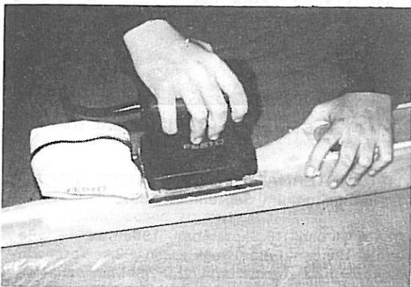
Auch an einer angebrochenen Styroporfläche wollte ich den Rutscher RSM ausprobieren. Nachdem ich in die beschädigte Stelle einen neuen Beplankungsteil eingeharzt hatte, trat der Schleifer in Aktion. Erst mit mittlerem, dann mit feinem Schleifpapier wurden die Übergänge glattgeschliffen. Dabei wurde ohne großen Druck gearbeitet mit gleichmäßiger Geschwindigkeit geführt.
