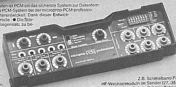
Z.B. Schmalband-FM-Betrieb, HF-Wechselmodul im Sender (27, 35, 40 MHz), Diagnoseverbindung, Lehrer-Schüler-Betrieb und auswechselbare Programmierkassetten für verschiedene Anwendungsvarianten. Zur Zeit sind 3 Programmierkassetten lieferbar (Standardkassette, Universalkassette und Segelflugkassette). Weitere Zusatzbausteine befinden sich in der Entwicklung.
