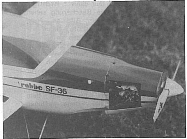
Der Enya-Viertakter verschwindet fast unter der Motorhaube.
