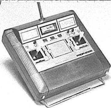
Querrüderdifferenzierung am Sender beim Einbau der Querrüder-Servos (z. B. Pico-Servo) in den Tragflächen. Hier bietet sich die PROF 2000 geradezu an. Denn ihre herausnehmbare Modulkassette ermöglicht es, eine einmal erfliegene optimale Differenzierung auch nach einem Modellwechsel (z. B. Motormodell) wieder genau herzustellen.
