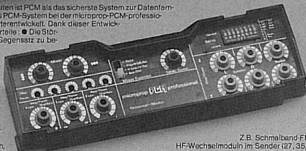
Z.B. Schmalband-FM-Betrieb, HF-Wachselmodul im Sender (27, 35, 40 MHz), Diagnoseverbindung, Lehrer-Schüler-Betrieb und auswechselbare Programmierkassetten für verschiedene Anwendungsvarianten. Zur Zeit sind 3 Programmierkassetten lieferbar (Standardkassette, Universal-kassette und Segelflugkassette). Weitere Zusatzbausteine befinden sich in der Entwicklung.
