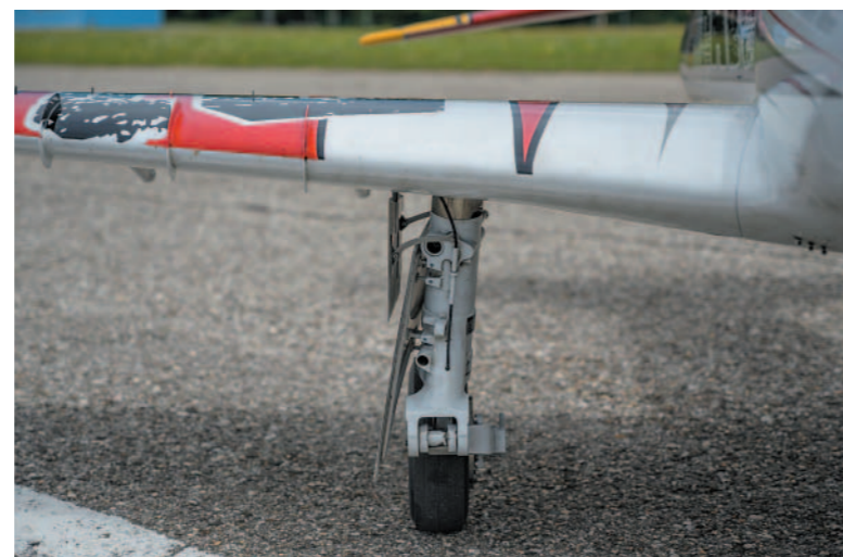
Detailansicht des Hauptfahrwerks, dass ebenso wie das gesamte Modell detailgetreu nachgebildet ist.
