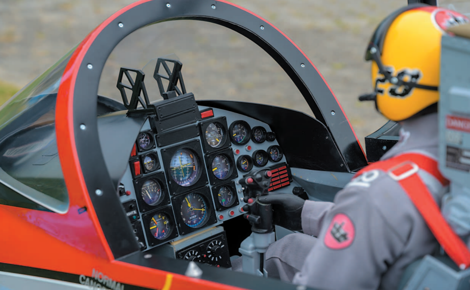
Die Hawk hat überall im Cockpit an den Seitenwänden und Rundbögen Verkleidungen, welche im Baukasten tiefgezogen aus ABC Material geliefert werden. Gottfried Hirscher ist in der Szene bestens bekannt durch seine Baukunst und der unglaublichen Detailtreue bei seinen verschiedensten Projekten. Er hat sich der Gestaltung des Cockpits angenommen und ein wahres Kunstwerk geschaffen.
