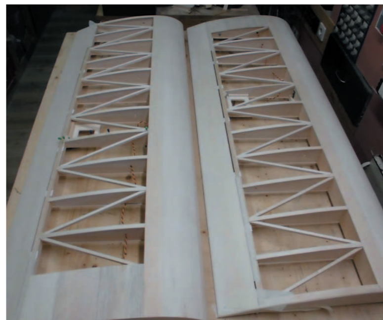
Die Tragfläche ist in herkömmlicher Bauweise mit fünf Millimeter Balsa-Rippen, welche sich in einem Abstand von 120 mm befinden, aufgebaut.
