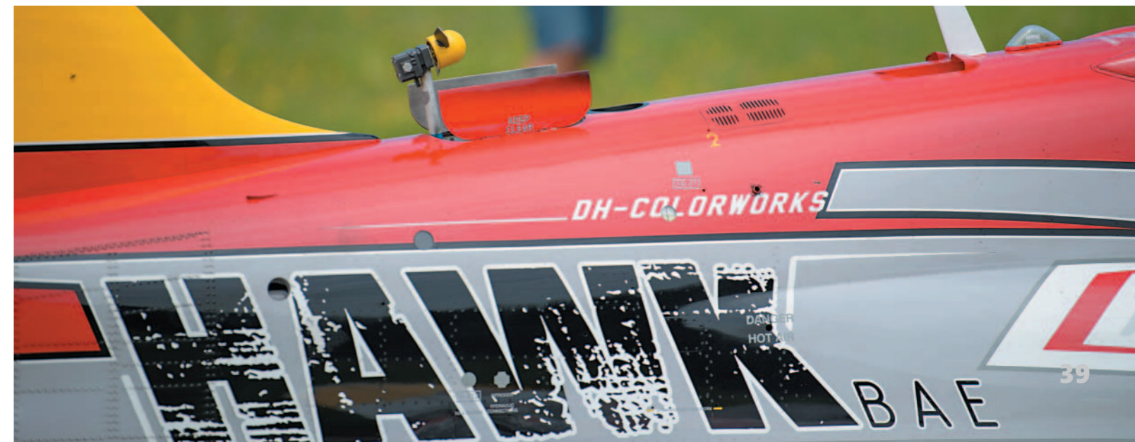
Das kleine Highlight an der Hawk, die elektrifizierte Ram Air Turbine, welche der Autor akribisch nachgebaut hat.
