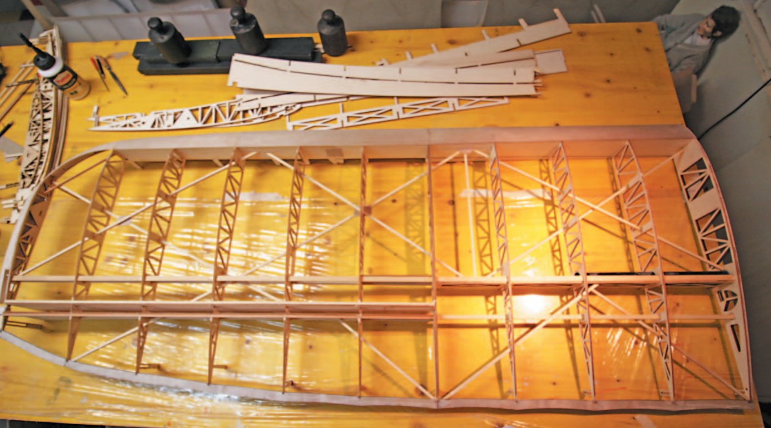
Bau der Tragfläche, eine möglichst einfache, aber stabile Konstruktion. Verwendetes Profil Clark Y; Gewicht der Holzkonstruktion nur knapp über 1.000 Gramm.
