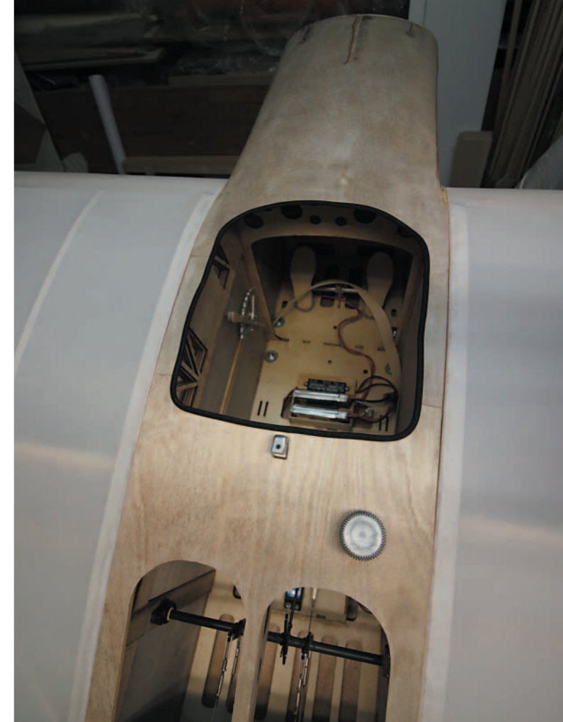
Sicht auf das Cockpit mit der unter dem Sitz versteckten Fernsteuerungsanlage.
