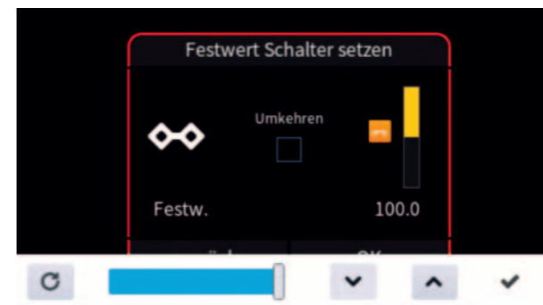
Der Trimm-Stopp kann bei Mittelstellung in der Zeile „Wieder...“ zusätzlich wahlweise an- oder abgestellt werden.
