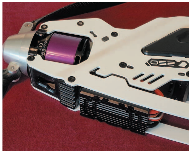
Der Hacker A40-16S V4 Antriebsmotor wird durch den seitlich komplett offenen Rumpf, sehr gut gekühlt. Was den Robbe RO-CONTROL PRO Regler betrifft, so sind seine Kühlrippen ebenfalls komplett im Freien.
