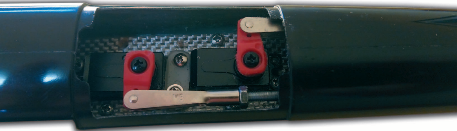
Auf dem selbst angefertigten Servobrett sind die beiden KST x 12-508 Servos hintereinander befestigt. Somit kann das Servobrett mit den Servos sehr leicht aus- und eingebaut werden.
