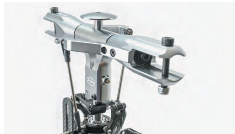
Der Rotorkopf beinhaltet robuste, sandgestrahlte und eloxierte Blatthalter. In dem gleichwertig verarbeiteten Zentralstück ist die neun Millimeter starke Blattlagerwelle gelagert. Auch hier fällt die hohe Passgenauigkeit und Qualität der einzelnen Komponenten auf.
