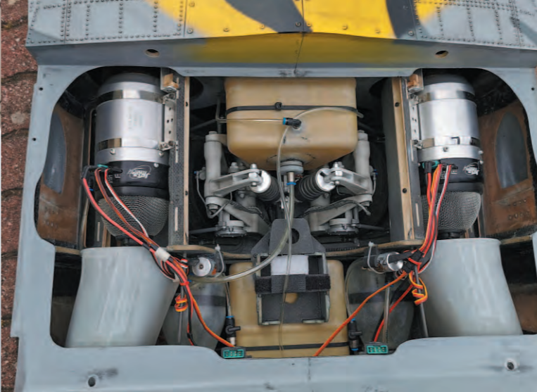
Zwei Jetmuntz VT90BLR Turbinen mit je 90 N Schub sorgen für den Vortrieb des Modells. Diese Motorisierung ist für die Saab mehr als ausreichend, alternativ können auch zwei Turbinen mit 70 N Schub zur Anwendung kommen.
