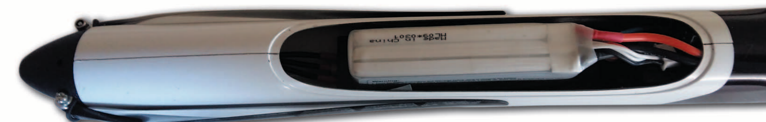
Der Akku ist auf einem Brett platziert, das jederzeit ausgebaut werden kann. Unter dem Brett sind die drei Kabel des E-Motors nach hinten zum Regler verlegt.
