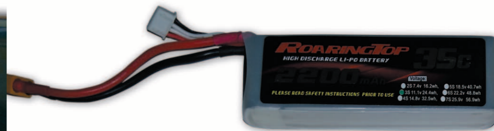
Das Antriebsset bestehend aus dem Tenshock EDF TS-EZ1530 Motor mit einem Micro Edition 5:1N Getriebe, dem Castle Creation Talon 60 YEP 80 A Regler und einem 3s, LiPo 2.200 mAh Akku.
