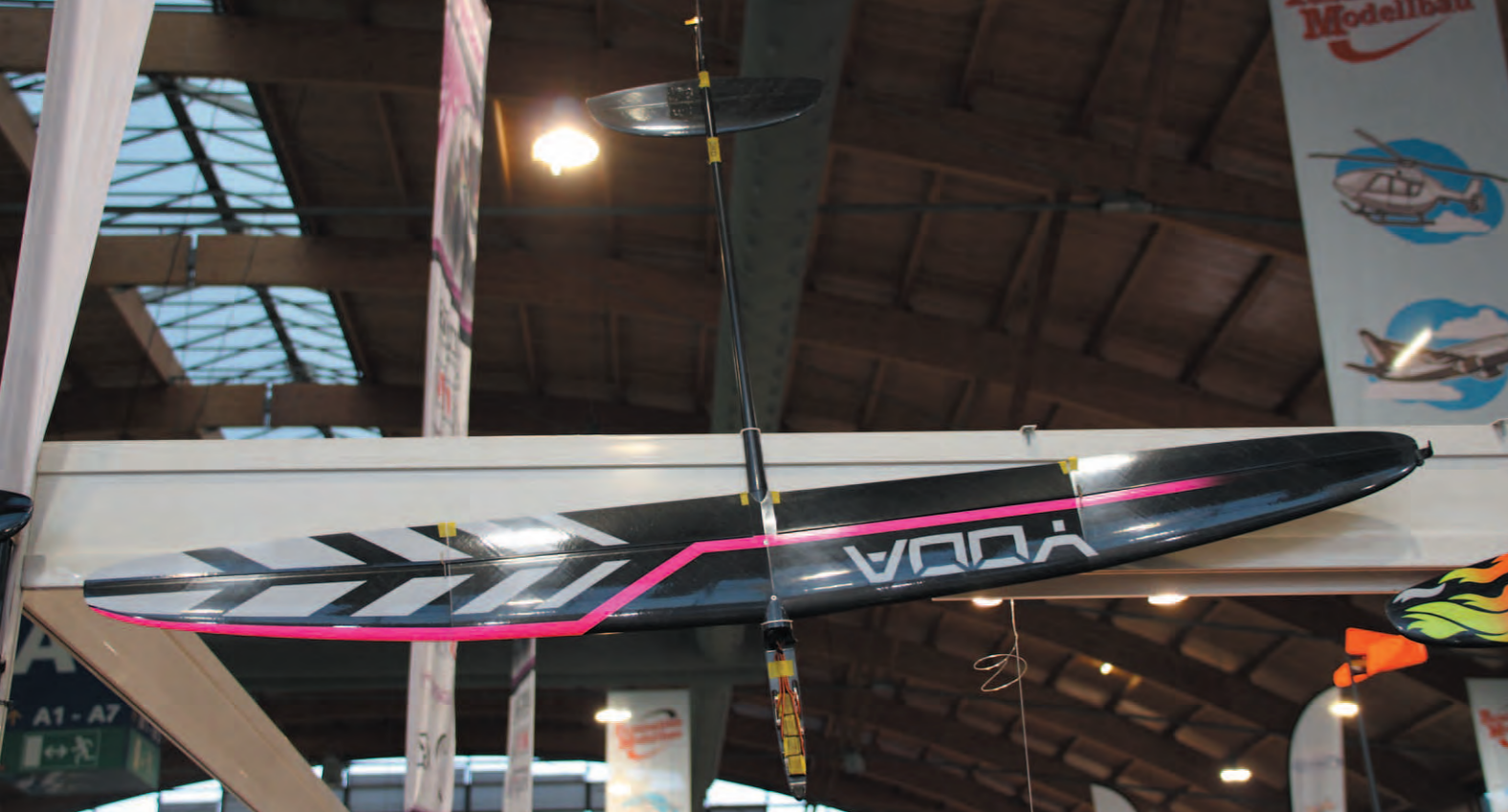
Am Stand von Mahmoudi Modellbau war das F3K- Modell Yoda zu sehen, das eine vollkommene Neukonstruktion darstellt und Optimierungen des Profils, des Gewichts und des Flächen- Rumpfübergangs beinhaltet.
