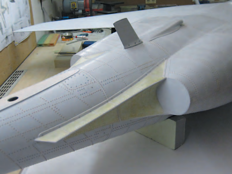
Sämtliche Anformungen, Nietenreihen, Lufthutzen und Wartungsdeckel wurden beim Urmodell berücksichtigt, um eine möglichst hohe Detailtreue zu erreichen.
