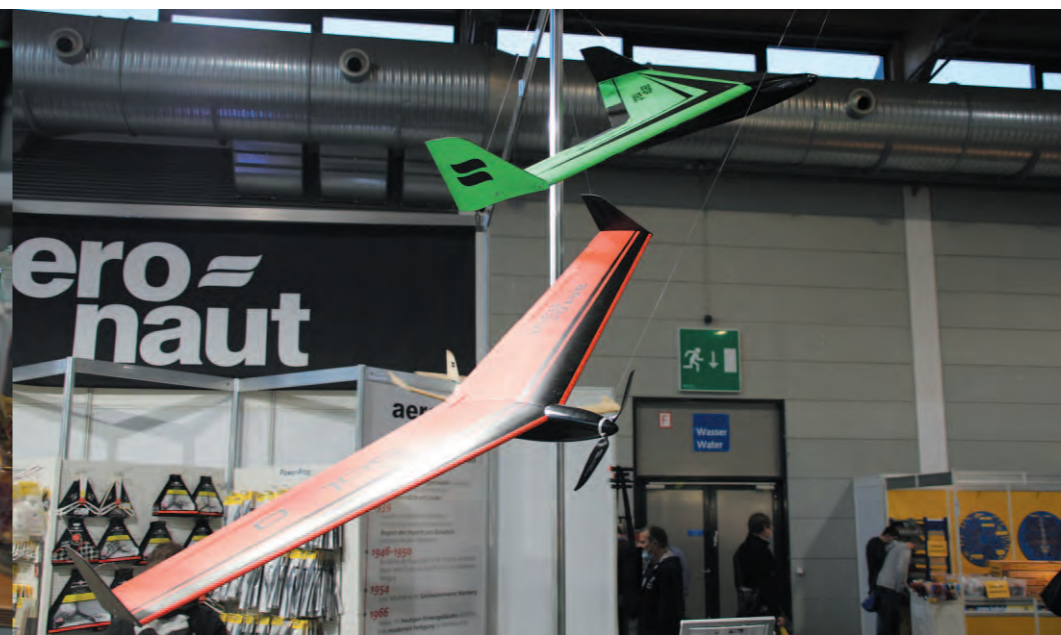
Das Nurflügelmodell Soleo zeichnet sich durch sehr gute Flugeigenschaften aus. Mit einer Spannweite von 1.800 mm besitzt das Modell ein Abfluggewicht mit einem 3s Akku von 1.400 Gramm. Die passenden Antriebssets Eco und Power sind ebenfalls bei der Firma Aeronaut erhältlich.
