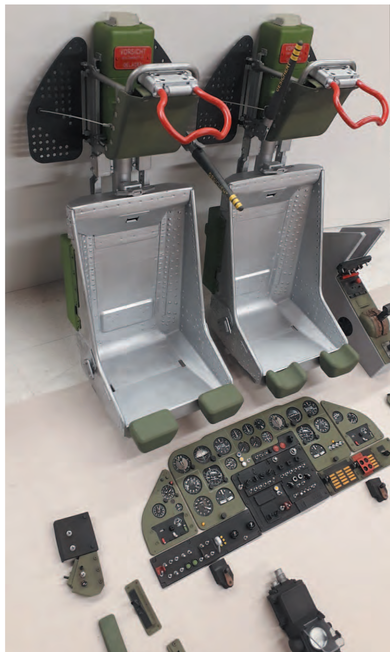
Der Cockpitausbau wurde zuerst mittels CAD erstellt und anschließend mittels des Elegoo Mars Resin Drucker hergestellt.
