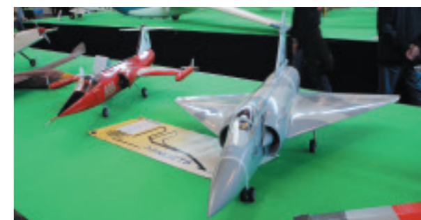
Als Neuheit zeigte die Firma Minijet die Lockheed F-104 Starfighter und die Dassult Mirage 2000C. Beide Modelle können wahlweise mit einem 90 mm Impeller oder Turbine der 20N Klasse angetrieben werden.
