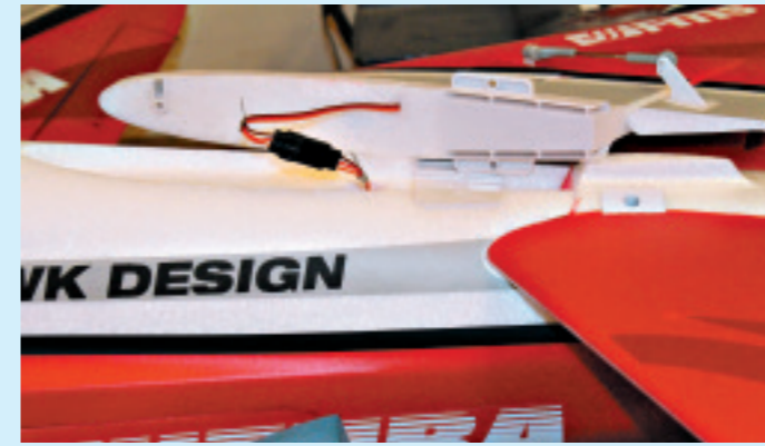
Die Montage des Seitenleitwerks am Rumpf erfolgt auf die gleiche Weise wie jene des Höhenleitwerks.
