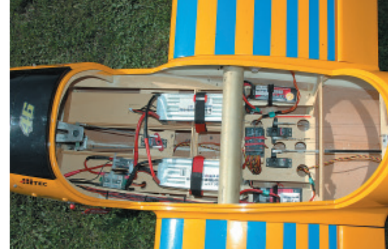
Ein AXI 5345-18 treibt einen Falcon Kohlepropeller 24 x 10 mit 12s-Akkus an, womit sich eine Leistung von etwa 2,5 kW ergibt.
