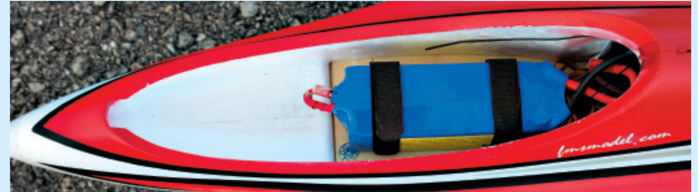
Der Platz unter der Cockpithaube ist sehr großzügig bemessen, sodass der Akku hier leicht Platz findet.
