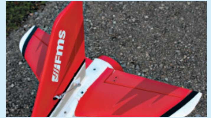
Das Kreuzleitwerk wird einfach mittels drei Millimeter Schrauben am Rumpf befestigt. Die Anlenkungen sind bereits werkseitig soweit vorbereitet, dass selbst die Ruderwege nicht mehr eingestellt werden müssen.
