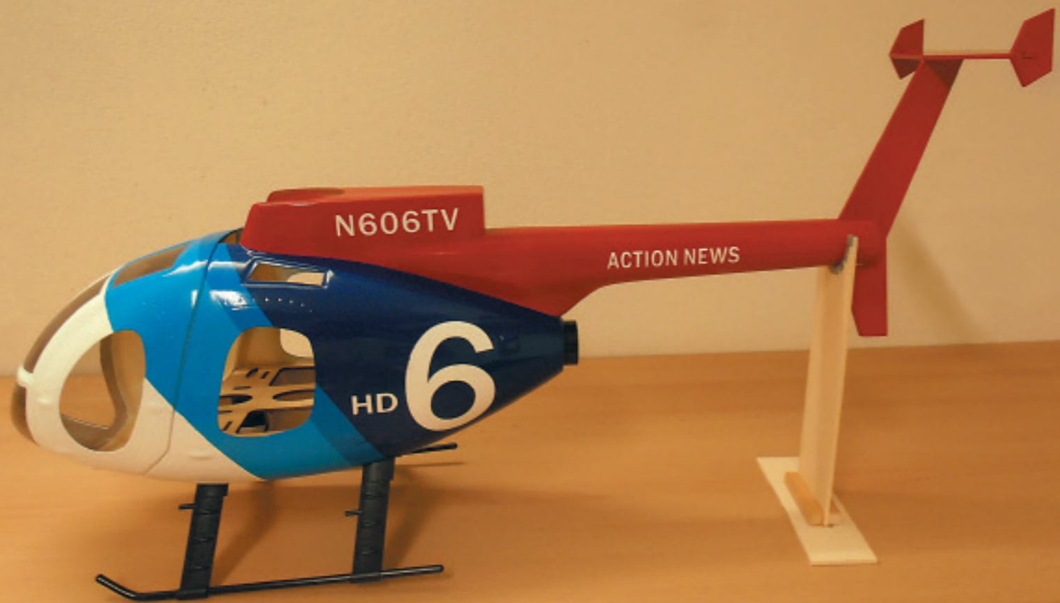
Vor Baubeginn sollte der Rumpf unbedingt in die Waagrechte gebracht werden, um die Durchführungen der Alu-Stäbe genau einwiegen zu können.
