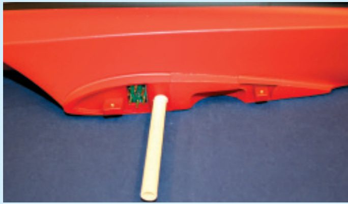
Für eine sichere elektrische Verbindung sorgen Steckkontakte, befestigt wird die Tragflächenhälfte mittels zweier drei Millimeter Schrauben.
