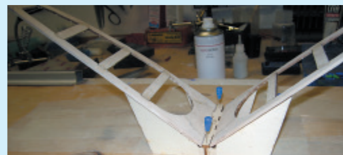
Fertigung des V-Leitwerks
