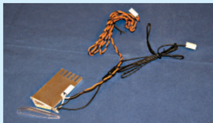
Die neue Generation von kompakten und leistungsstarken Positionsleuchten besitzt einen nach vorne abgewinkelten Aufbau, der eine verbesserte Abstrahlung des Positionslichts und des Blitzlichtes zur Seite ermöglicht.
