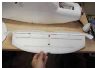
Mehrere Stiftscharniere ergeben leichtgängige Ruder mit hoher Rückstellgenauigkeit.
