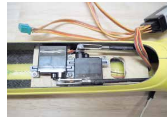
Im E-Rumpf liegen die Servos versetzt, zu beachten sind die notwendigen Kabeldurchführungen im Servobrett.
