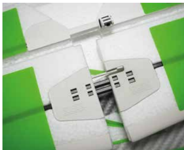
◀▶ Steck-bares Höhenleitwerk mit CFK Holm und Schnappbefestigung.
