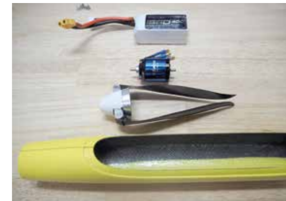
Antriebskomponenten für die E-Version, gut zu sehen die CFK-Verstärkungen um Rumpf.
