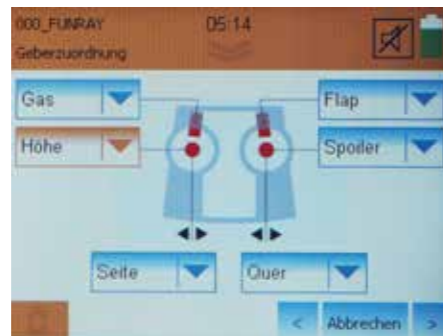
Programmierung der Geberzuordnung jetzt auch für die seitlichen Geber möglich.
