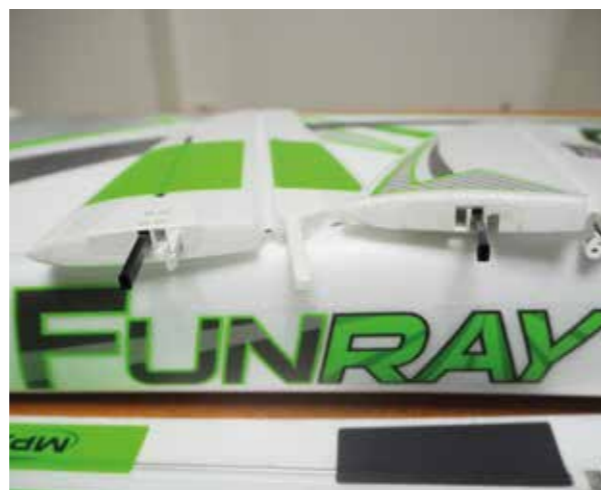
◀▶ Steck-bares Höhenleitwerk mit CFK Holm und Schnappbefestigung.
