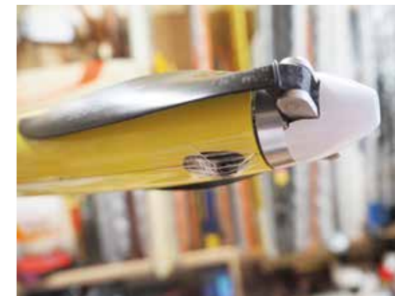
Die relativ steifen Motoranschlüsse benötigen eine Freimachung im unteren Rumpfbereich.
