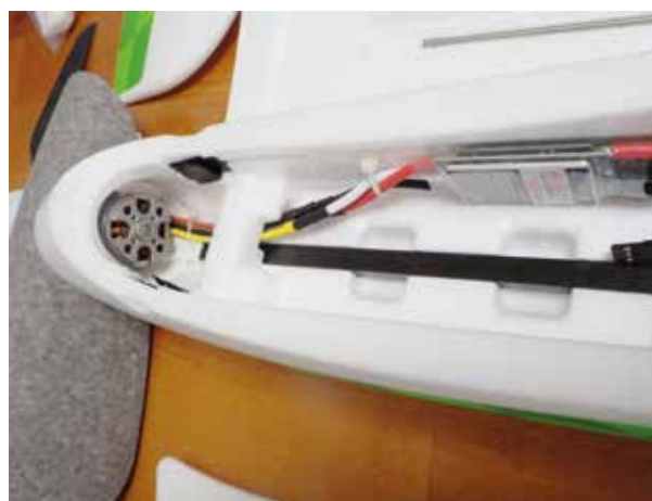
◀ Motor und Regler sind bereits eingebaut man beachte den CFK-Vierkant.
