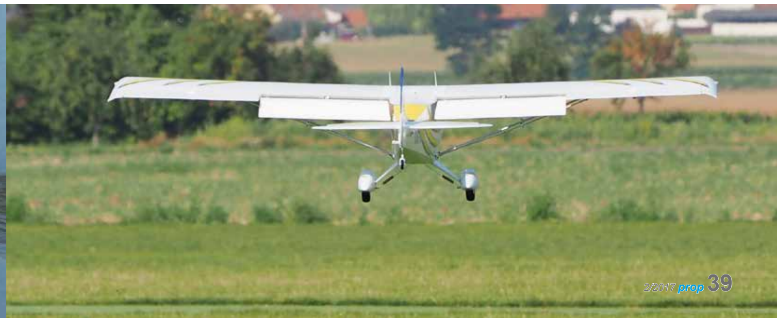
Voll gesetzte Landeklappen für einen kurzen Landeanflug.
