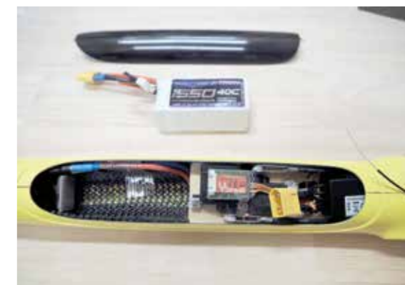
Es geht eng zu aber alles findet seinen Platz, auch des Vario am Servo, der Steller liegt unter dem Servobrett.
