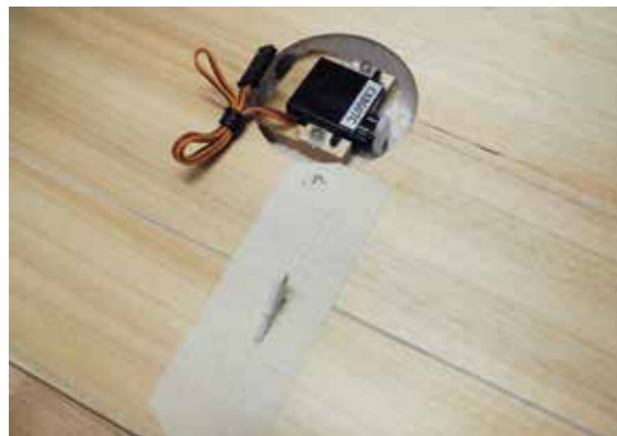
Servo DES 428 BB MG wird mit einem Holzrahmen im Flügel eingebaut.
