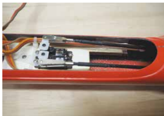
Hinter den V-Leitwerkservos wäre Platz für ein Ballastrohr im Seglerrumpf.
