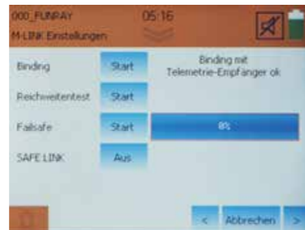
Einstellung Binden, Fail Save und SAFE-Link.
