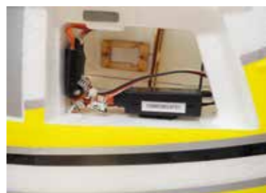
Die Klappe für den Empfänger in der Seitenwand beherbergt auch die LED-Elektronik.
