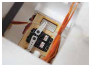
Unter der Kunststoffklappe befinden sich die beiden Servos für Höhe und Seite.
