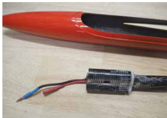
Durch die Anordnung des Empfängerakku in 3+1 Form kann ca. 10 g Blei eingespart werden.
