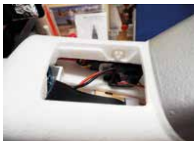
Die Akkuklappe erleichtert das Wechseln des 4s Lipoakku.
