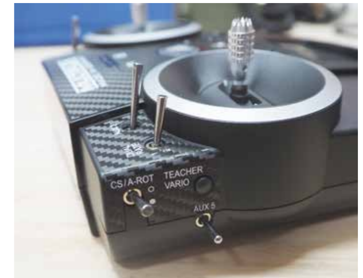
Je ein zusätzlicher Schalter auf jeder Seite bei der COCKPIT SX-12 gegenüber der SX-9.
