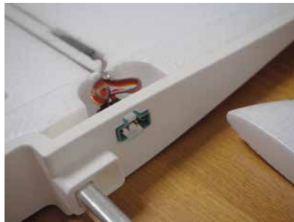
◀▶ Einfaches Aufrüsten des Modells mit automatischer Kontaktierung der Flächenservos an den Rumpf.
