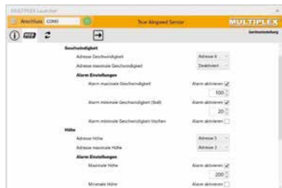
Sowohl die Sensoradressen als auch die Alarmwerte werden im Multiplex-Launcher bequem eingestellt.
