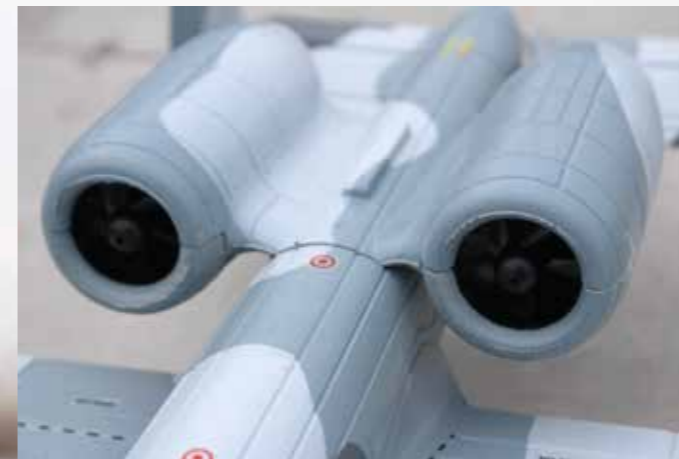
Für den notwendigen Vortrieb sorgen zwei 28-mm-Impeller, die von Brushlessmotoren mit 13.500 kV angetrieben werden.
