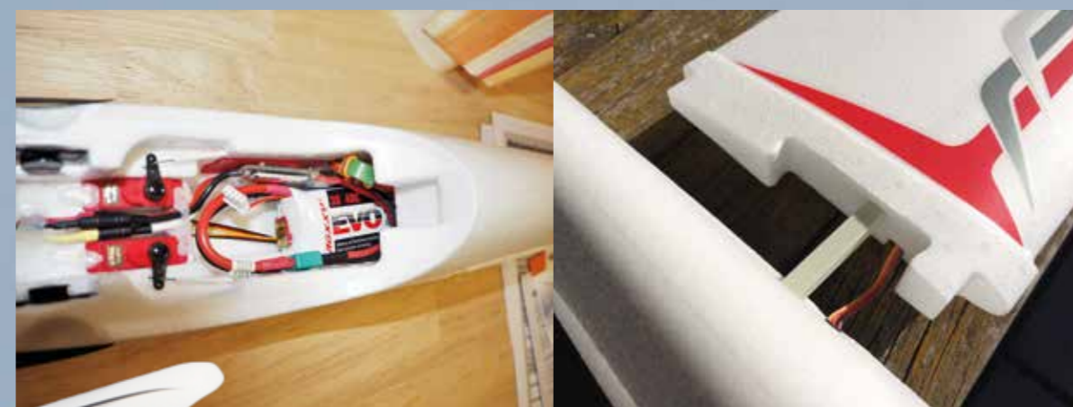
Der Lipo mit BID System passt perfekt in den Rumpf. Der neue Vierkant-GFK Stab verbindet die beiden Flügel.
