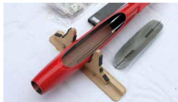
Die Bowdenzüge für Seiten- und Höhenleitwerk sind schon montiert, alle benötigten Kleinteile liegen bei.
