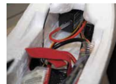
Einbau des Sensors unterhalb der Fläche neben dem Empfänger.
