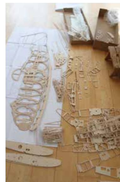
Der Baukasteninhalt – ein wilder Haufen von Frästeilen.
