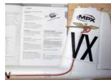
Befestigung des Prandtl-Rohr mit einem kurzen Stück Spritschlauch.
