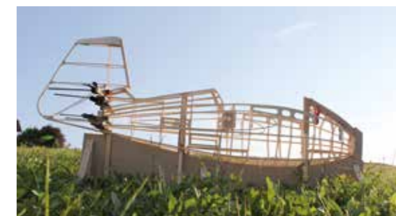
Grundgerüst des Rumpfes mit Seitenleitwerk.
