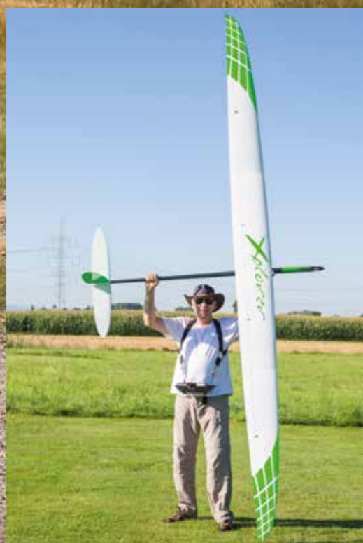
◀ Der Autor mit einem typischen High-End F5J-Modell: der Xplorer mit 3,8 m Spannweite und 1.590 g Abfluggewicht.
