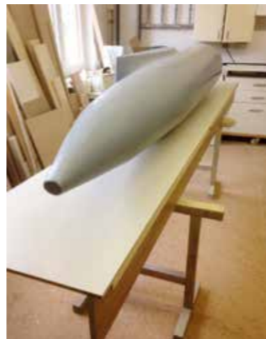
Der laminierte, grundierte und verschliffene Styroporrumpf vor dem Abformen.
