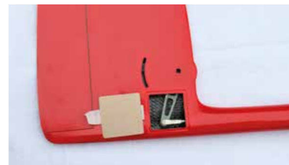
Das werkseitig vormontierte Pendelruder.
