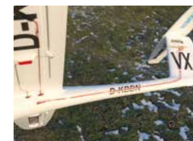
Verlegung der beiden Druckleitungen ohne Knick!
