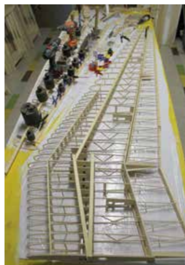
Bau der Flügelgrundgerüsts.
