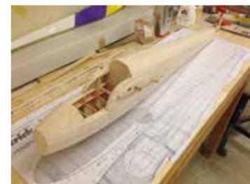
*Nach dem Zusammenfügen der beiden Rumpfhälften erfolgte das Überschleifen der Oberfläche sowie der Einbau der Servos für Höhen- und Seitenruder.*
