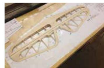
*Das fertig gestellte Höhenleitwerk nach dem Verschleifen.*
