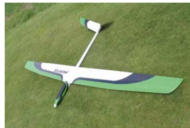
Der Mantis ist ein Elektrozwecksegler mit sechs fertig verbauten Dymond D 260 MG Servos und dem passenden Elektromotor.
