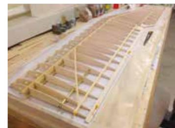
*Aufbau der rechten Tragflächenhälfte, dazu musste der Autor für den Knick eine spezielle Helling erstellen.*
