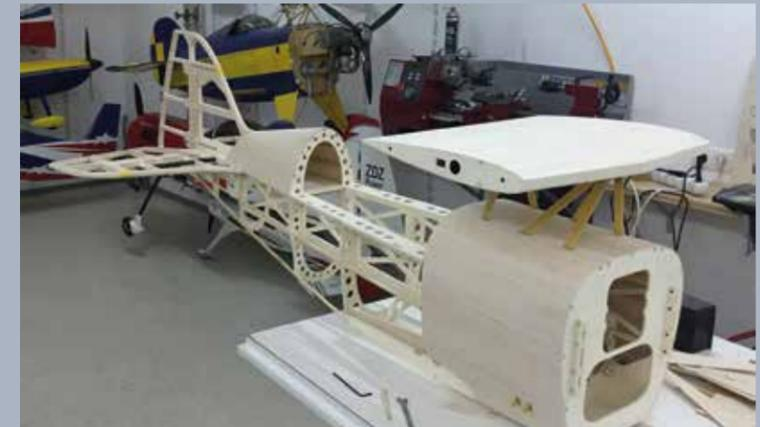
Der fertige Rumpf im Rohbau vor dem Zusammenfügen mit den Tragflächenhälften.
