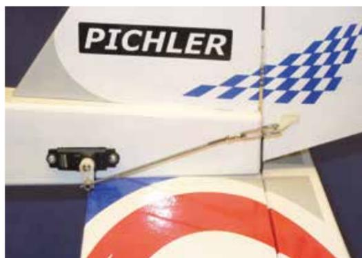
Die zur Anlenkung des Seiten- und Höhenruders benötigten Servos befinden sich im hinteren Bereich des Rumpfes in unmittelbarer Nähe des Leitwerks.
