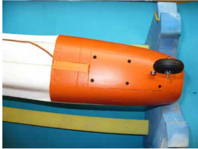
Das lenkbare Bugfahrwerk kann durch Entfernen der 6 Schrauben abgenommen werden, sodass die Fury dann auf dem Bauch landet.
