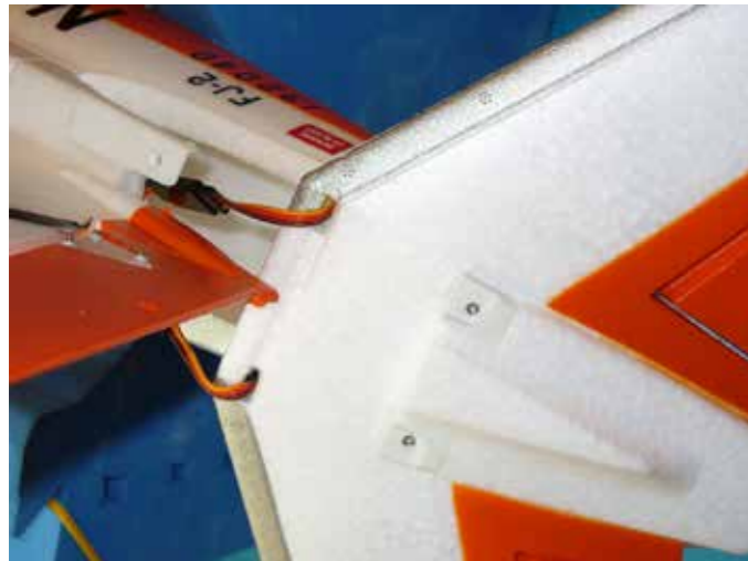
Die Kabel für die beiden Höhenruderservos sind bereits vorbereitet und müssen nur noch verbunden werden. Achtung! Die Stecker dürfen nicht in den Luftauslass reichen.
