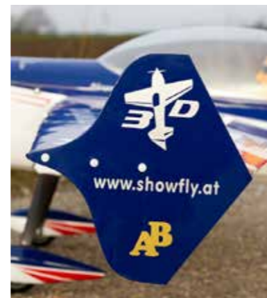
Die beigelegten SFG's (Side Force Generatoren), werden mit jeweils drei Rändelschrauben angeschraubt.
