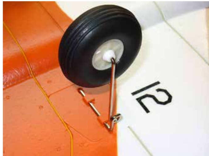
Das Hauptfahrwerk wird durch einfaches Einklipsen in die Tragfläche festgehalten.
