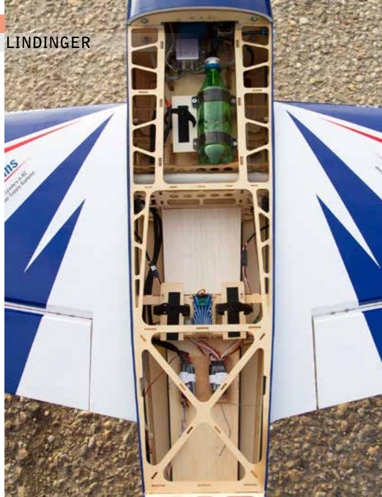
Blick in den Rumpf- zu sehen ist die 0,5-Liter-PET-Flasche mit Alu-verschluss als Tank
