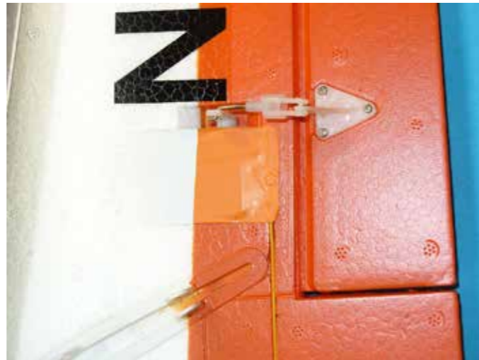
Die Servos für die Querruder und die dazugehörigen Anlenkungen sind bereits werkseitig eingebaut.
