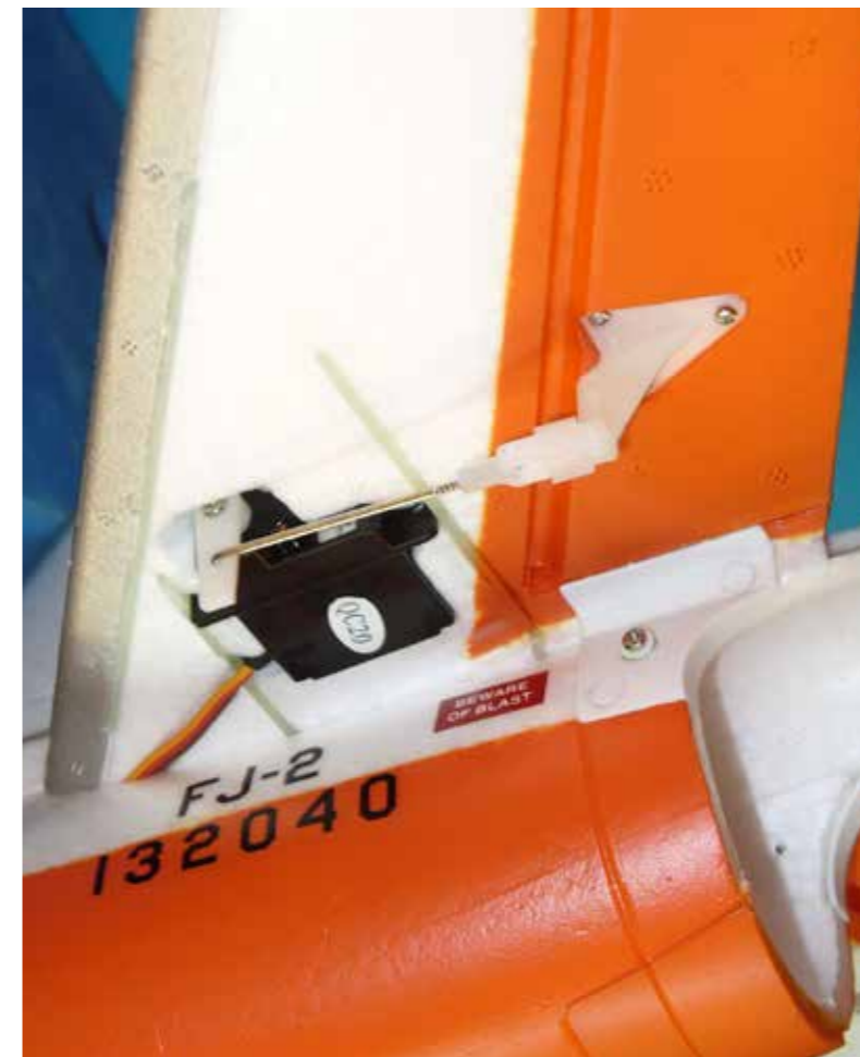
Ansicht des Höhenleitwerks-Servos und der unteren Befestigungsschraube
