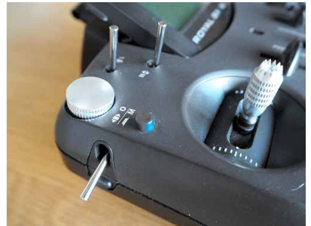
Über den Taster wird das Sprachmodul gesteuert
