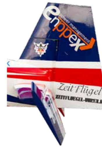
◀ Der Höhenruderausschlag ist gewaltig und ermöglicht das Fliegen von 3D-Figuren
