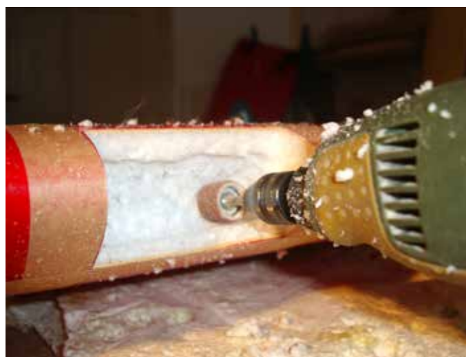
Damit genügend Raum für den Einbau der Elektronik vorhanden ist, musste hinter der Öffnung ausreichend Platz geschaffen werden.
