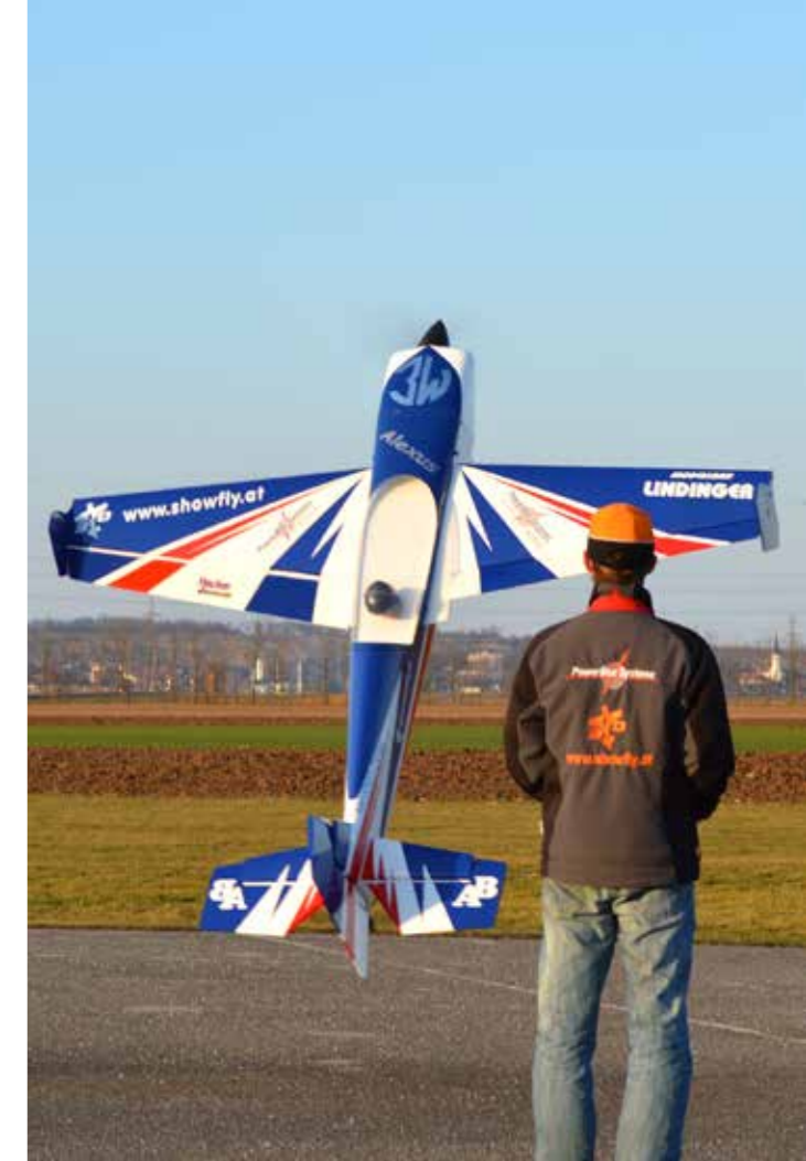
◀ Der Höhenruderausschlag ist gewaltig und ermöglicht das Fliegen von 3D-Figuren
