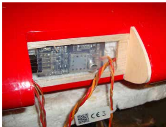
Zuerst musste die elektronische Steuerung eingesetzt werden, darüber kommt dann die Grundplatte für die Scheinwerfer.
