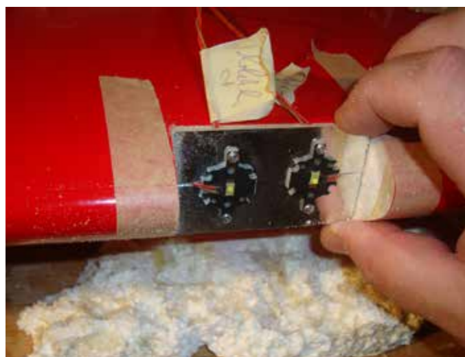
Montage der Grundplatte und der LED Leuchten
