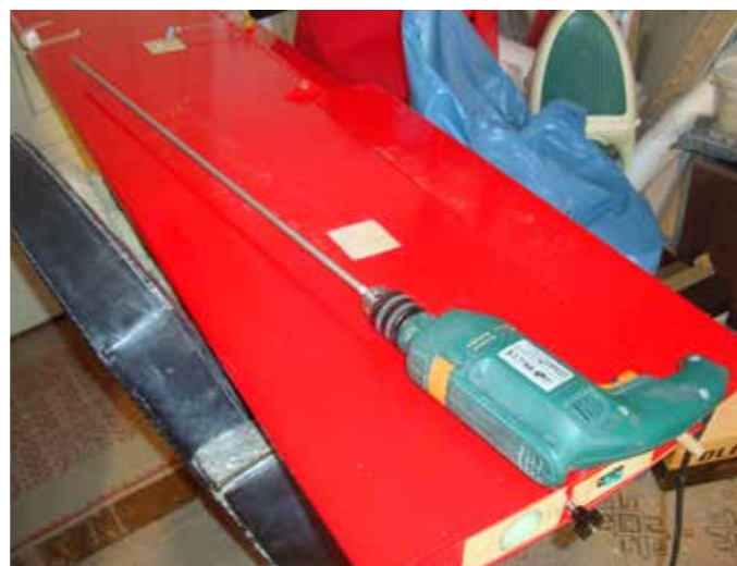
Mit Hilfe des Spezialbohrers wurde der Kabelkanal im Inneren der Tragfläche hergestellt
