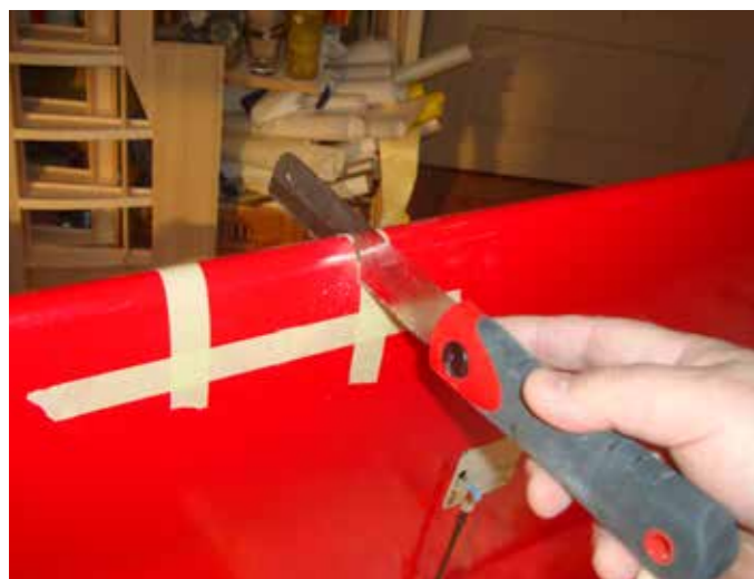
An der passenden Stelle auf der Tragfläche wurde die Öffnung für die Landescheinwerfer ausgeschnitten.
