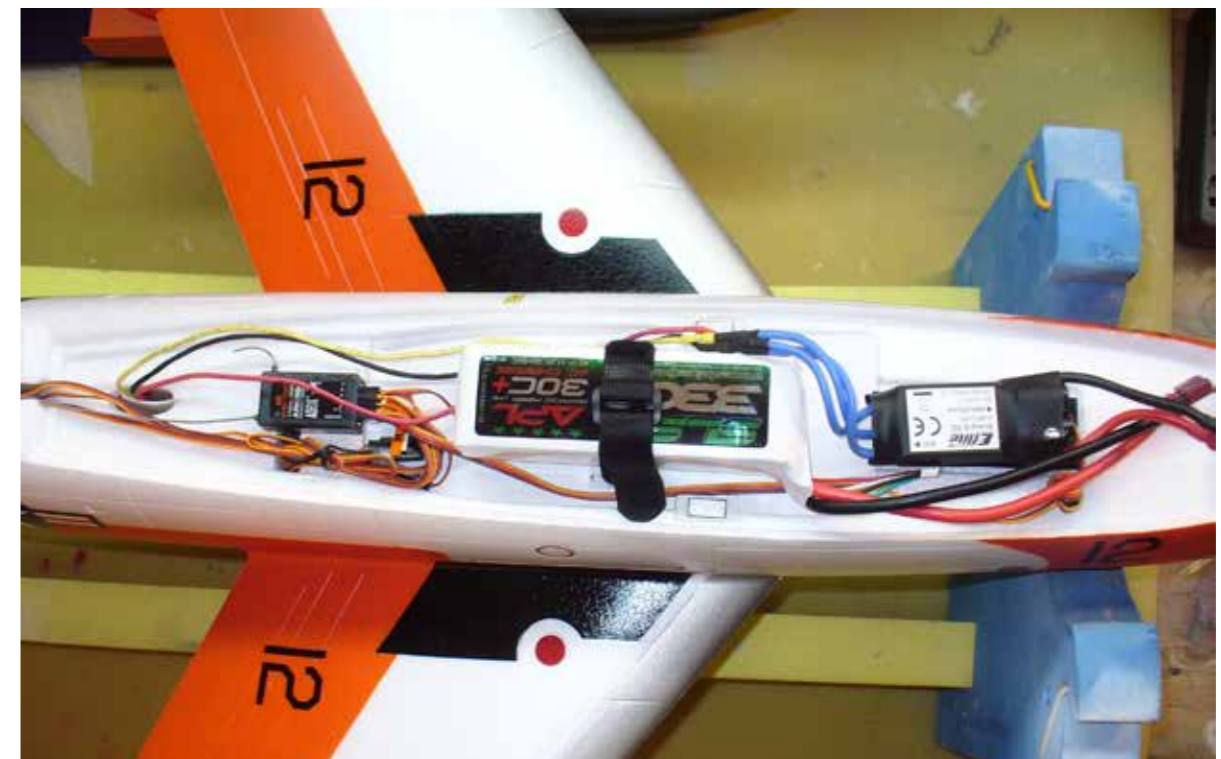
Empfänger, Regler und Flugakku befinden sich unter dem abnehmbaren Rumpfrücken
