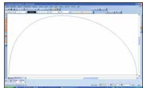
**Der Spant wurde mit einer Splineline nachgezeichnet. Dazu wurden die vektorisierten Linienzüge als Fangpunkt verwendet.**
