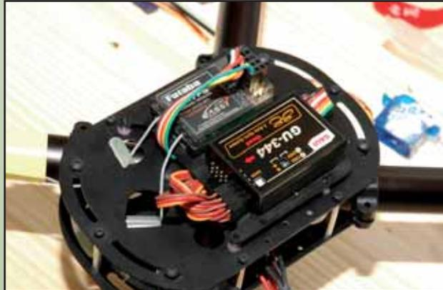
*Die neue Trägerplatte für die Elektronik*
