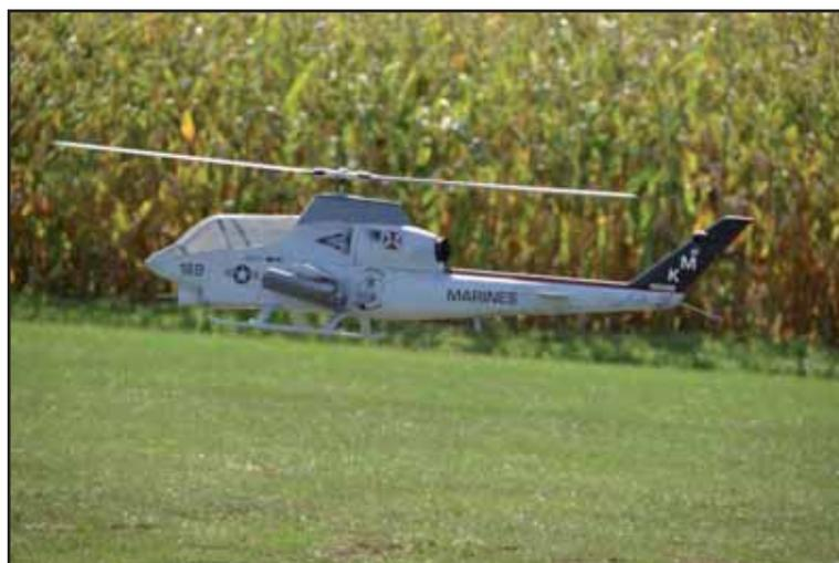
*Bell AH 1 Cobra von M. Peer, Akku 4,2 Ah, 12s, Gew. 9,5 kg, Rotordurchmesser 1,9 m*
