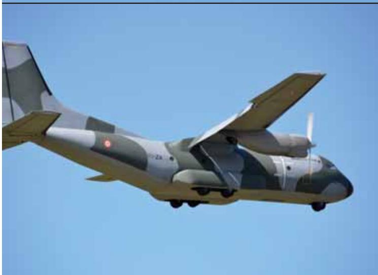
Transall C 160 von K. Seidl im Überflug, Masstab 1:10, Antrieb 2x Langratec PT 10, Akku 5,8Ah, 8s, 23, 7 kg, Spwt. 4 m
