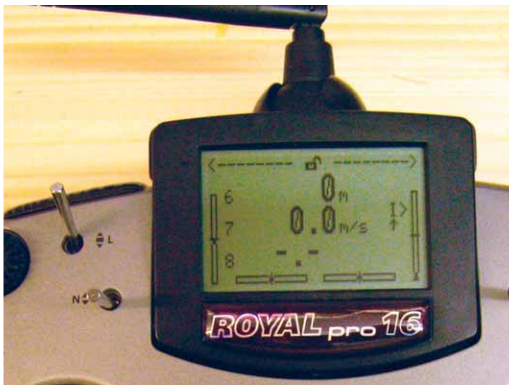
In Zeile 6 und 7 des Display werden die Werte für Höhe und die Vario-daten angezeigt Fotos M.Dittmayer
