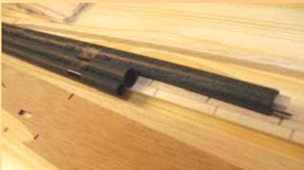
Die Kohlefaserholme unter 45° schräg handgewickelt und geschliffen, ein Hitec-Produkt
