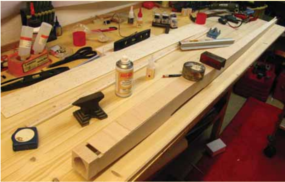
Rumpfröhbau nach Aufbringung der unteren Beplankung
