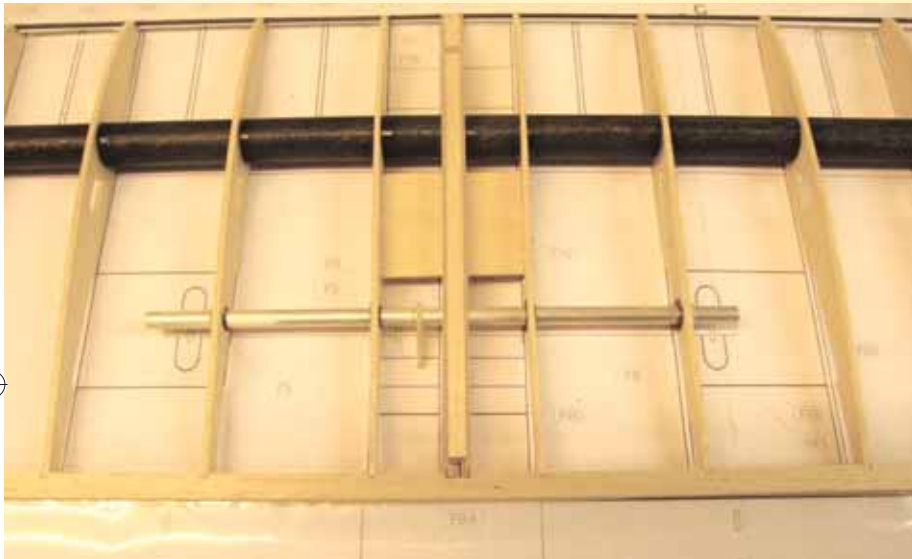
Anlenkung der inneren Klappen mit der Torsionsanlenkung und einem Servo. Deutlich sind die Kunststofflager und Anlenkungshebel erkennbar
