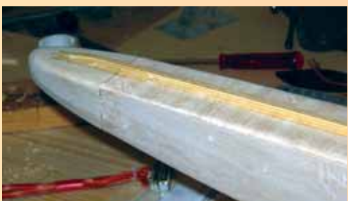
Eine zusätzliche Kufe aus einer Fichtenleiste 5x5 schützt den Rumpfvorderteil bei unanfechtbareren Landungen im Gebirge (Ergänzung des Autors)
