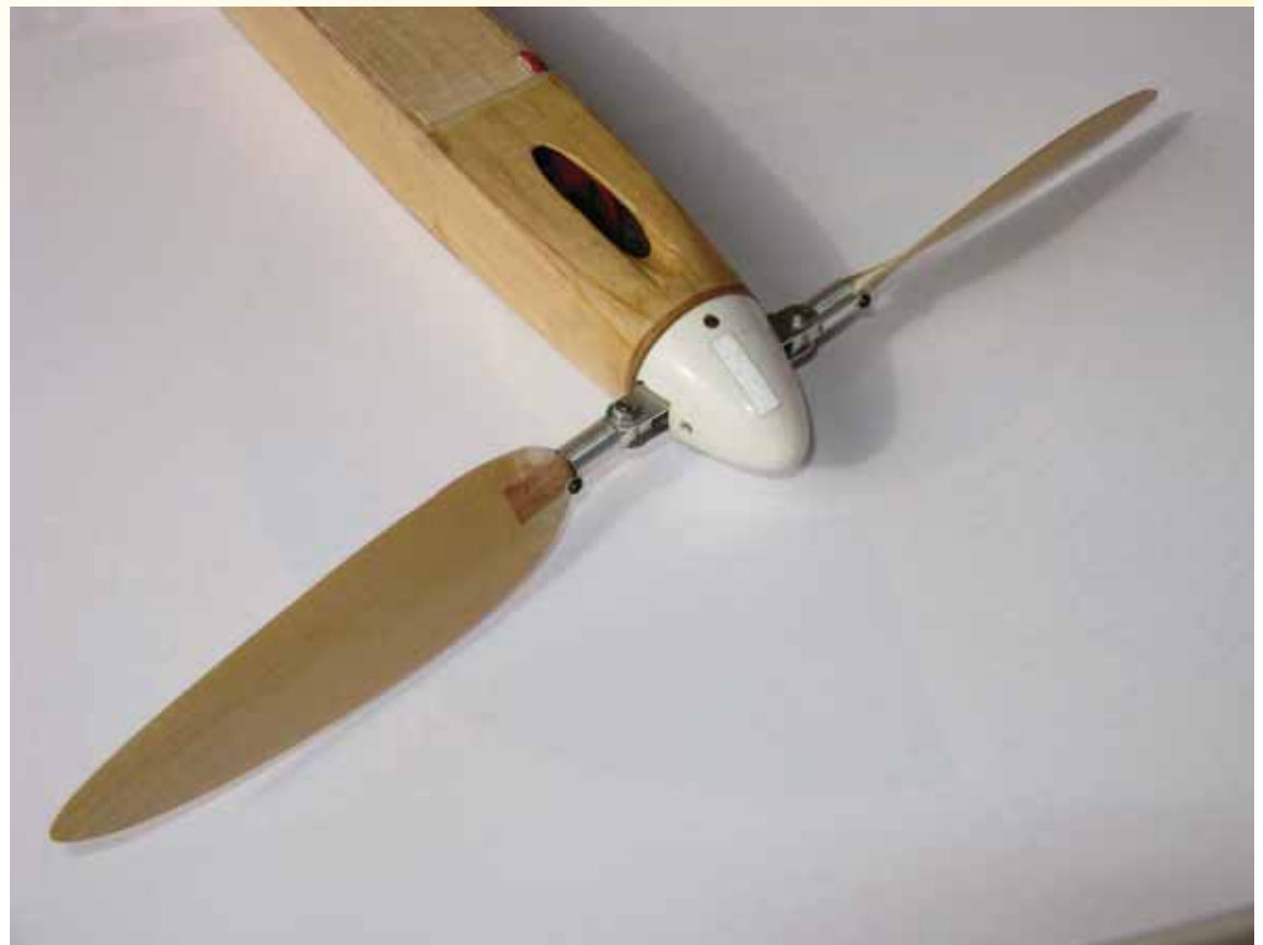
Propellermittelstück für leichten Blattwechsel- und Steigungs-Verstellmöglichkeit.
