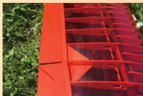
Kein Baufehler sondern die Freistellung der Querruder zu den Wölbklappen
