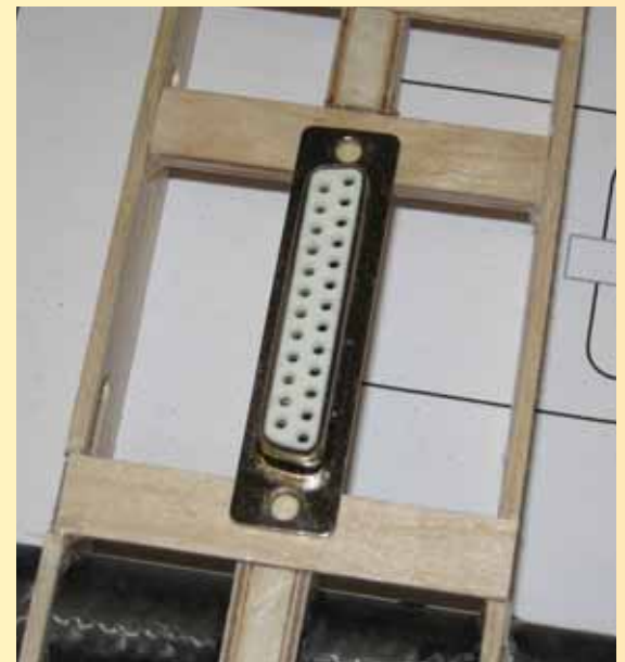
Ein mehrpoliger Flachstecker (bei Conrad erhältlich) erleichtert die sichere Verbindung der Flächen servos mit dem Empfänger
