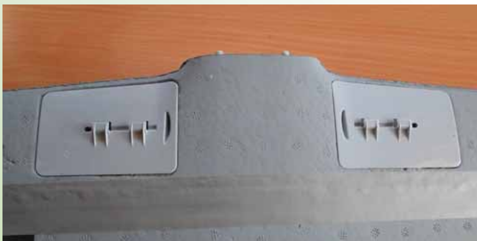
Die Fahrwerksaufnahme ermöglicht leichtes Umrüsten für Flüge mit und ohne Fahrwerk. Die Fahrwerke werden einfach nur „eingeklickt“
