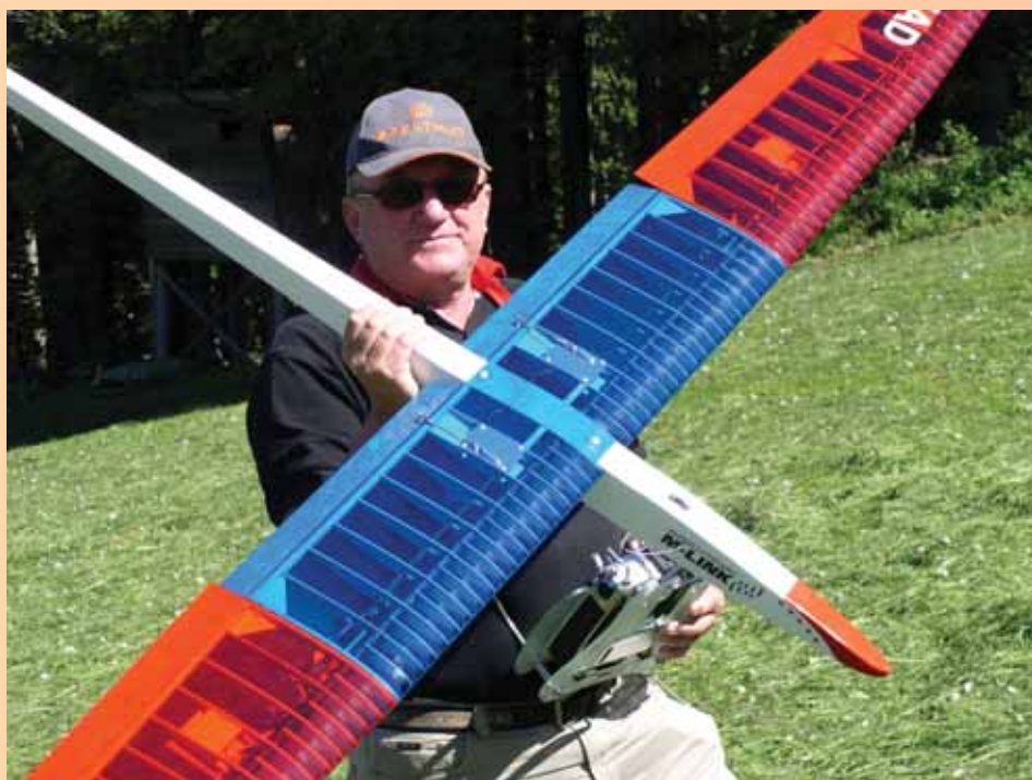
Der Flügel mit sechs Servos und von oben angelenkten inneren Klappen
