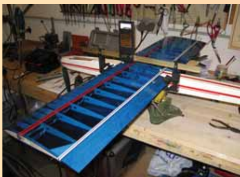
Die EWD wurde überprüft und passte exakt
