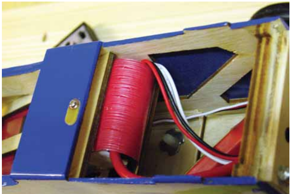
Das Akkufach ermöglicht den leichten Austausch des Flugakkus ohne die Tragflächen abnehmen zu müssen
