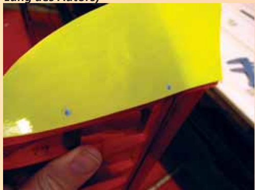
Die „Wingtips“ wurden zusätzlich mit der Endrippe verstiftet
