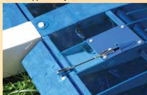
Anlenkung der inneren Klappen von oben
