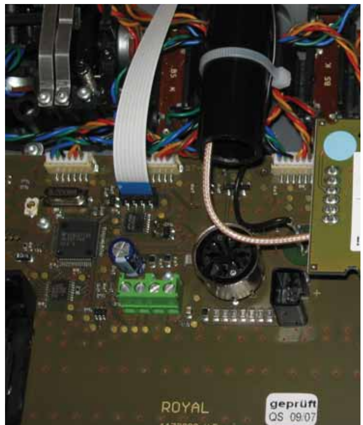
Neue Antenne von hinten einschieben, neue HF Platine einstecken
